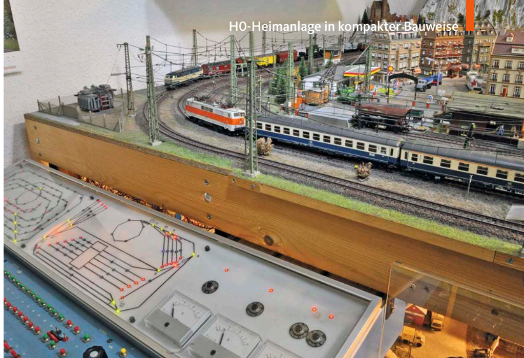
Über ein selbstgebautes Stellpult wird der Zugbetrieb in den zwei oberen Ebenen gesteuert
