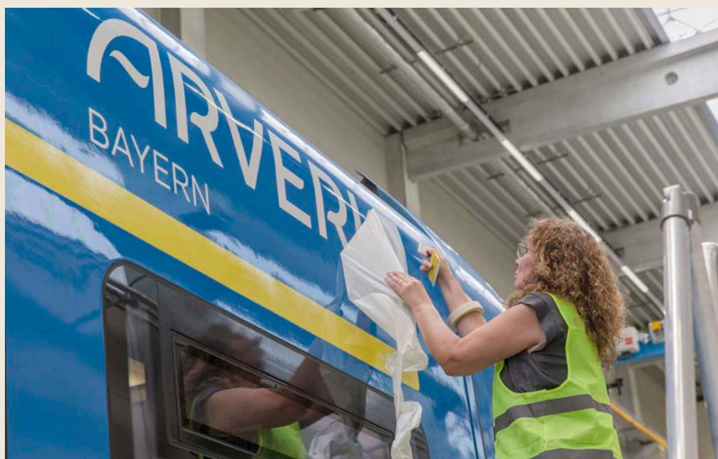
Wenn die Folie faltenfrei sitzt, kann die Applikationsfolie aus Papier abgezogen werden. Der Blick ist nun freigegeben auf das neue Logo
