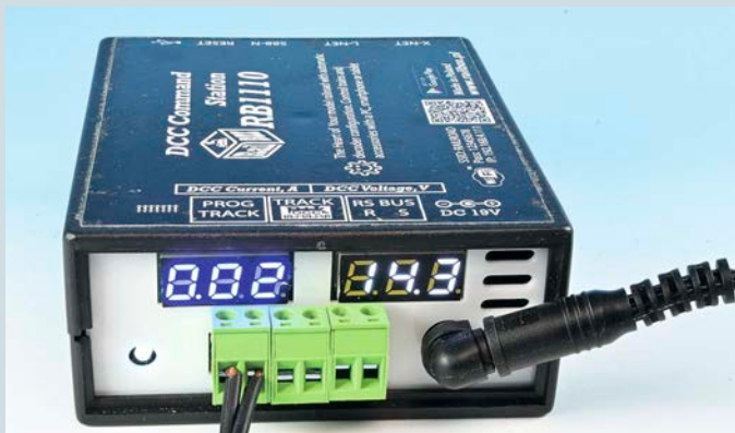
Die DCC-Digitalzentrale bietet RailCom, Programmiergleisfunktion und integriertes WLAN. Über den Gleiszustand geben Segmentanzeigen und eine Leuchtdiode Auskunft
