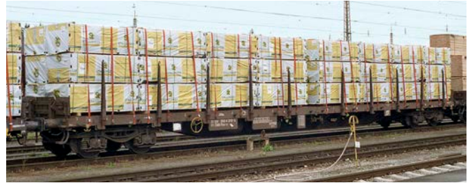
Hier sind 48 Pakete Schnittholz der Firma Stallinger auf einem Rs-Wagen der Österreichischen Bundesbahnen verladen, aufgenommen im August 2004 in Freilassing
