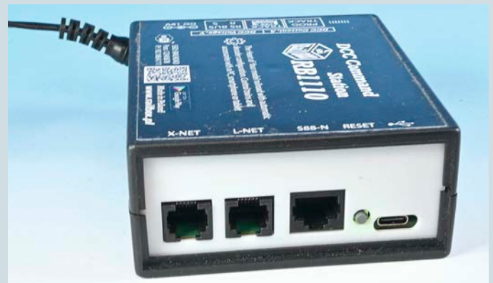
Die Geräterückseite der RB1100 von RailBox mit X-Bus, LocoNet, s88-N und USB-C-Anschluss – damit ist die Zentrale gut für alle möglichen Modellbahn-Einsatzzwecke gerüstet
