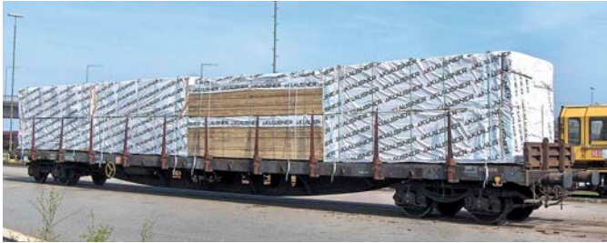
Bei diesen 16 gestapelten Paketen mit Schnittholz in Verpackungen des Verarbeiters Klausner auf einem Bundesbahn-Rs stechen die unverhüllten Blöcke in der Mitte hervor
