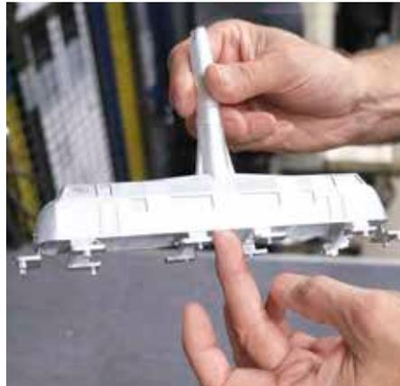
Ein Rohling, noch warm und frisch aus der Maschine: Überschüssiges Material wird entfernt und wieder eingeschmolzen
