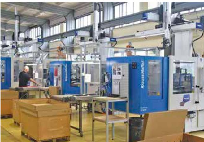
**An 17 Maschinen mit Schließkräften von 15 bis 500 Tonnen werden rund zwei Millionen Kunststoffteile im Jahr gespritzt**
