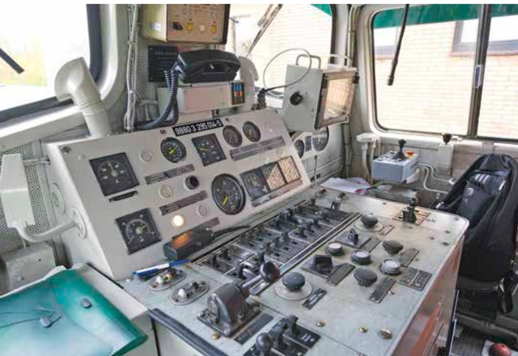
**Führerstand mit dem auf Funkfernsteuerung umgebauten Steuerpult der 295 014. Am Fenster ist der Fahrshalterhebel als Joystick zu sehen, der das bisherige Schaltrrad ersetzt**
