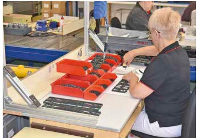
**In der Wagenfertigung werden eigene Kunststoff- sowie Zukaufteile wie z. B. Gewichte mittels Hilfsvorrichtungen montiert**
