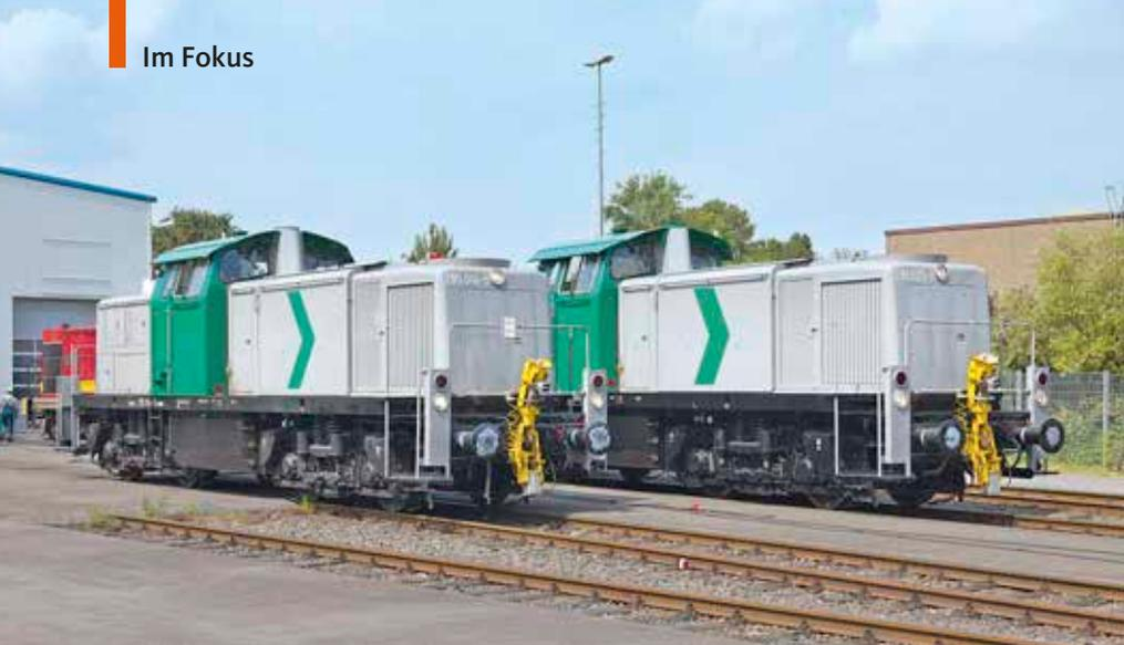
**Noch lange kein altes Eisen: 2012 übernahm B&V Leipzig gleich 20 Loks der Baureihe 295 und arbeitete die Loks auf. 295 014 und 295 025 gingen an die EAH Eisenbahn-Anlagen-Handel in Duisburg-Duisern und wurden einige Jahre bei Duisport eingesetzt**
