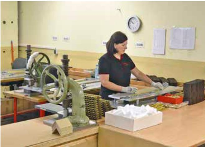
**Alle Gartenbahn-Gleise sowie -Weichen werden in Sonneberg mittels spezieller Vorrichtungen von Hand zusammgebaut**
