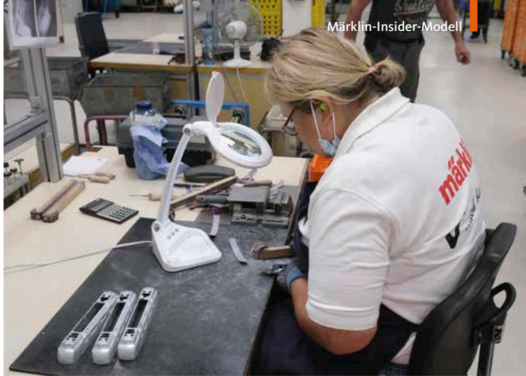
Diese Märklin-Mitarbeiterin beseitigt manuell die Formtrennkanten am Rohling, bevor die Gehäuse zum automatischen Bürsten weitergereicht werden AL
