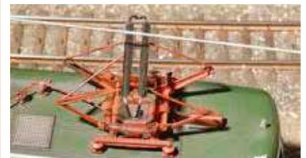
**Mit den beiden Laschen an der Befestigungsplatte lässt sich die Höhe des Pantografen einfach justieren (oben). Bei anderen Dachstromabnehmern kann**
