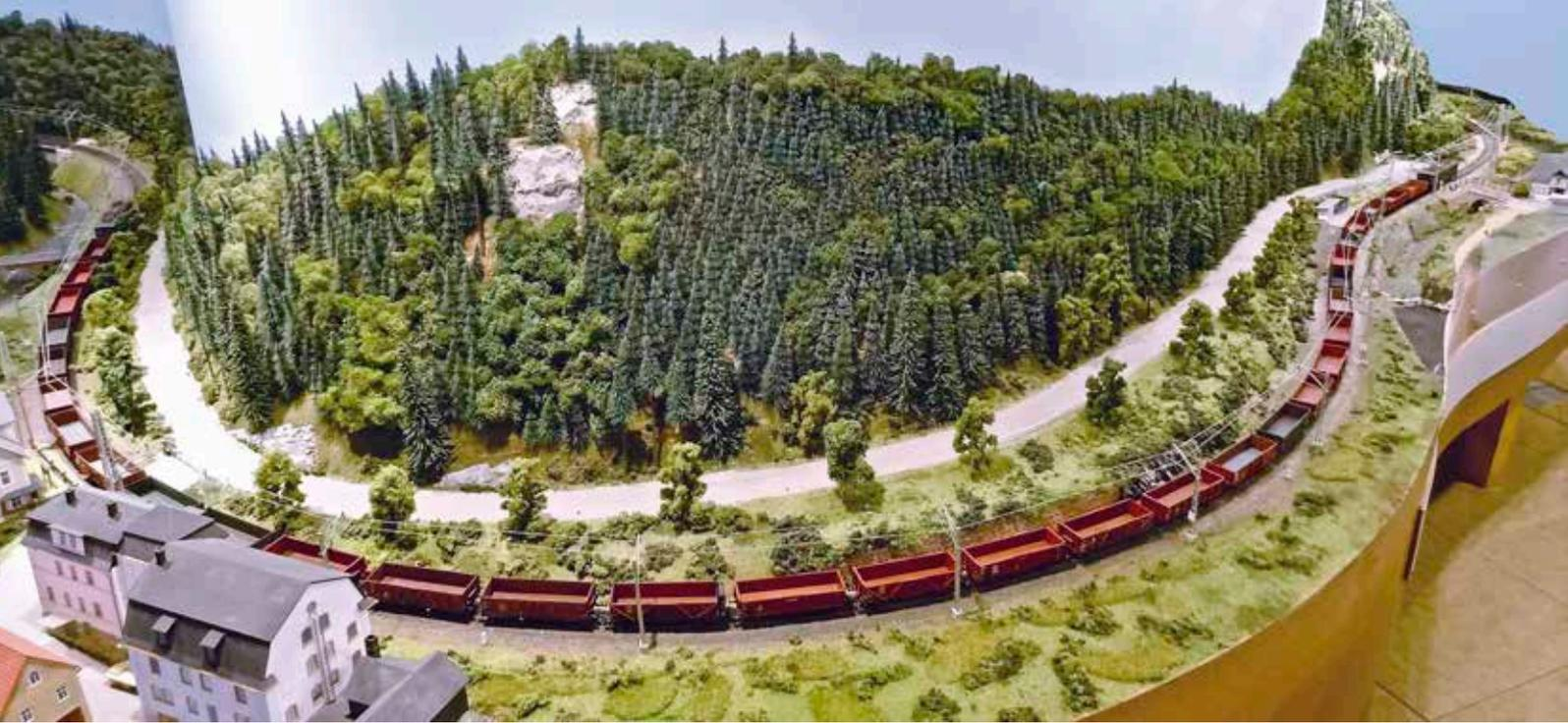
**Durch die Last des Zuges behalten die Kupplungskulissen ihre Lage in der Gegenkurve aus dem vorhergehenden Bogen bei, trotz dazwischenliegender Geraden. Die Kraft der Rückstellfeder reicht nicht aus, um eine neutrale Lage zu erreichen, sodass Entgleisungen drohen**
