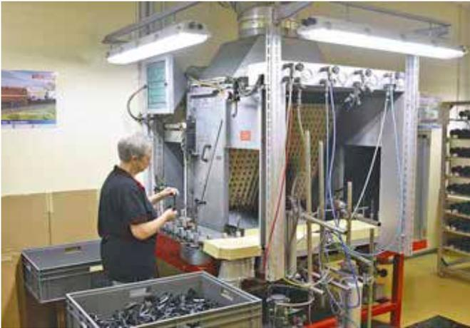
**Rund drei Millionen Einzelteile werden in fünf Farbspritzkabinen und in zwei Lackieranlagen pro Jahr eingefärbt**
