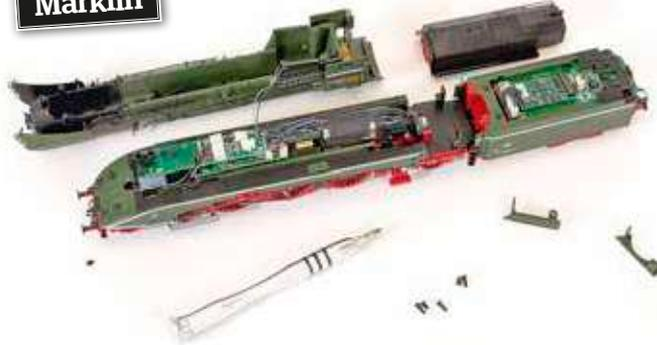
**Die Märklin-Schnellfahrlokomotive in zerlegtem Zustand zeigt den Antrieb im Bereich des Kessels, während die Einbauräume davor und im Kessel mit allerhand Elektronikplatinen belegt sind**
