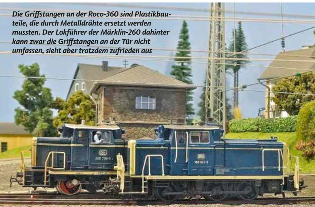
**Die Griffstangen an der Roco-360 sind Plastikbauteile, die durch Metalldrähte ersetzt werden mussten. Der Lokführer der Märklin-260 dahinter kann zwar die Griffstangen an der Tür nicht umfassen, sieht aber trotzdem zufrieden aus**
