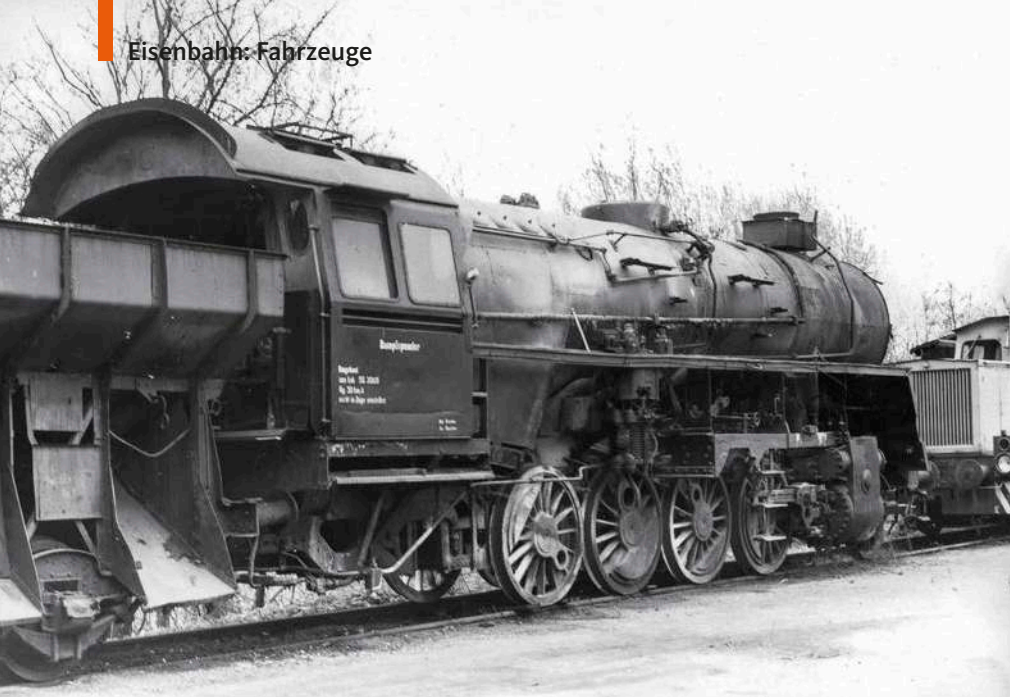
Keine Bremse, die Stangen, Kuppelzapfen, Sandkästen und Sandrohre und die Vorwärmanlage sind abgebaut. So präsentierte sich 58 3049 am 14. April 1992 als Heizlok im Bw Glauchau
