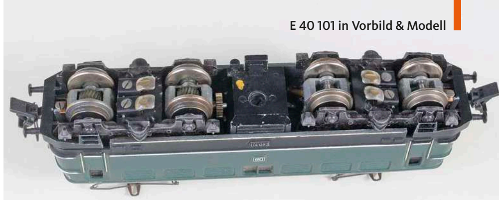
Beim Blick von unten sind gut die vier Stromabnehmer der Express-Version zu sehen. Der Lokaufbau ist mit nur einer Schraube am Unterboden fixiert. Im Inneren der E 40 101 verbaut ist der 1954 eingeführte und zwei Radsätze antreibende Perma-Standardmotor
