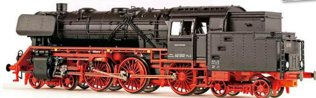
Lokführer- und Heizerseite der Liliput-HO-Tenderlokkonstruktion mit den sichtbaren Rahmenausparungen, aber auch den großen Abständen zwischen den Vor- und Nachlaufträgern und dem Rahmen darüber. Die Detaillierung des Aufbaus indes lässt kaum Kritik zu
