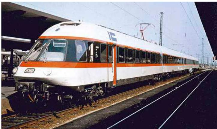
waren sie zudem goldbedampft. Die moderne Technik sollte neben automatischen Fahr- und Bremssteuerungssystemen sowie luftgefederten Drehgestellen vor allem die gleisbogenabhängige Wagenkastensteuerung (GSt) verkörpern. Hierfür wurden die Seitenwände von unten nach oben deutlich sichtbar um zwei Grad eingezogen, um innerhalb des Lichtraumprofils zu bleiben.
