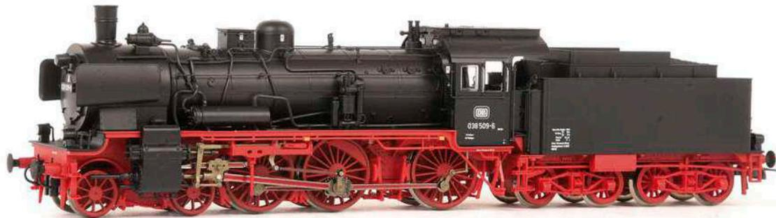
**Roco HO: DB-Lokomotive 38 509 mit Witte-Windleitblechen und Tenderantrieb** MM (8)
