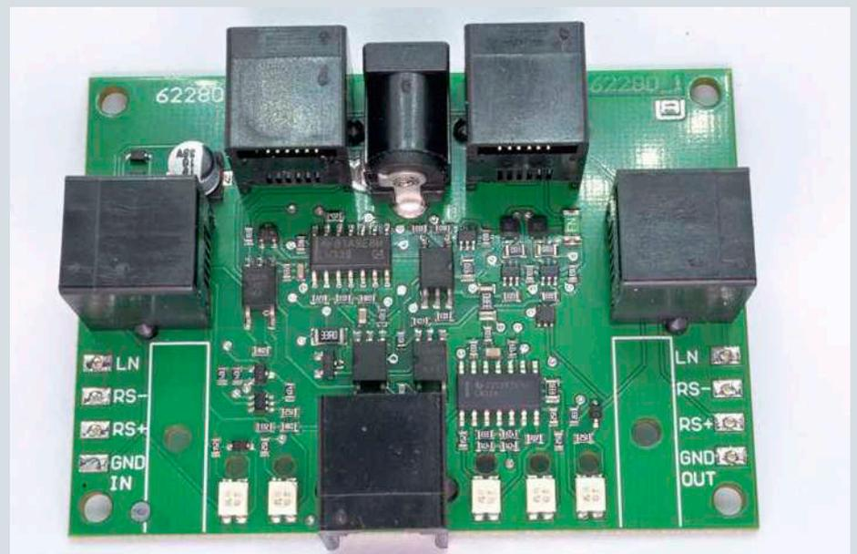
*Die LocoNet-Buchse auf der linken Seite ist der Eingang bei dieser Platine. Liegt dort ein LocoNet-B an, wird auf der rechten Seite ein LocoNet-B ausgegeben. Die Buchse vorn und die beiden hinteren stellen ein LocoNet-T im galvanisch getrennten LocoNet bereit. Alle drei Buchsen lassen sich zusammen mit bis zu 500 Milliampere belasten*
