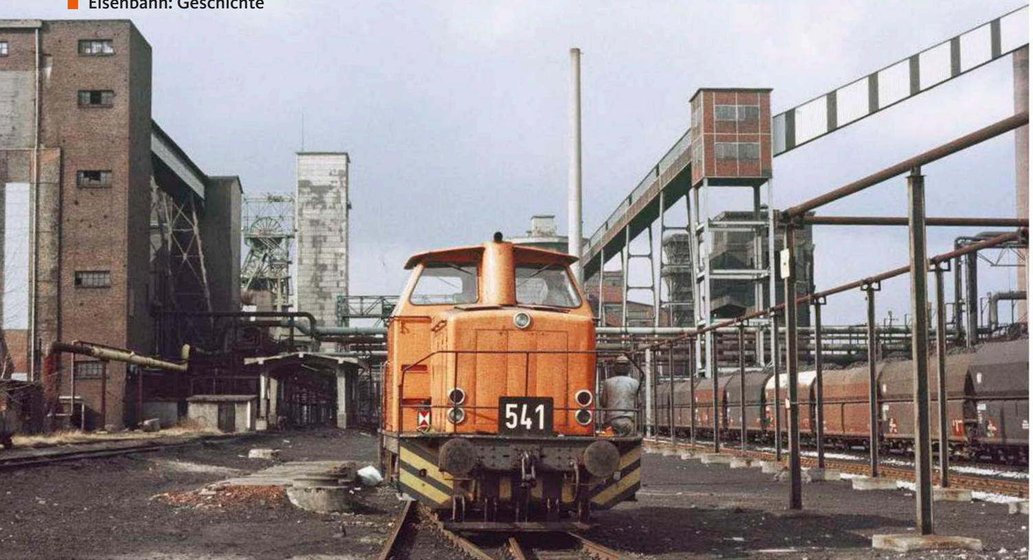
**Eine Besonderheit des Bergwerks waren die LHB-Diesellokomotiven. Lok 541 rangiert am 23. März 1985 im Ostteil der Zeche. Links zu sehen der Betonförderturm über dem Hauptförderschacht, rechts die Bandbrücken zu der im Vorjahr stillgelegten Kokerei**
