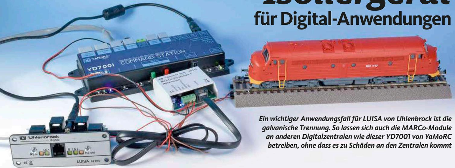
*Ein wichtiger Anwendungsfall für LUISA von Uhlenbrock ist die galvanische Trennung. So lassen sich auch die MARCO-Module an anderen Digitalzentralen wie dieser YD7001 von YaMoRC betreiben, ohne dass es zu Schäden an den Zentralen kommt*
