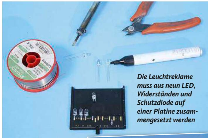
Die Leuchtreklame muss aus neun LED, Widerständen und Schutzdiode auf einer Platine zusammengesetzt werden
