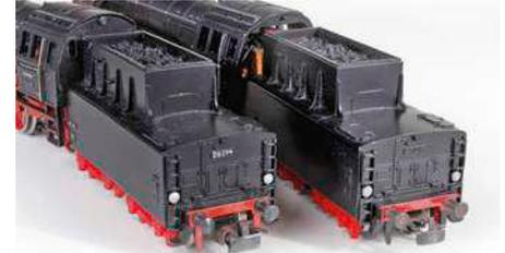
Im Vergleich zum ursprünglichen Märklin-Modell fallen die diversen Vereinfachungen an der PRIMEX-Lokomotive sofort ins Auge: Das hinten geschlossene Führerhaus war ein typisches Erkennungsmerkmal der 23er; bei Märklins Sparversion 3097 fehlte die Rückwand ebenso wie beim späteren PRIMEX-Modell. Die Kupplungen am Tender durchliefen schon bei Märklin eine Evolution, das PRIMEX-Modell trägt hier lediglich eine einfache Hakenkupplung, und auch die silbern hervorgehobene Betriebsnummer fehlt
