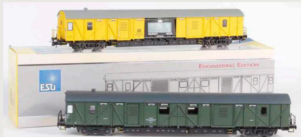
*ESU hat seinen Einheitshilfsgerätewagen EHG 388 nicht nur als grünes DB-Modell aufgelegt, sondern auch in einer technisch aufwendigen Version als Messwagen zur Ermittlung von Lok- bzw. Zugfahrwerten auf der H0-Anlage*
