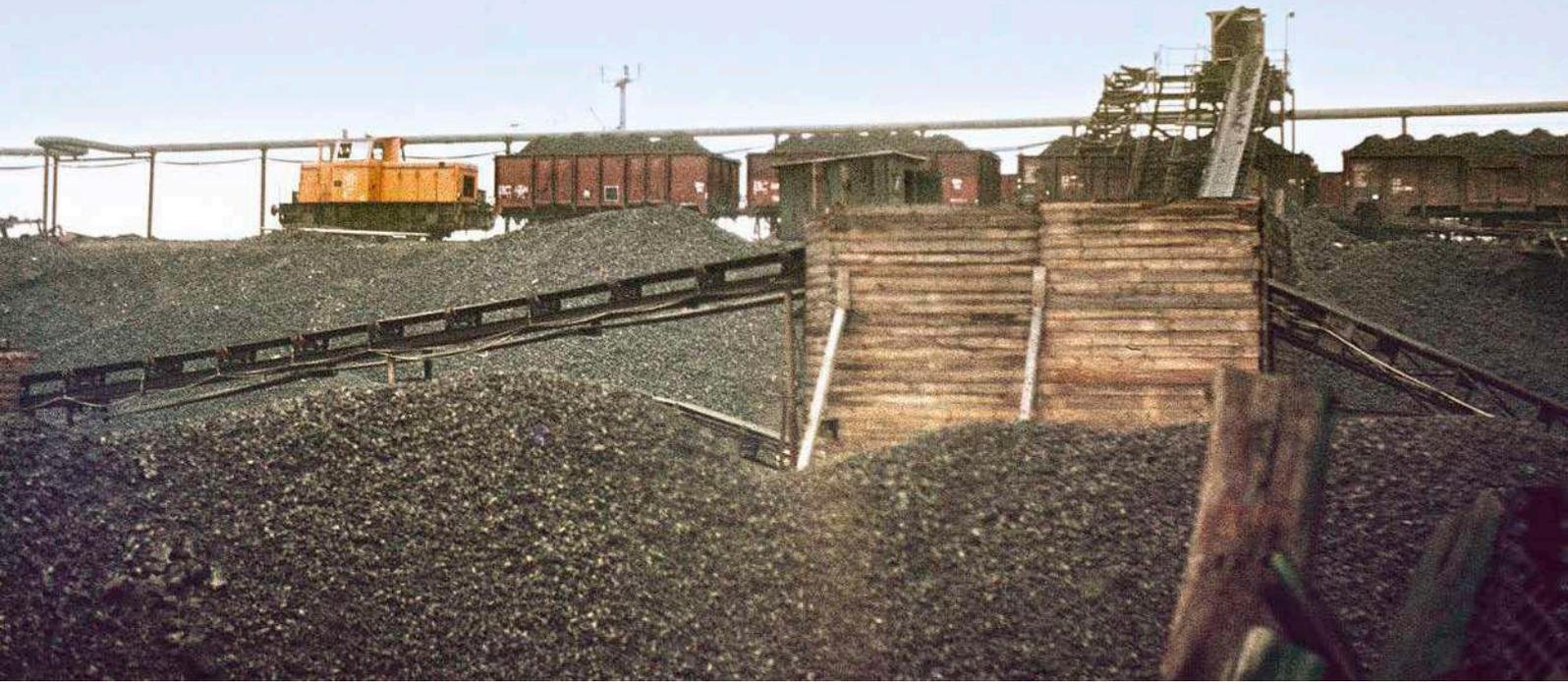
*Koks, soweit das Auge reicht: Am diesigen 2. Januar 1975 wird grober Koks in E-Wagen umgeschlagen. Für den Verschub zuständig ist die RAG-Diesellok V 413*
