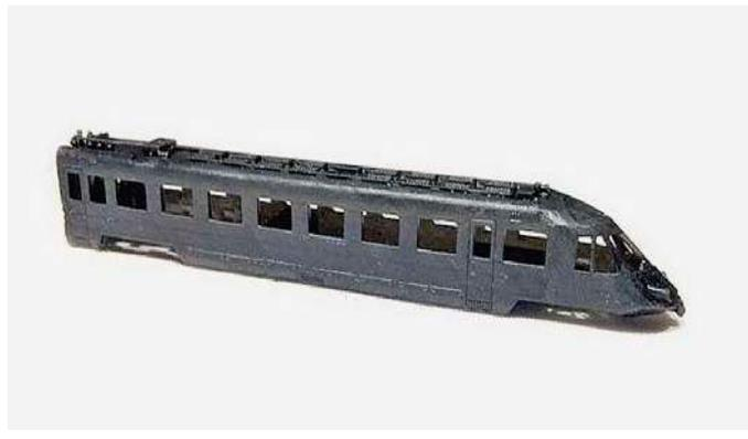
Dieses Z-Gehäuse-Modell ist ein 3D-Druckteil von NoBa und passt auf speziell entwickelte Fahrwerke Werk (2)
