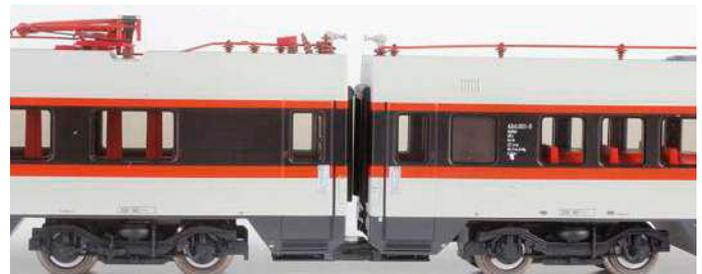
**Speziell bei dieser Detailansicht der HO-Wagenmodell-Übergänge bzw. -Kupplungen von Lima (links) und Trix (rechts) erkennt man die Konstruktionsunterschiede beziehungsweise den Fortschritt im Modellbau**
