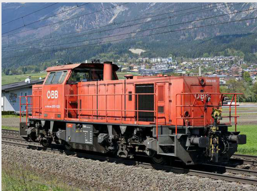
Die 2070 028 der Österreichischen Bundesbahnen ist hier als Lokzug 88425 von Innsbruck nach Hall in Tirol bei Rum unterwegs. Hinter dieser Diesellok verbirgt sich die Vossloh-Bauart G 800 BB, die im Gegensatz zur G 1000 BB einen schmaleren Motorvorbau aufweist
