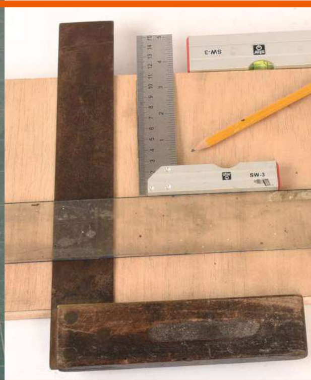
Hochwertige Anschlagwinkel sind aus einem Stück gefertigt (links). Preiswerter, aber nach längerer Einsatzzeit eventuell auch ungenauer sind Winkel, die aus mehreren Einzelteilen bestehen (rechts)
