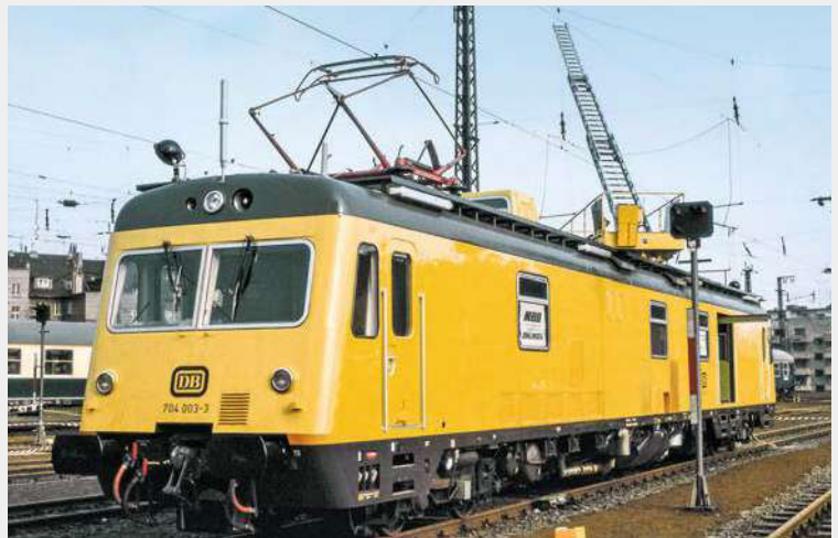
Mit dem Prüfstromabnehmer vom Typ DBS 54 kann die Lage des Fahrdrachts erfasst werden (Anpressdruck zwischen 70 und 250 Newton). Die Leiter ermöglicht Arbeiten an hohen Bauteilen
