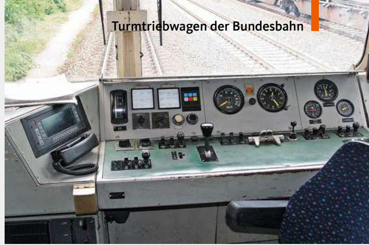
Der Führerraum entspricht dem der Baureihe 627, ist aber um Bedienelemente für die Sondereinrichtungen ergänzt
