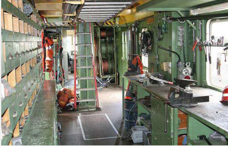
In der Werkstatt ist Platz für Ausrüstung, Ersatzteile und Werkbank. Hinter der Leiter ist der Zylinder für die Hubbühne angeordnet
