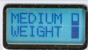
Für jede Lok lässt sich eine Massesimulation in Stufen einstellen, wodurch sich das Beschleunigungs- und Bremsverhalten verändert
