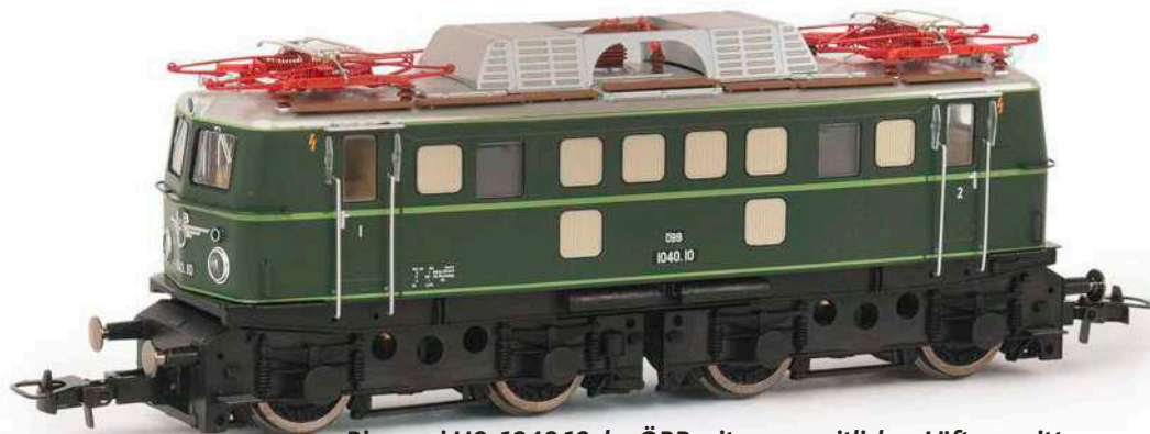
Rivarossi HO: 1040.10 der ÖBB mit neuen seitlichen Lüftungsgittern, Bremswiderständen auf dem Dach sowie grüner Lackierung und Beschriftung der Epoche IV
