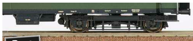
Roco: Version mit SKF-Achslagern
