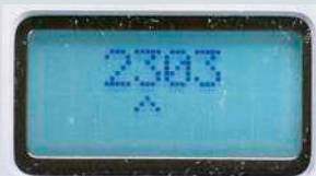
Die Adresseingabe der Triebfahrzeuge erfolgt ziffernweise. Bei Verwendung kurzer Adressen steht vor der Adresse ein „s“ für short
