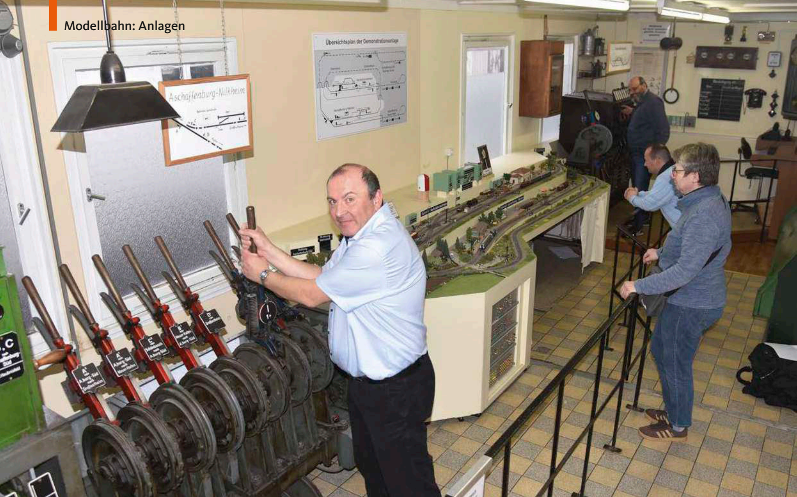
Bahnbetrieb im Lehrstellwerk: Andreas Mampel (vorn) stellt am Hebelstellwerk von Aschaffenburg-Nilkheim die Weiche für den in den Bahnhof eingefahrenen Wendezug (Bildmitte); diese Station befindet sich auf der mittleren von drei Ebenen. Ganz oben liegt der Bahnhof Neckarbischofsheim, den Matthias Mampel mithilfe eines Kurbelstellwerks bedient (hinten). Von dort ist die 212 mit dem geschobenen Silberling-Steuerwagen auch durch eine Tunnelstrecke nach Nilkheim gekommen
