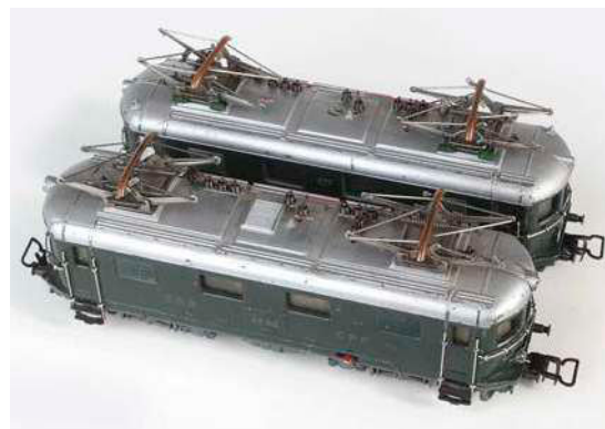
Dort, wo bei der RE 800 (vorn) mittig noch die Andeutung eines Erregerwiderstands für die elektrische Bremse saß, befand sich bei der RES 800 und der RET 800 eine Schraube für die Gehäusebefestigung. Dafür hatte die RE 800 noch keinen roten Warnpfeil
