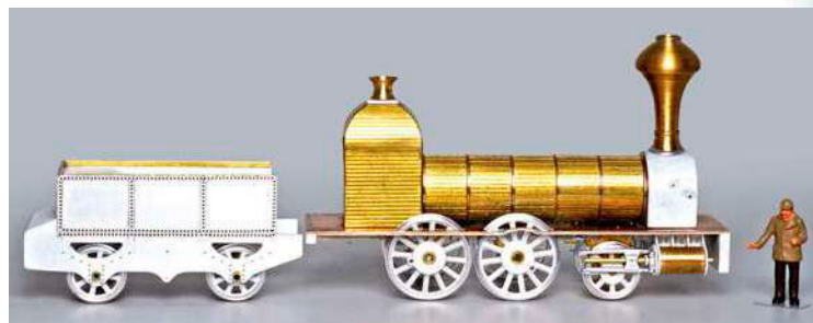
Die Lok der Gattung B I wurde komplett selbstgebaut und besteht weitgehend aus gefrästen Kunststoff-, Alu- und Messingteilen
