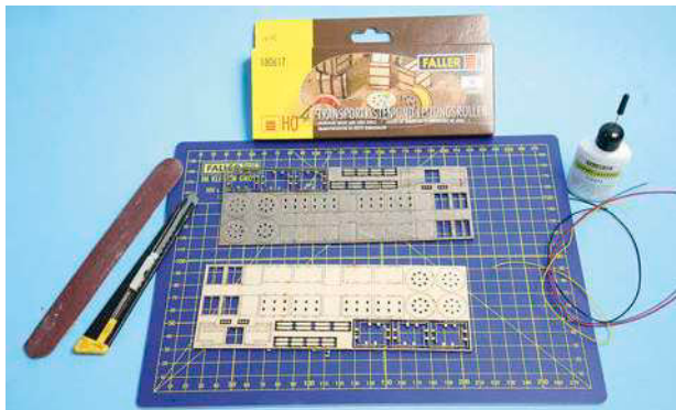
Die Teile des Faller-Bausatzes „Transportkisten und Leitungsrollen“ für Ladeszenen auf HO-Anlagen; nach dem Heraustrennen und Versäubern der Teile wurden diese mit speziellem Laser-cut-Klebstoff zusammengeleimt
