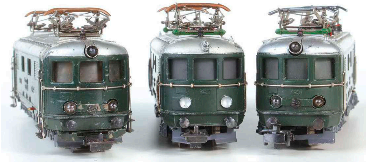
Vergleich der Fronten: Ellokkmodell RE 800 mit beidseitig drei Stirnlampen und Schweizer Lichtwechsel (links), die Rückseite der RES 800 mit auf dieser Seite lediglich angedeuteten Lampen, aber schon der Betriebsnummer 427 an der Front (Mitte) und die Artikelnummer RET 800 mit wieder beidseitig drei Stirnlampen, aber nur noch einfachem Lichtwechsel
