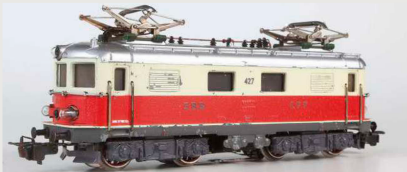
Vom Nürnberger Modellbahnfachhändler Schweiger gab es in den 1970er-Jahren eine Kleinserien-Re 4/4' in TEE-Farbgebung. Als Basis diente der Märklin-Teilesatz 3914, dessen Aufbau lediglich rot/beige lackiert wurde, aber die nun falsche Betriebsnummer 427 behielt
