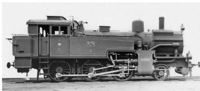
Die T 12 „2175 Berlin“ besitzt den anfänglich verwendeten Rauchkammerüberhitzer, der die Kopflastigkeit der Maschine betonte. Auf der Rauchkammer liegt der flache Vorwärmer der Anfangszeit
