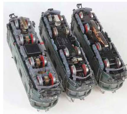
Links die RE 800 mit vier angetriebenen Radsätzen, in der Mitte die vereinfachte RES 800 und rechts die RET 800/3014 mit großem Skischleifer in der Mitte
