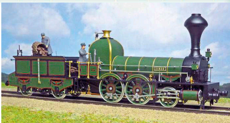
Die Lok der Gattung B I wurde komplett selbstgebaut und besteht weitgehend aus gefrästen Kunststoff-, Alu- und Messingteilen
