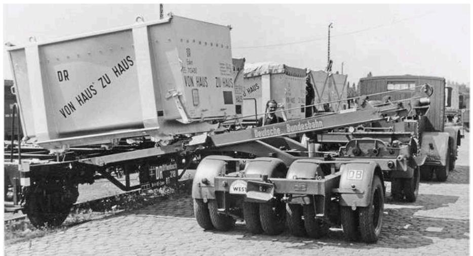
**Ein historischer Vorläufer des MOBILER ist das als „Von-Haus-zu-Haus“-System, mit dem die Bundesbahn den Pa-Behälterverkehr bewarb. Auch hier konnte mittels eines einfachen Prinzips der Wechsel von der Straße auf die Schiene erfolgen. Im Bild wird ein offener Behälter auf einen Straßenanhänger (System AG Weser) gezogen** Ernst Below HVB-Pressediens/Slg. OS
