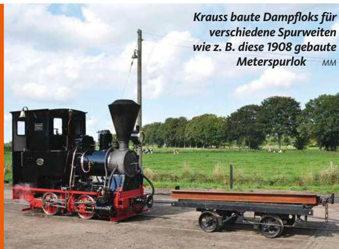
**Krauss baute Dampfloks für verschiedene Spurweiten wie z. B. diese 1908 gebaute Meterspurlok** MM
