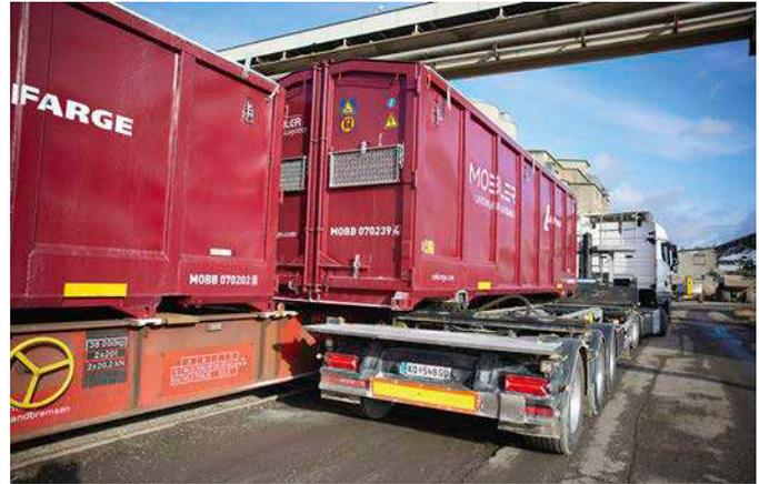
**Das Umsetzen der Container von der Straße auf die Schiene und umgekehrt kann von einer Bedienerperson über Umsetzschienen mittels hydraulischer Verschiebeelemente erledigt werden**
