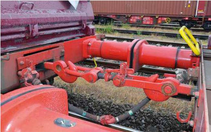
**Die für das MOBILER-System eingesetzten Sgmmrrss-y-Drehgestell-Flachwagen sind mittels einer Schraubekupplung aus zwei fest gekuppelten Wagen zu einer Einheit verbunden**
