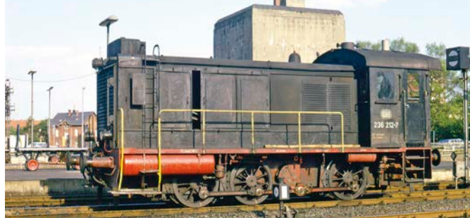
Nur wenige Loks der DB-Baureihe V 36 – wie die hier am 16. Mai 1974 in Emden fotografierte 236 212 – erhielten nachträgliche Geländer am Umlauf, was die Sicherheit für die Personale im Rangierdienst erhöhen sollte
