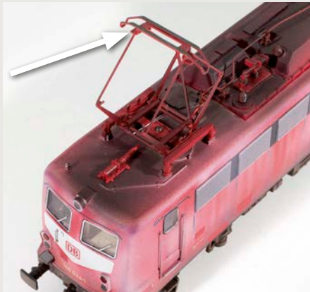
Hier ist das Winkelprofil erkennbar, dessen Zusammenbiegen den Höhenausschlag des Scherenstromabnehmers begrenzen kann
