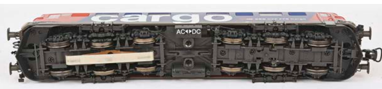
Ab Werk ist der Schleifer für das Märklin-System montiert. Für den DC-Betrieb wird er abgezogen und der Schalter umgestellt
