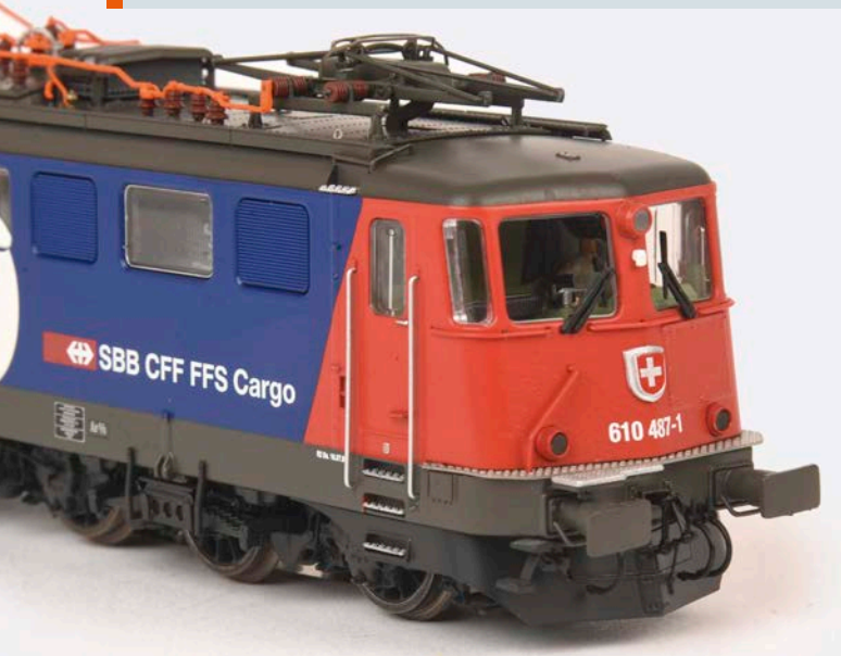
ESU H0: Die unten angeschlagenen Scheibenwischer weisen auf die nach 2003 erfolgte Modernisierung der Ae 6/6-Führerhäuser hin
