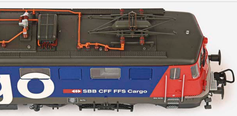
Der Dachbereich mit digital anhebbaren Stromabnehmern ist vorbildgerecht umgesetzt
