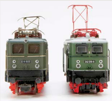
Beim Piko-Modell der DR-E 42 (links) gut erkennbar ist der mit geringer Höhe festgelegte Stromabnehmer. Beim Brava-Modell (rechts) erreicht er indes die volle werkseitig mögliche Höhe
