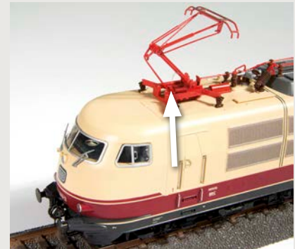
Bei Einholmpantografen kann ein dünner Nylonfaden in einer kleinen Bohrung Wunder wirken. Märklin etwa nutzt das als Antrieb bei den motorisch bewegten Stromabnehmern
