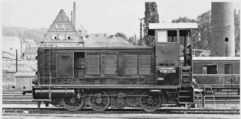
Die Bundesbahn-Direktion Wuppertal entwickelte 1954/55 für den Einmannbetrieb eine hochbauende Führerstandskanzel der Bauart Steinbeck, doch V 36 238 blieb ein Einzelstück
