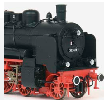
Ab Werk sind Kolbenstangenschutzrohre montiert
