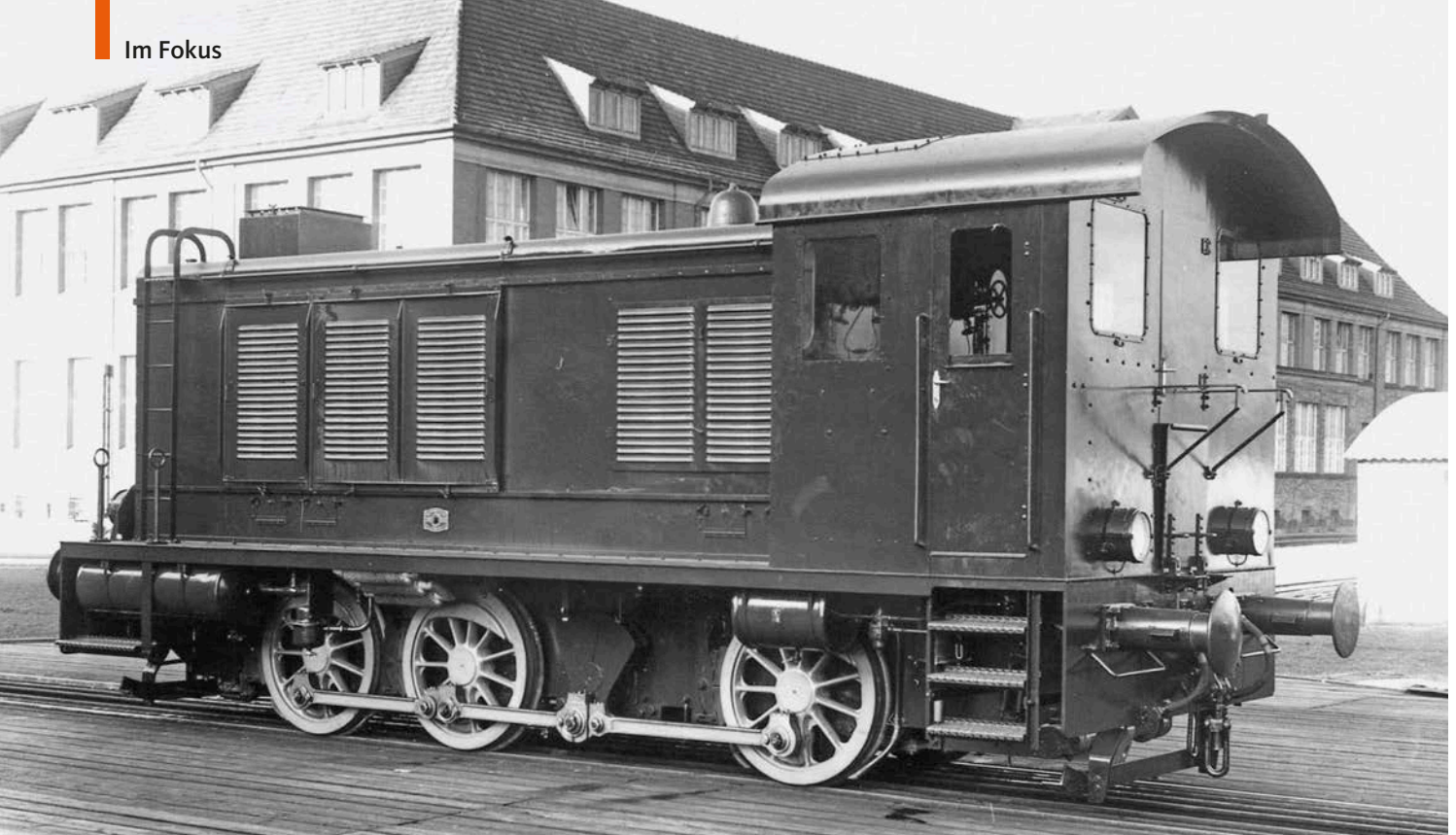
1939 wurde von der BMAG unter der Fabriknummer 10845 diese WR 360 C14K für die Luftwaffe gefertigt und auf der Drehscheibe des Herstellerwerks porträtiert. Die Lok verfügt über einen Explosionsschutz
