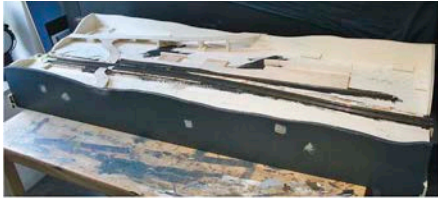
Gleisverlegung mit schallschluckender Korkbettung auf dem Bahnhofssegment (links) und drei gestapelte Anlagenkästen von unten mit der sichtbaren Elektroinstallation (rechts)
