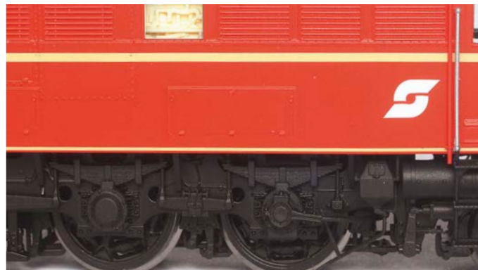
Am Fahrgestell wurden u. a. die Sandkästen angepasst Wolfgang Bdinke (2)
