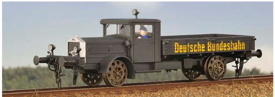
Durch Wechseln der vier Räder konnte der Lkw auf Schienen und Straßen eingesetzt werden, hier ein Vomag-Modell von Weinert in HO
