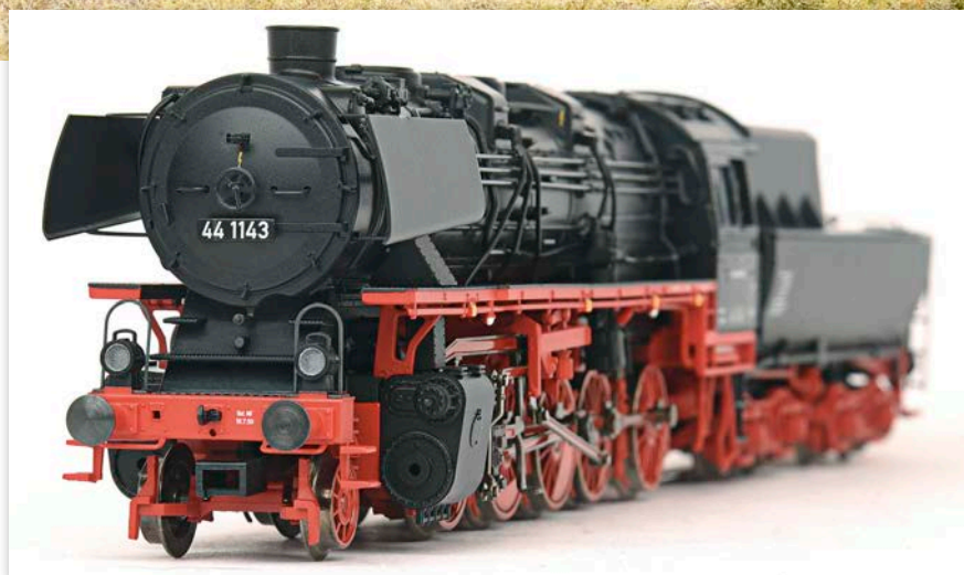
Märklin H0: Formvariante der Baureihe 44 mit Wannentender und Rauchkammertür mit Zentralverschluss
