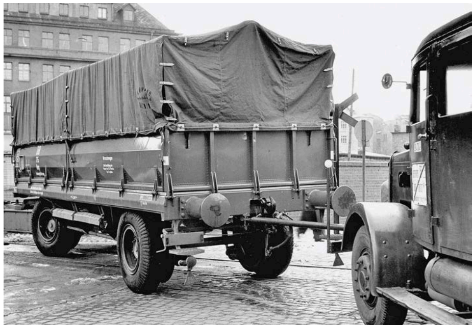
Nicht durchgesetzt hat sich der 1955 von der Waggonfabrik Uerdingen gebaute Owp 175, der wahlweise mit Schienen- oder Straßenrädern ausgerüstet werden konnte
