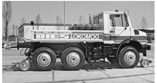
Ries Lokomog, bei dem der Unimog-Triebkopf U 1200 mit einem zweiachsigen Fahrgestell kombiniert wurde
