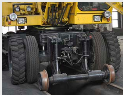
Während der Reifen für die Schiene keine groben Stollen hat, sind die äußeren auch für den Geländeeinsatz geeignet
