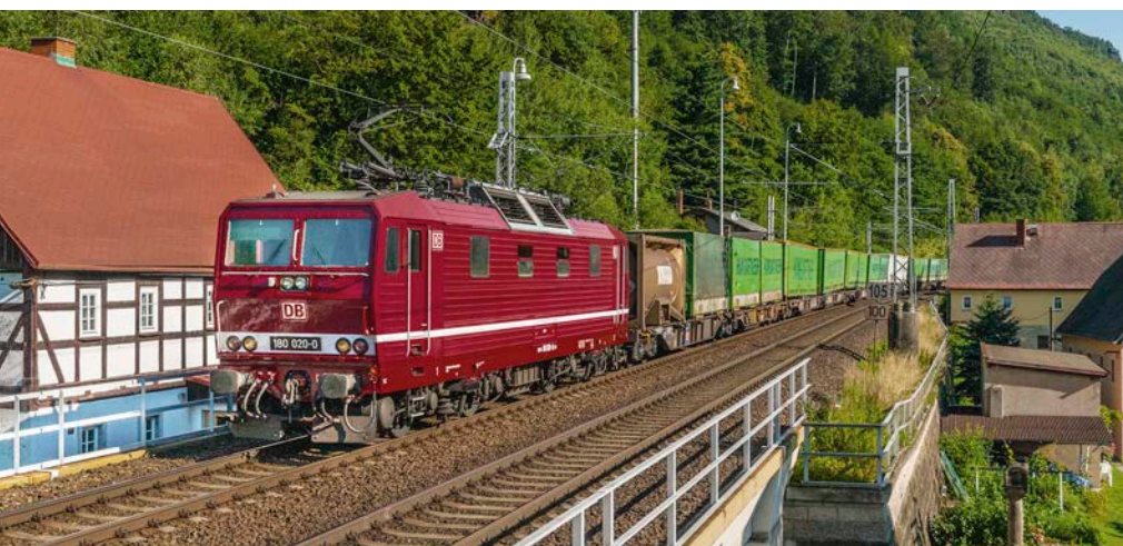
Die Škoda-Lokomotiven vom Werkstyp 80E, die zwischen 1988 und 1991 bei ČSD und DR (später DB-Baureihe 180) in Betrieb genommen wurden, verwendeten noch eine traditionelle Gleichstromtechnik, als längst schon modernere Lösungen in anderen Loks zur Anwendung kamen. 180 020 kommt am 29. Juni 2011 durch Děčín-Čertova Voda (Tschechien) Michael Sperl
