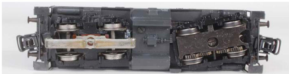
Der Antrieb erfolgt Märklin-typisch auf ein mit vier Haftreifen versehenes Drehgestell. Der Mittelschleifer zur Stromabnahme sitzt unter dem anderen Drehgestell
