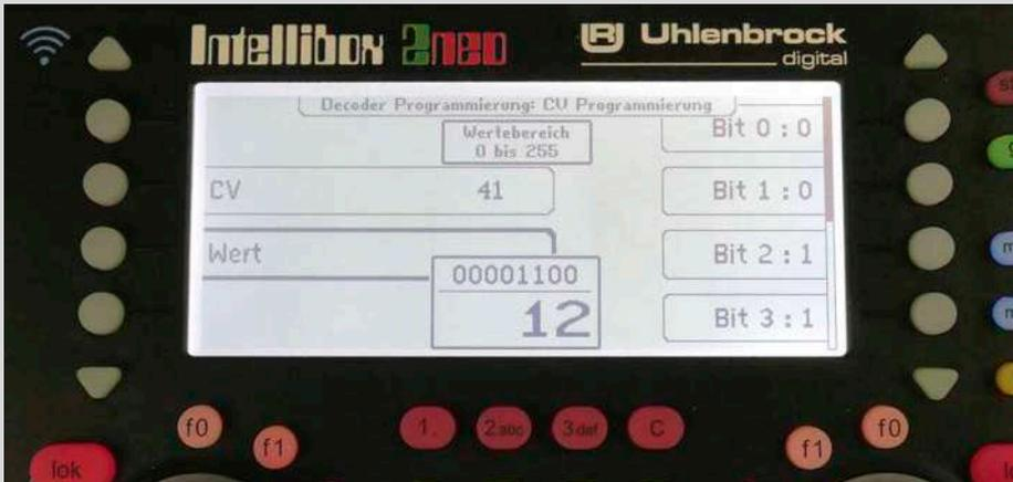
**Uhlenbrocks aktuelle Digitalzentrale Intellibox 2neo gestattet bei der weit verbreiteten CV-Programmierung von Digitaldecodern sowohl die direkte Eingabe von Dezimalwerten als auch die bitweise Einstellung je ausgewählter CV**
