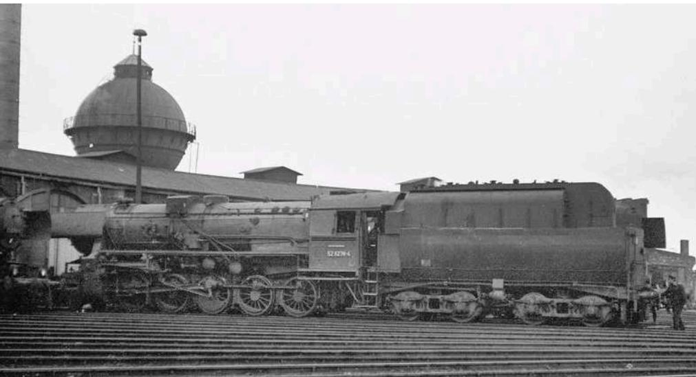
Die bei der Verbrennung freigesetzten Schwefelgase führten zu einem überdurchschnittlich hohen Verschleiß, sodass rund 1.200 der zum Umbau vorgesehenen Dampfloks zusätzlich mit einer neuen Stahlfeuerbüchse ausgerüstet werden sollten. Weiterhin war der Bau von Mahl- und Bunkeranlagen in den Bahnbetriebswerken notwendig, um eine kontinuierliche Brennstoffversorgung zu gewährleisten. Angesichts dieses
