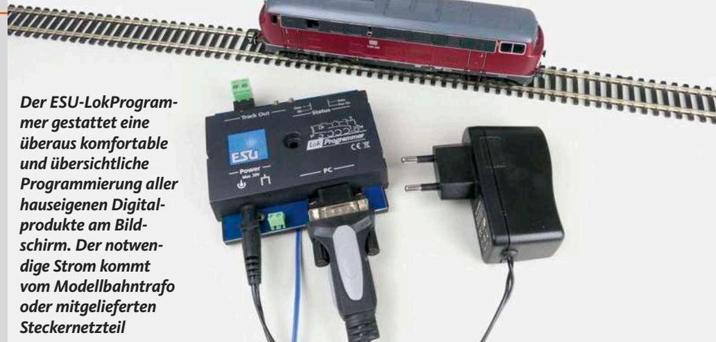
Der ESU-LokProgrammer gestattet eine überaus komfortable und übersichtliche Programmierung aller hauseigenen Digitalprodukte am Bildschirm. Der notwendige Strom kommt vom Modellbahntrafo oder mitgeliefertem Steckernetzteil
