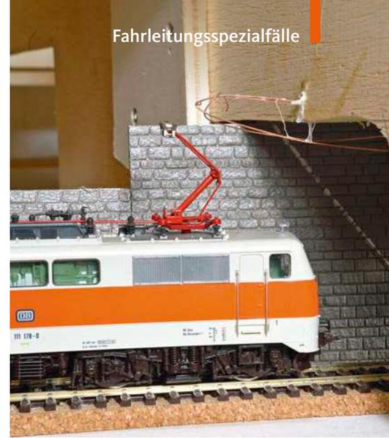
**Derartige Vorbildkonstruktionen sind leicht in Modell umsetzbar: Die der Betonsockel-Imitation beraubten Standardmasten lassen sich auf Metallstreben löten und einsetzen. Alternativ verwendet man – wie links vom Modellbauteam Köln praktiziert – kurze Hartholzleisten zur Aufnahme der Sommerfeldt-Fahrleitungsmasten**
