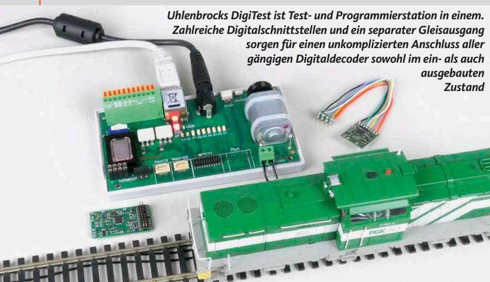
**Uhlenbrocks DigiTest ist Test- und Programmierstation in einem. Zahlreiche Digitalschnittstellen und ein separater Gleis Ausgang sorgen für einen unkomplizierten Anschluss aller gängigen Digitaldecoder sowohl im ein- als auch ausgebauten Zustand**
