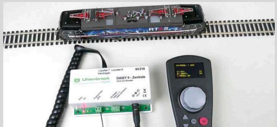
Mit der Digitalzentrale Daisy II von Uhlenbrock lassen sich über den Handregler die zuvor anhand der Bedienungsanleitung ermittelten CV-Werte recht einfach als Dezimalwerte in den Digitaldecoder übertragen
