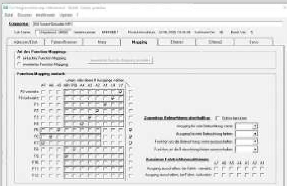
**In der DigiTest-Software lassen sich die Funktionstasten und die Digitalfunktionen über Häkchen miteinander verknüpfen. Auch komplexe Zuordnungen und weitere Abhängigkeiten sind mit der Software und ein wenig Übung schnell eingestellt**
