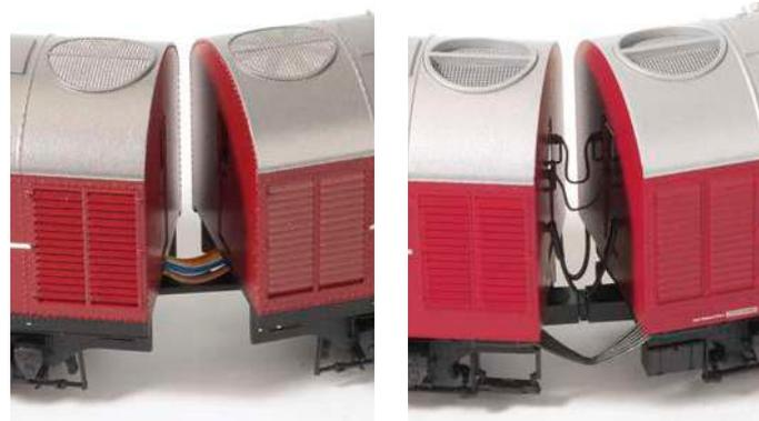
**Bei Märklin (links) stören die vor allem im Bogen gut sichtbaren farbigen Decoder- und Motorlitzen zwischen den beiden Lokhälften. Durch den doppelten Decodereinsatz benötigt Roco im Übergang keinerlei elektrische Verbindungen. Die nachgebildeten Leitungstrappen sind selbst in engen Gleisradien beweglich genug**
