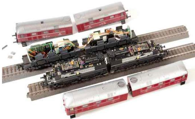
**Märklin (hinten) spendierte seinem Modell vier Drehgestelle, von denen zwei den klassischen Rundmotor tragen, wofür ein Decoder genügt. Roco setzt indes auf zwei technisch identische Lokhälften, deshalb trägt jedes Fahrgestell einen Skischleifer. Gut erkennbar ist die farbige Roco-Maschinenraummatrappe; die Lüfter sind zwar angetrieben, aber durch die Abdeckgitter kaum erkennbar**
