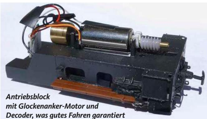
Antriebsblock mit Glockenanker-Motor und Decoder, was gutes Fahren garantiert
