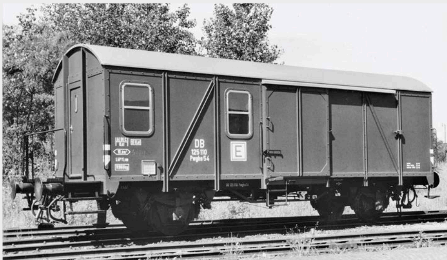
Güterzuggepäckwagen der DB-Gattung Pwghs 54 mit einem E-Symbol für den Einsatz im Eilgüterzugverkehr
