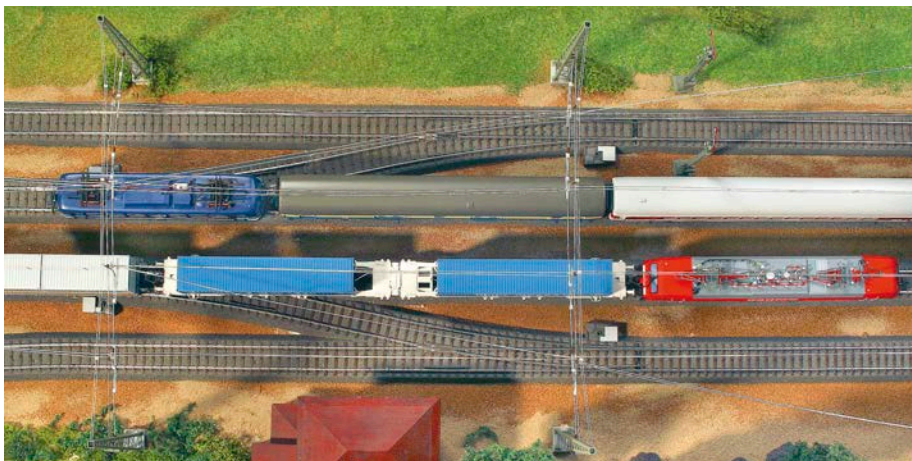
Fahrleitungsverlauf an symmetrisch aufgebauter Bahnhofseinfahrt aus der Vogelperspektive
