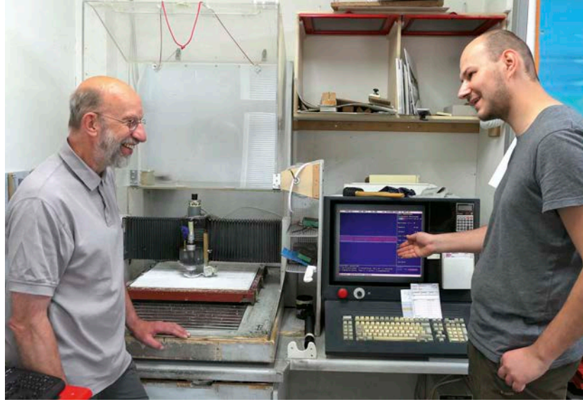
Speziell die 1:22,5-Gebäudeteile werden an dieser CNC-gestützten Fräsmaschine bearbeitet, die noch aus der Anfangszeit der Firma von Bertram Heyn (l.) stammt. Eine modernere Maschine gibt es aber auch
