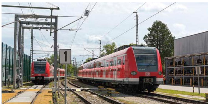
Eine Kamerabrücke dient zur Sichtbefundung, die Daten werden von einer KI analysiert
