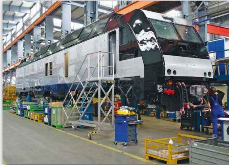
Blick in die Endmontage in Kassel am 7. Oktober 2010: ALP-46A für New Jersey Transit ist von der deutschen 101 abgeleitet und wird im New Yorker Vorortverkehr eingesetzt Jürgen Hörstel
