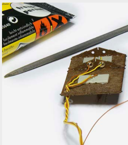
In die Dachplatte kann die Viessmann-Lichttechnik eingebaut werden. Es empfehlen sich warmweiße Leuchtdioden fürs Büro und kaltweiße für die Werkstatt
