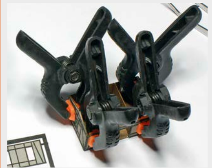
Solche Miniklammern sind bei Bausatzmontagen aller Art unentbehrliche Helfer
