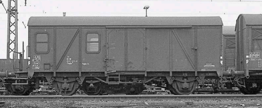
Im Dezember 1970 konnte dieser Pwghs 054 in Hamburg-Wilhelmsburg angetroffen werden. Kurz darauf wurden diese Güterzugbegleitwagen entweder in normale Gls 205 umgebaut oder zu Werkstatt- und Gerätewagen umfunktioniert
