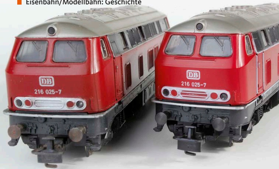
Märklins 216 025 der ersten Jahre (links) unterscheidet sich vor allem durch den komplett silbern eingefärbten Kühlergrill zwischen den unteren Stirnlampen von der späteren Version ab 1972 mit weiß bedrucktem Gitter
