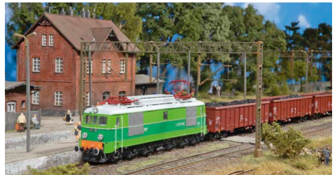
Diese für polnische Bahnhöfe bis heute typischen Tragwerke aus Traversen bietet Kluba an. Deren geringe mechanische Belastbarkeit führt jedoch dazu, dass auf Kettenwerke verzichtet wird
