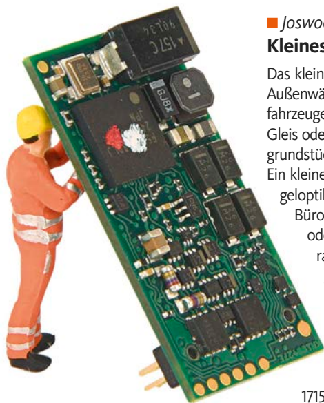
Märklin HO: Rund 30 mal 15 Millimeter misst der SoundDecoder mSD3 MM (5)
