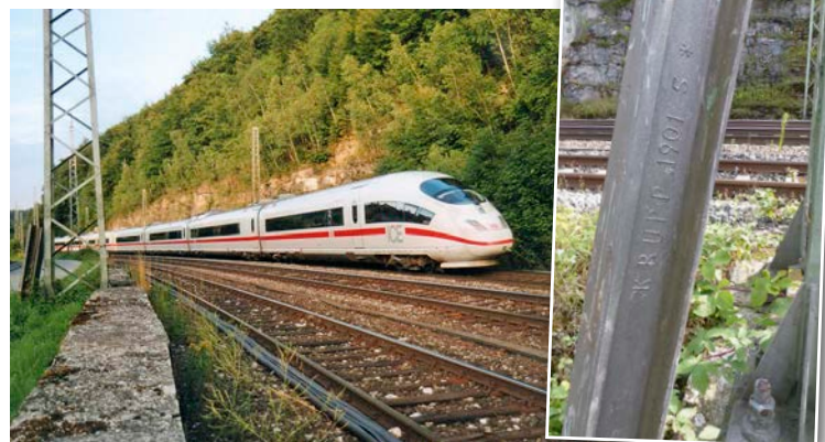
Im Jahre 2009 im Altmühltal fotografierter ICE mit dem links zu sehenden Fahrleitungsmast, der durch ein altes Krupp-Schienenstück geschützt wird, das inzwischen grau lackiert wurde Rainer Kamienski (2)
