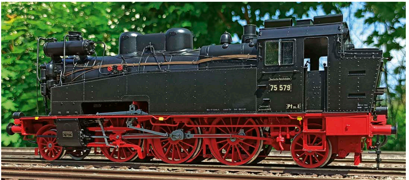
Durch die unterschiedlichen Kesselaufbauten ist die Baureihe 75 e leicht von den Schwestermaschinen zu unterscheiden Carl Bellingrodt/Slg. TechnikMedia
