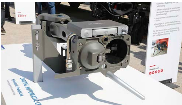
Der von Knorr-Bremse entwickelte DAK-Prototyp der neusten Generation verfügt über flachere Aufbauten. Mehr zu den Unterschieden zum Vorgängermodell erläutert Andreas Lipka von DB Cargo im Video unter https://youtu.be/OEfHbwqNJk8 Jürgen Hörstel
