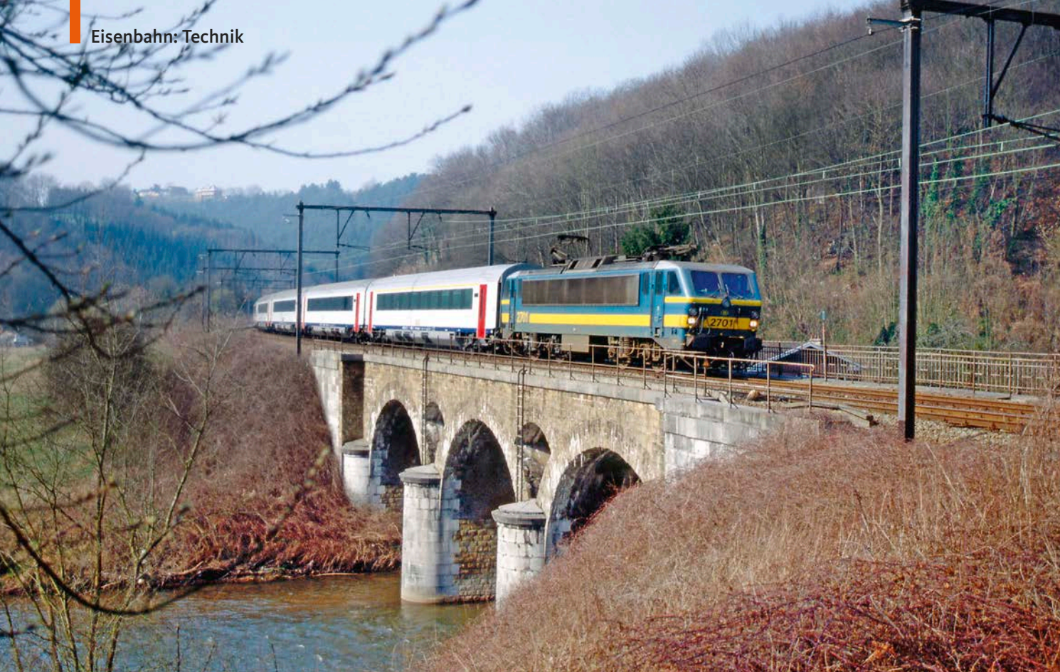
Doppelte Fahrdrachtaufhängung an der belgischen Trasse von Trooz Richtung Aachen, auf der im April 1997 die Elektrolokomotive 2701 einen EC nach Köln befördert. In HO gibt es diese Elemente bei Sommerfeldt
