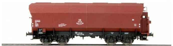
Der Tdgs der DB ist eine Spezialkonstruktion aus den 1930er-Jahren. Er besitzt vier zum Teil verschiebbare Radsätze. Fleischmann setzte dem Exoten in H0 ein Denkmal
