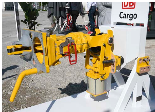
Die automatische Rangierkupplung soll in der Übergangsphase sowohl mit bereits umgerüsteten als auch mit herkömmlichen Waggons kompatibel sein Florian Dürr
