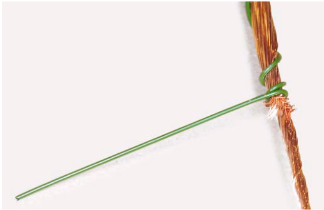
Die Kupferdrahtbündel werden mittels Blumenbinde- drahtumwicklung stabilisiert
