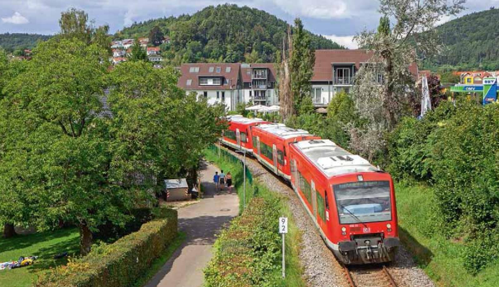
Die zuerst von Adtranz und ab 2001 von Stadler gebauten Regio Shuttle RS1 sind heute auf vielen nicht-elektrifizierten Strecken in Deutschland anzutreffen. Die Triebwagen, deren Wagenkasten auf einer markanten Fachwerkkonstruktion mit diagonalen Streben basiert, fanden bei diversen Eisenbahnverkehrsunternehmen Anklang. So stellten unter anderem die Ostdeutsche Eisenbahn, die Länderbahn und die Hohenzollerische Landesbahnen (heute SWEG) diese Fahrzeuge in den Dienst.
