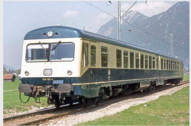
Auch der 628.1 hatte die typischen Schrägen an den Fahrzeugenden und zeigte sich seitlich mit glatten Wänden
