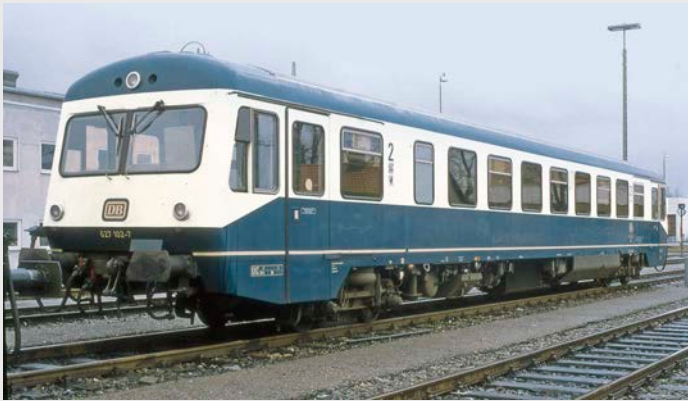
Typisch für den 627.1 war der an beiden Seiten hochgezogene vordere Fahrwerksbereich
