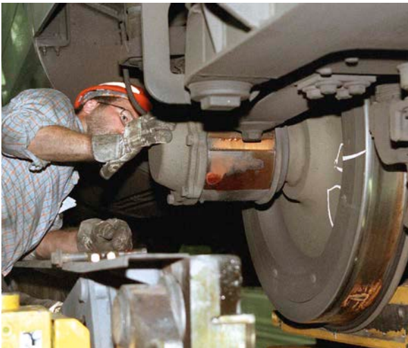
Ein Techniker begutachtet am 7. Juni 1998 im Werk München ein Rad eines ICE-Zuges. Bereits vor der Todesfahrt des ICE „Wilhelm-Conrad-Röntgen“ waren Mängel an Radreifen festgestellt worden
