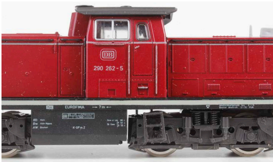
Die zwei Details der Roco-HO-Maschine zeigen die für die damalige Zeit ausgezeichnete Bedruckung sowie den Antrieb aller Radsätze mit zusätzlich zwei Haftreifen Oliver Strüber (2)
