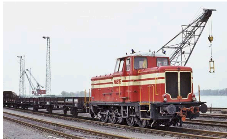
Deutz fertigte 16 Dieselloks vom Typ MS 800 D, die über einen Beugniot-Hebel verfügten. Dazu zählt auch V 53 der Köln-Bonner Eisenbahn, die am 4. Mai 1985 im Hafen Godorf rangiert
