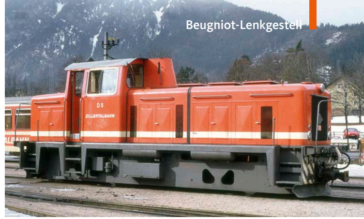
Die von Orenstein & Koppel (26615/1967) gebaute 760-Millimeter-Gelenkwellen-Lok MD 18s mit Beugniot-Lenkgestellen (statt teurerer Drehgestelle) war als D 8 bei der Zillertalbahn eingestellt (Foto in Jenbach im März 1994). Sie ging im Jahr 2022 an die Stainzer Lokalbahn in der Steiermark
