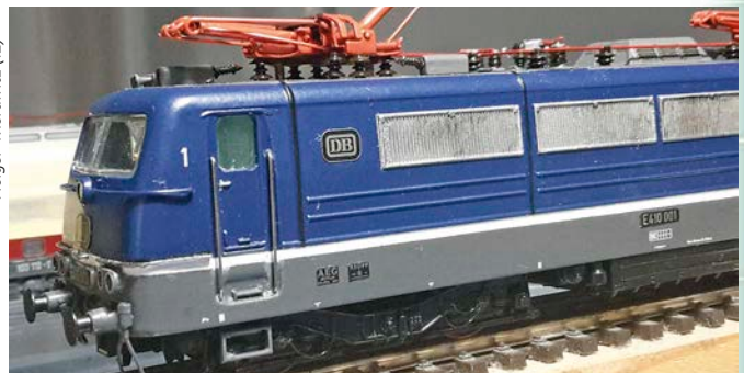
Der E 410-Beschriftungssatz von Gaßner beinhaltet auch Neusilberschilder, die zuerst schwarz lackiert und nach dem Trocknen der Farbe über feines Schleiflein gezogen werden
