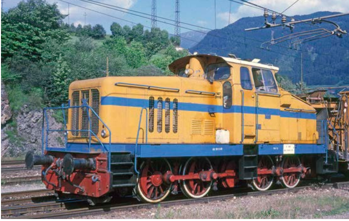
Die durch das Märklin-Modell bekannte Aufbauform wurde nicht nur für die Gelenkwellenloks DHG 500/700, sondern auch für Henschel-Stangenloks verwendet. Der Beugniot-Vierkupppler DH 850 D wurde lange im Ruhrgebiet eingesetzt, unter anderem bei der Dortmunder Eisenbahn. 1986 dient sie als Bauzuglok in Sterzing
