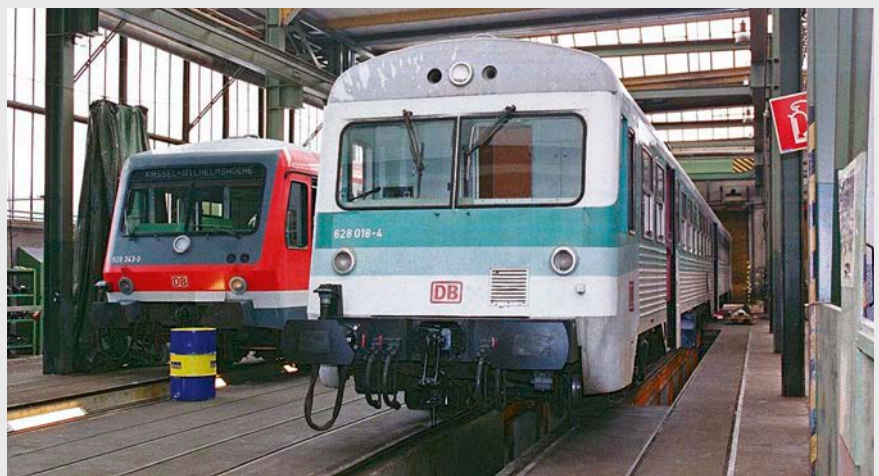
Vergleich der 628-Ursprungsbauart (rechts) mit der Nachfolge-Baureihe 628.2 (links) im Januar 2002 im Ausbesserungswerk Kassel
