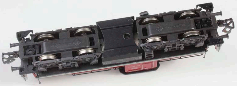
Die zwei Details der Roco-HO-Maschine zeigen die für die damalige Zeit ausgezeichnete Bedruckung sowie den Antrieb aller Radsätze mit zusätzlich zwei Haftreifen Oliver Strüber (2)
