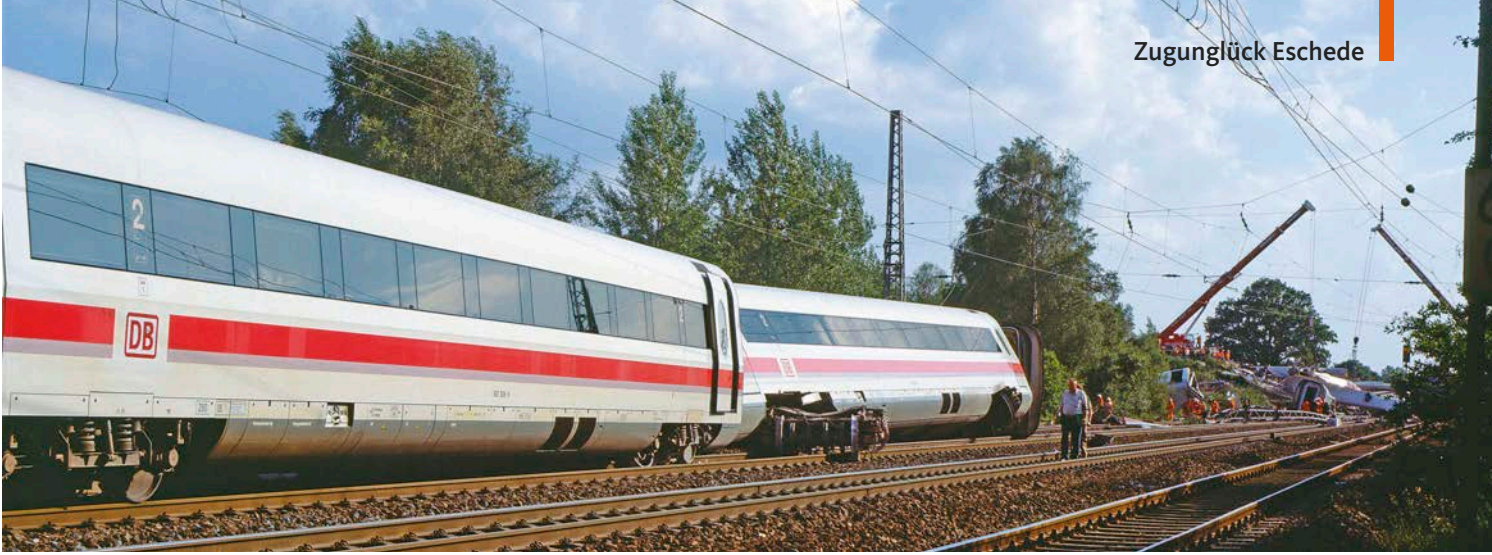
Unglückszug bei der Escheder Katastrophe ist ein ICE-1 mit den Triebköpfen 401 051/551. Die ersten drei Mittelwagen kommen ein Stück hinter der Brücke zum Stehen, am ersten Mittelwagen 802 808 (links) ist am vorderen Radsatz des hinteren Drehgestells der gelöste Radreifen erkennbar, der später als Ursache des Desasters identifiziert wird (3. Juni 1998)
