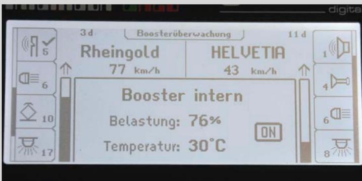
Display-Modus zur Überwachung der LocoNet-Booster: Der interne Booster hat eine Temperatur von 30°C und eine aktuelle Belastung von 76 Prozent
