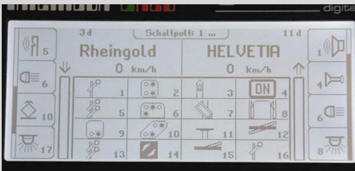
Display für die Geschwindigkeitsanzeige: Beide Züge fahren 0 km/h, wenn die Displayanzeige auf Geschwindigkeit steht; alternativ werden Fahrstufe oder Prozentwerte angezeigt
