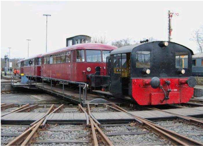
**Auf diesem Vorbildfoto an einer Drehscheibe erkennt man gut den Aufbau des Laufstegs aus verkeiltem Balken zwischen den Schienen und darauf rechtwinklig aufgenagelten Holzbrettern**
