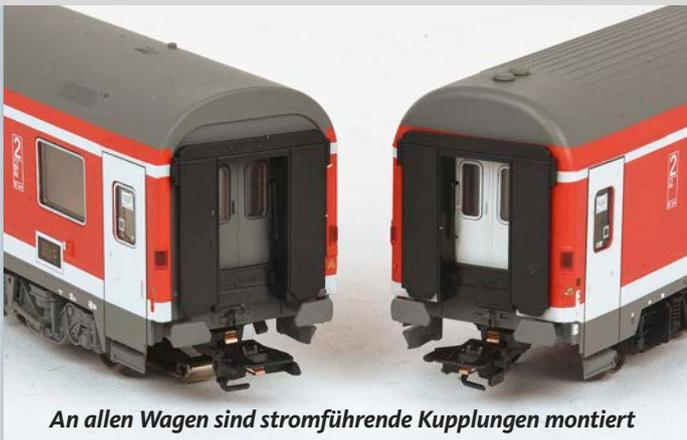
An allen Wagen sind stromführende Kupplungen montiert
