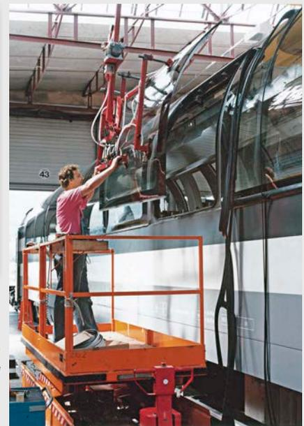
Montage der 140 Kilogramm schweren Panoramastunden per Hilfseinrichtung
