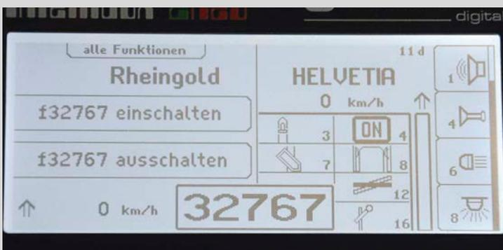
Display für das Schalten von bis zu 32.768 Sonderfunktionen im DCC-Binary-State: Aktuell kann die Funktion 32767 aktiviert werden
