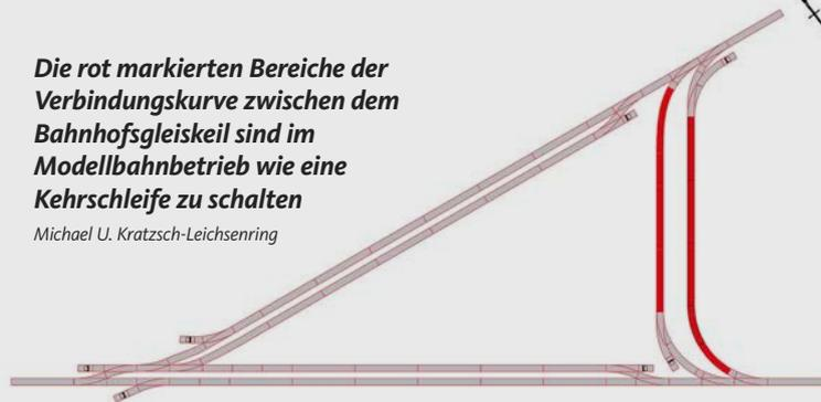
modulen nur bedingt zu empfehlen. Bei Umpolung innerhalb eines (Kehrschleifen-) Abschnittes würde der darin fahrende Zug abrupt seine Fahrtrichtung ändern, und bei Umpolung außerhalb fahren die restlichen
