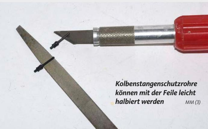
Kolbenstangenschutzrohre können mit der Feile leicht halbiert werden MM (3)
