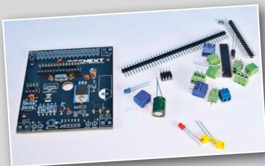
**Bestückter DCCNext-Decoder (rechts), vor dessen Zusammenbau niemand Angst haben muss, da alle Details in der Anleitung gut beschrieben sind. Beim Bestücken (Bild oben) sollte man zunächst mit den flachen Bauteilen wie den Widerständen anfangen und sich dann vorarbeiten. Am Schluss folgen die großen Bauteile**
