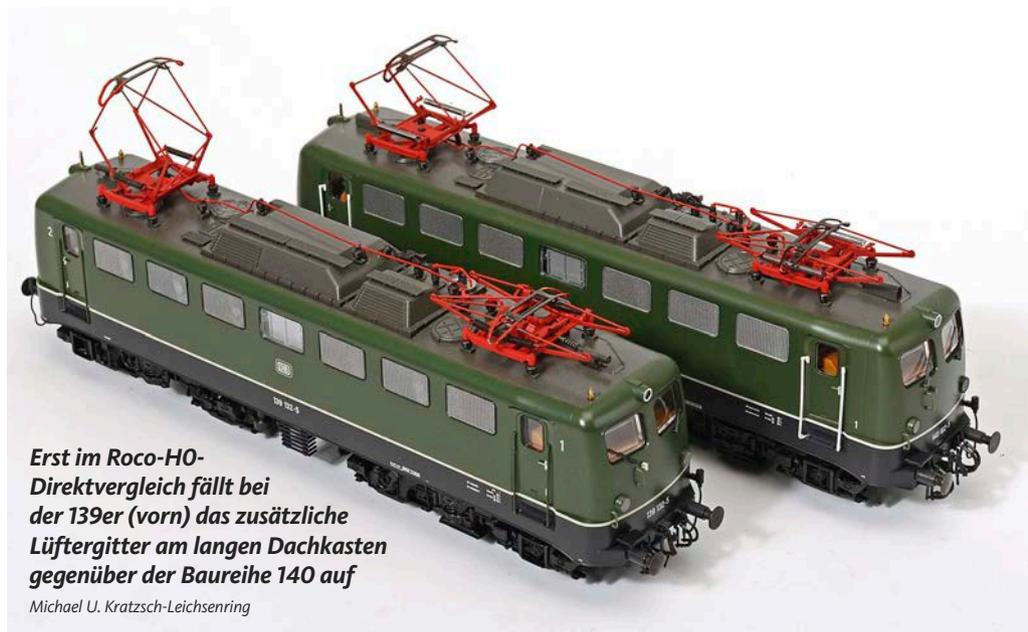
Erst im Roco-HO-Direktvergleich fällt bei der 139er (vorn) das zusätzliche Lüftergitter am langen Dachkasten gegenüber der Baureihe 140 auf
