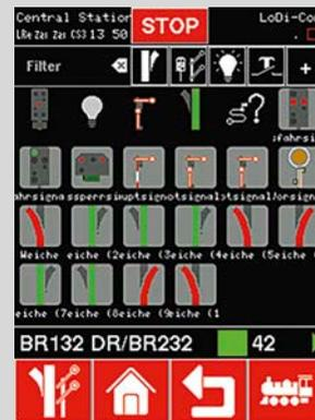
*Zubehör-Decoder an Weichen oder Signalen werden bequem per Touch-Bedienung geschaltet. Das Triebfahrzeug bleibt dabei weiter über den Drehregler steuerbar. Wichtige Informationen werden unten angezeigt*
