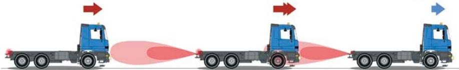
Die CarMotion-Kraftfahrzeuge besitzen an den Stirnseiten Infrarotsender und -empfänger, die eine sichere Abstandsregelung beim Fahren gewährleisten
