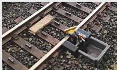
Selbst gebaute mechanische Gleissperre in geschlossener und geöffneter Stellung
