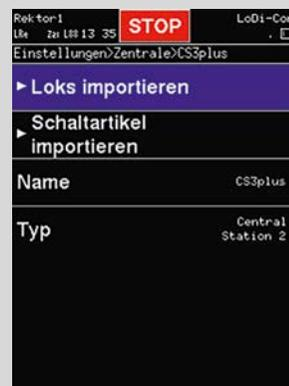
*Aus der ECoS von ESU und den CS 2/3-Zentralen von Märklin/Trix lassen sich alle angelegten Objekte wie Triebfahrzeuge und Zubehör-Decoder in den LoDi-Con importieren*
