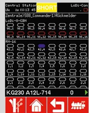
*Mit dem LoDi-Con können auch die Zustände von Rückmeldern angezeigt werden. Im Bild sind Rückmelder am S88-Commander von Lokstoredigital zu sehen*
