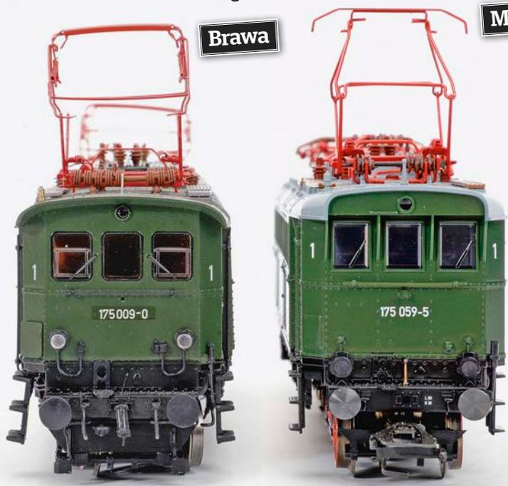
In der Frontansicht werden die unterschiedlichen Scherenstromabnehmer und Lampenplatzierungen deutlich sichtbar. Bei Brawa (links) lässt sich der Pufferträger mittels Zurüstteilen aufwerten
