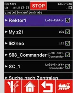
*Eine Besonderheit des LoDi-Con ist, dass er nicht nur verschiedene Zentralen unterstützt, sondern diese auch gleichzeitig nutzen kann. Die Triebfahrzeuge werden dabei den jeweiligen Digitalsteuergeräten automatisch zugeordnet*
