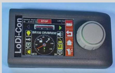
**Das hervorragende Farbdisplay in einer Größe von 4,9 mal 6,5 Zentimetern dreht sich wie bei einem Handy mit der Lage des Gerätes in der Hand des Bedieners**
