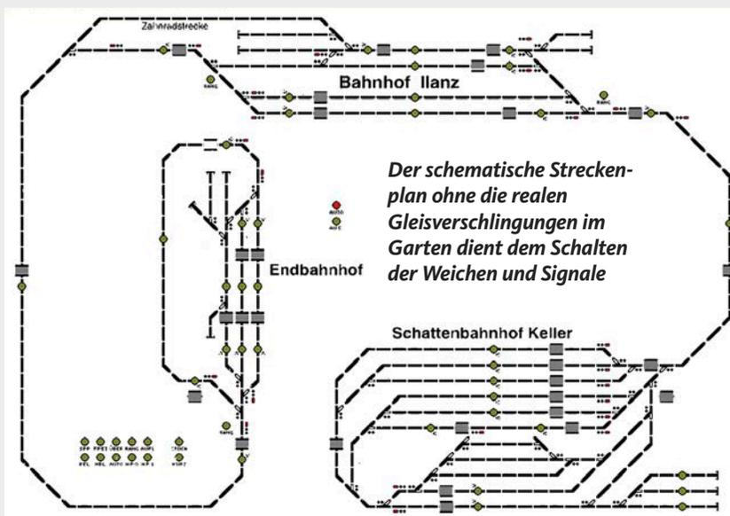
eingleisige Strecke führt aus dem Schattenbahnhof zu einem viergleisigen Zwischenbahnhof mit der Möglichkeit, Züge kreuzen zu lassen, Überholungen einzuplanen, kurze Züge und Wagen abzustellen sowie Rangierbewegungen durchzuführen.
