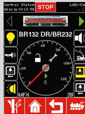
*Im Fahrbetrieb lässt sich die Geschwindigkeit über den Drehregler einstellen. Die Funktionen werden auf dem Touch-Display geschaltet. Wird die Anzeige mit dem Finger verschoben, werden unten weitere Lokfunktionen sichtbar*
