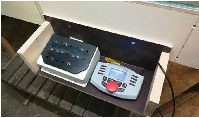
Zusätzlich zur Märklin-MobileStation für die Zugsteuerung wurde ein Gleisbildstellpult gebaut, das zum Stellen der Weichen und Signale sowie zum Schalten von Beleuchtung und Funktionen dient
