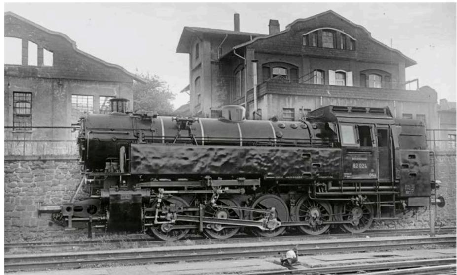
An der fabriken im Bw Siegen angekommenen 82 024 fällt das wellige Wasserkastenblech auf. Auf dem Rauchkammerscheitel ist die Abdeckung der für den Oberflächenvorwärmer freigehaltenen Einpolterung erkennbar
