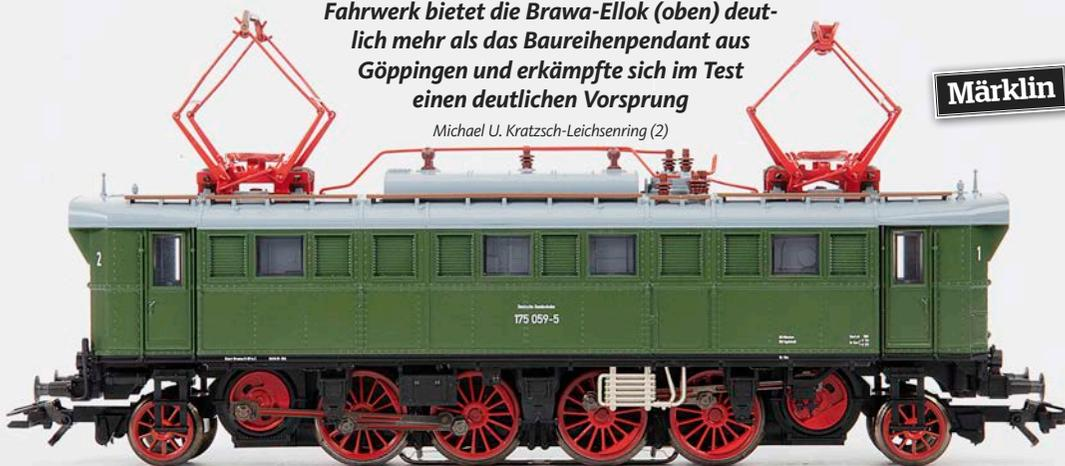
sowie Anpassen der Lautstärke über F 19/20. Selbstverständlich sind die Maschinenraum- wie auch Führerstandsbeleuchtung separat schaltbar. Beim Rangiergang leuchtet auf beiden Seiten je eine Laterne weiß. Leider besitzt das Modell keine größeren Pufferkapazitäten, was sich vor allem beim Fahren mit Sound auf verschmutzten Gleisen schnell unangenehm bemerkbar machen kann.
