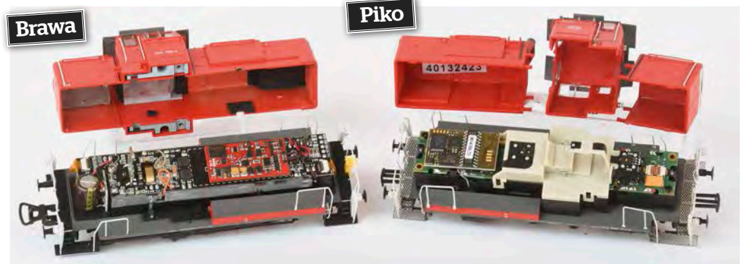
Nachdem man die Gehäuse abgenommen hat, werden die verbaute Elektronik, die Antriebstechnik sowie die eingebaute LED-Beleuchtung sichtbar
