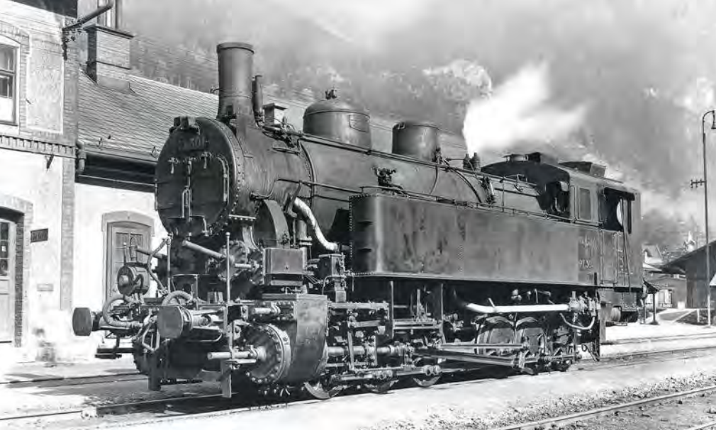
In nur drei Exemplaren entstand 1912/13 die sechsfach gekuppelte Reihe 269 als damals größte Zahnradampflokomotive der Welt. Vor dem Vordernberger Empfangsgebäude wurde die Lok 97 301 dem Fotografen am 24. Mai 1942 präsentiert
