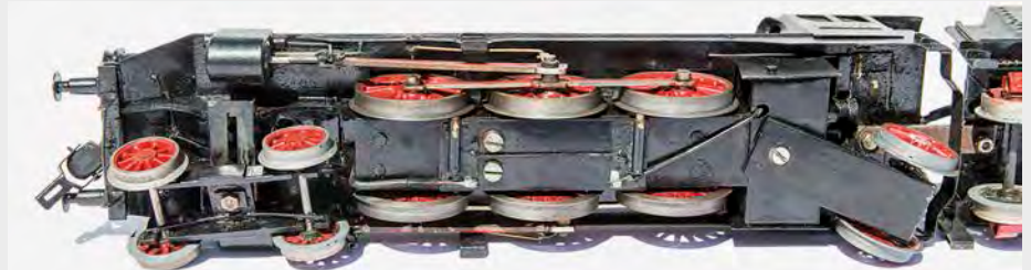
Der erste und dritte Kuppelradsatz der Lok werden über den im Stehkessel platzierten Motor und ein Schneckengetriebe in Bewegung gesetzt. Aufgrund der relativ starren Lok/Tender-Verbindung ist das erste Tenderdrehgestell seitenverschiebbar
