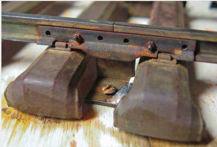
Die verlaschten, gealterten Schienen liegen auf Stahlschwellen-Nachbildungen, die aus Resin gegossen wurden. Deren Ur-Modell entstand im 3D-Druck
