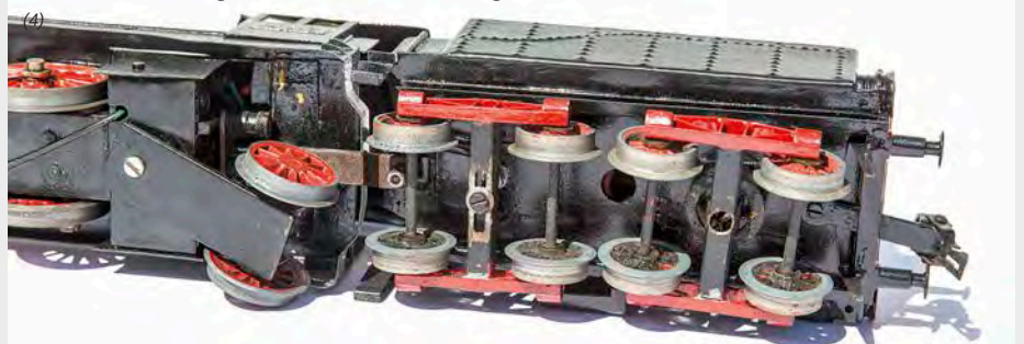
Der erste und dritte Kuppelradsatz der Lok werden über den im Stehkessel platzierten Motor und ein Schneckengetriebe in Bewegung gesetzt. Aufgrund der relativ starren Lok/Tender-Verbindung ist das erste Tenderdrehgestell seitenverschiebbar
