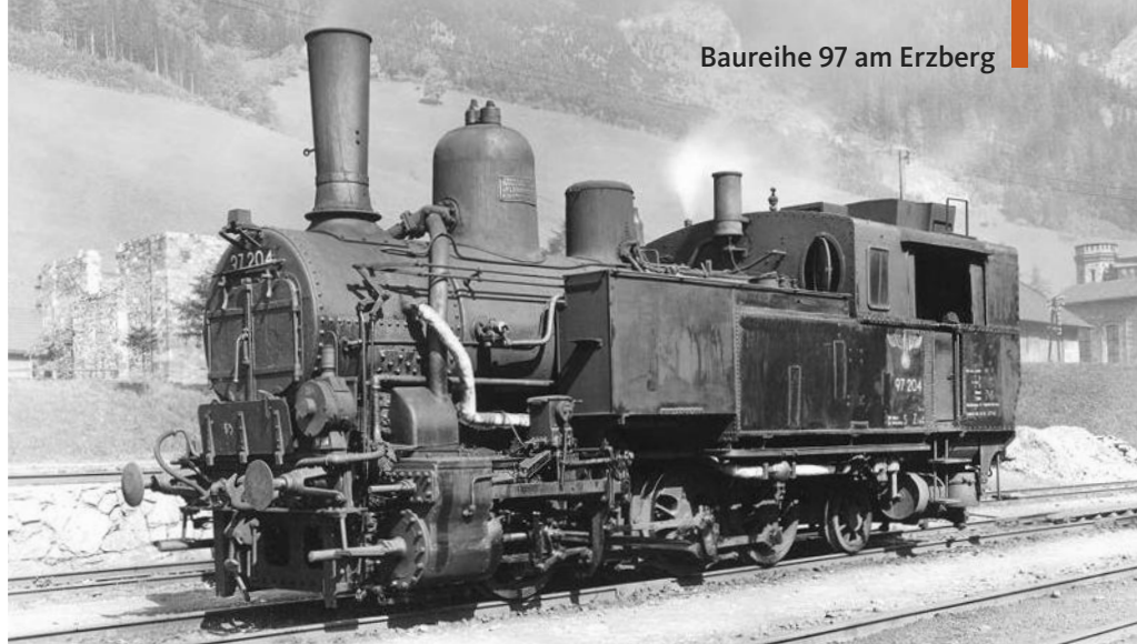
Die kkStB-Reihe 69 wurde bei der Reichsbahn zur Baureihe 97 2 (Zweitbesetzung). Die ältesten Exemplare standen hier von 1891 bis weit in die 1970er-Jahre im Dienst. Am 26. Mai 1942 wartet die C1'-Lok 97 204 im Bahnhof Vordernberg auf neue Aufgaben
