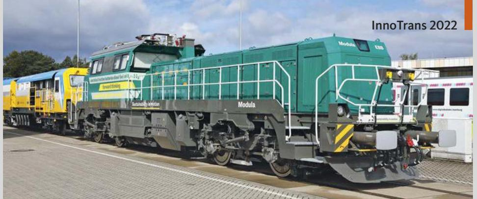
**Vossloh Rolling Stock: Das Konzept der Modula basiert auf einem Baukastenprinzip, nach dem verschiedene Kombinationen von Antriebsarten zusammengestellt werden können** Jürgen Hörstel (3)
