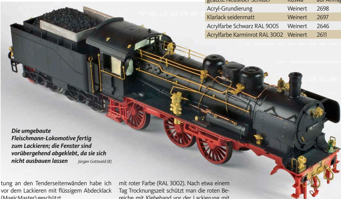
**Die umgebaute Fleischmann-Lokomotive fertig zum Lackieren; die Fenster sind vorübergehend abgeklebt, da sie sich nicht ausbauen lassen** Jürgen Gottwald (8)
