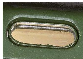
Stirnfenster mit grün überlackiertem Scheibenrahmen bei Brawa (links) und profiliertem Rahmen am Piko-Gehäuse
