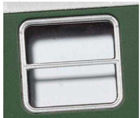
**Darstellung des typischen Übersetzfensters der Umbauwagen mit Regenabweiser bei Brawa (links) und breiter gehaltenem Piko-Rahmen (rechts), offensichtlich mit Innen- und Außenrahmen graviert**
