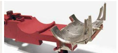
**Der vordere Rahmenbereich wird solange befeilt, bis das Reitz-Füllstück eingesetzt und verklebt werden kann**
