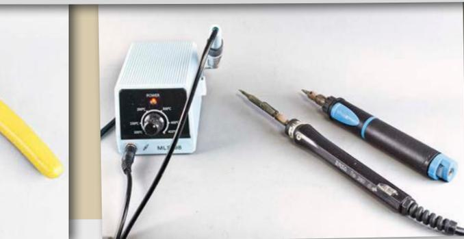
*Die Lötstation MLS-98 von Modellbau Schönwitz ist der absolute Preistipp. Der Ersa-LötKolben Tip 260 daneben bietet die Möglichkeit, unterschiedliche Lötspitzen einzusetzen. Der Ersa-GaslötKolben rechts ist für den mobilen Einsatz bei Ausstellungen interessant*
