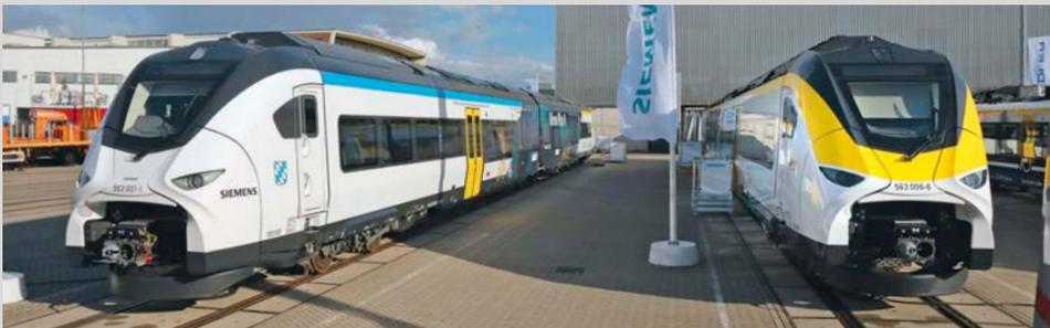
Desiro HC (High Capacity) mit seinen einstöckigen Endtriebwagen und doppelstöckigen, nicht angetriebenen Mittelwagen ist inzwischen unter anderem als RRX im Ruhrgebiet unterwegs. Auf der InnoTrans war die Version für die Ostdeutsche Eisenbahn GmbH (ODEG) ausgestellt, die die auffällig gelb-weiß lackierten Züge ab Dezember 2022 im Elbe-Spree-Netz rund um Berlin einsetzen wird.
