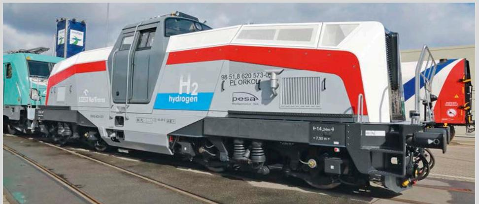
**PESA: Wasserstofflok SM42 6Dn wird demnächst in einer Raffinerie in Plock zum Einsatz kommen**
