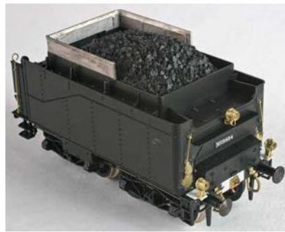
**Tender-Metamorphose von Fleischmanns Original über die aufgerüstete Version bis hin zum lackierten und patinierten Endergebnis; der Kohlenkastenaufsatz war typisch für die DB-Maschinen der Epoche III**
