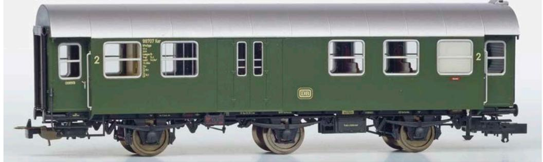
gestänge und -backen die äußeren Radsätze. Auch das WC-Fallrohr ist vorhanden. An den Pufferträgern sind die Rangiergriffe freistehend nachgebildet und die Puffer angesteckt. Kupplungshaken, komplette
