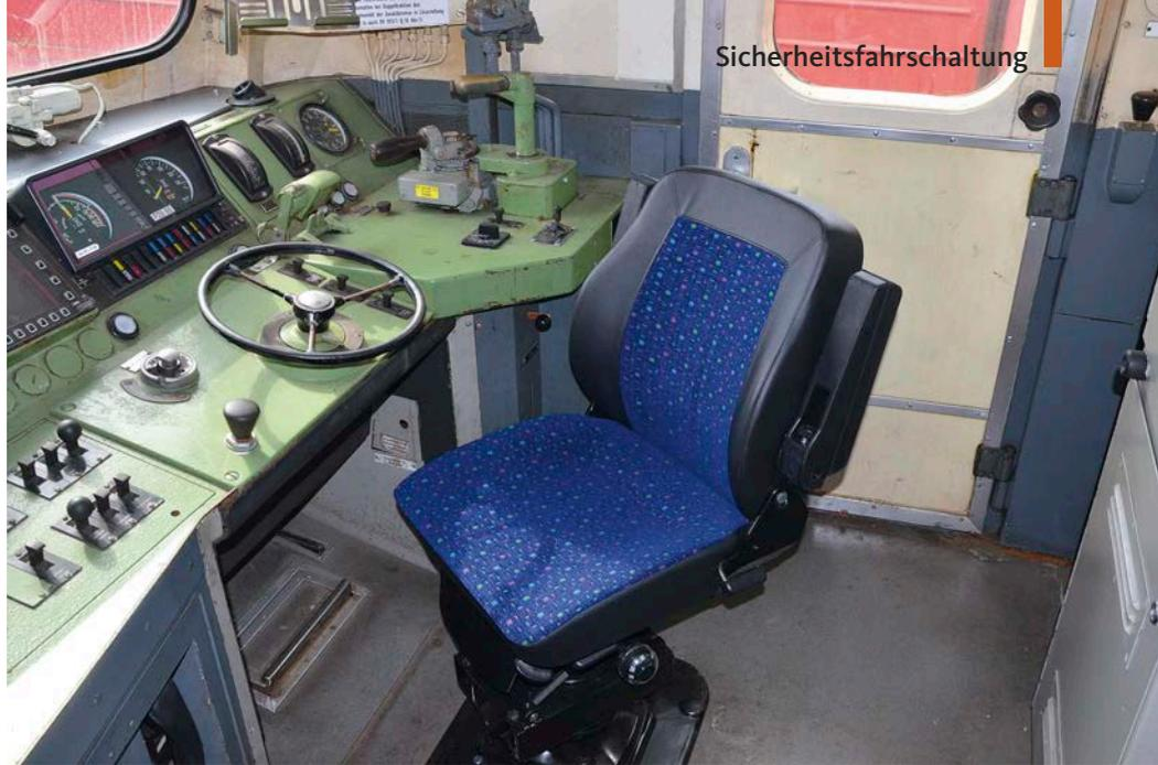
**Blick in den Führerstand von 151 026: Gut zu sehen sind der Sifa-Fußtaster und ein Sifa-Taster neben der Tür, der Leuchtmelder befindet sich im Feld hinter dem Handrad**
