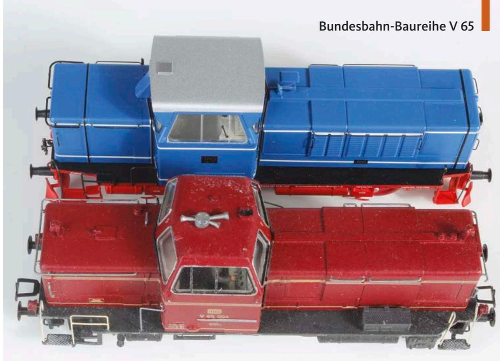
Gut zu erkennen sind die unterschiedlichen Fahrzeuglängen und Dachausführungen der V 65 bzw. MaK 600 D von Weinert (unten) und der blauen MaK 650 D von Heljan (oben) in HO
