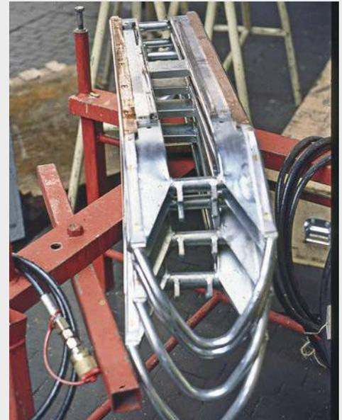
**Gestapelte Ersatzwippen der italienischen Bauart 52 für den Einsatz der interoperablen ÖBB-Reihe 1822 im 3-kV-Netz. Massive Konstruktion aus rostfreiem Stahl, in die Schleifflächen eingesetzt, austauschbare Kontaktstreifen aus Kupfer, intermittierende Schmierung der Gleitflächen** Helmut Petrovitsch
