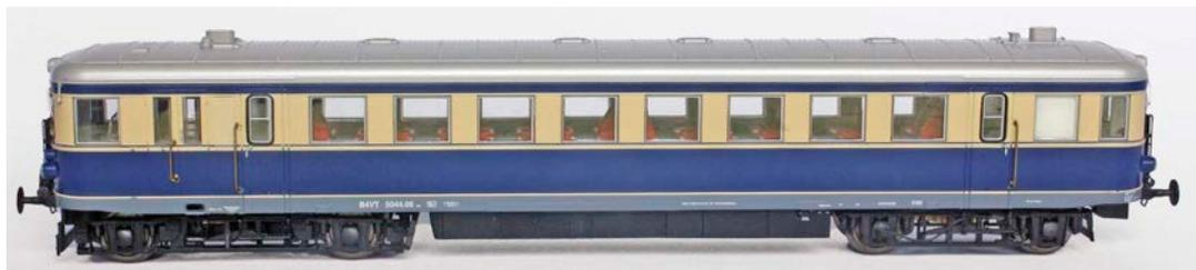
**Jägerndorfer Collection HO: In der Seitentotale erkennt man gut die unterschiedlichen Drehgestelle der ÖBB-Triebwagen-Reihe 5044 sowie die aufwendige Lackierung mit mehreren Zierlinien**
