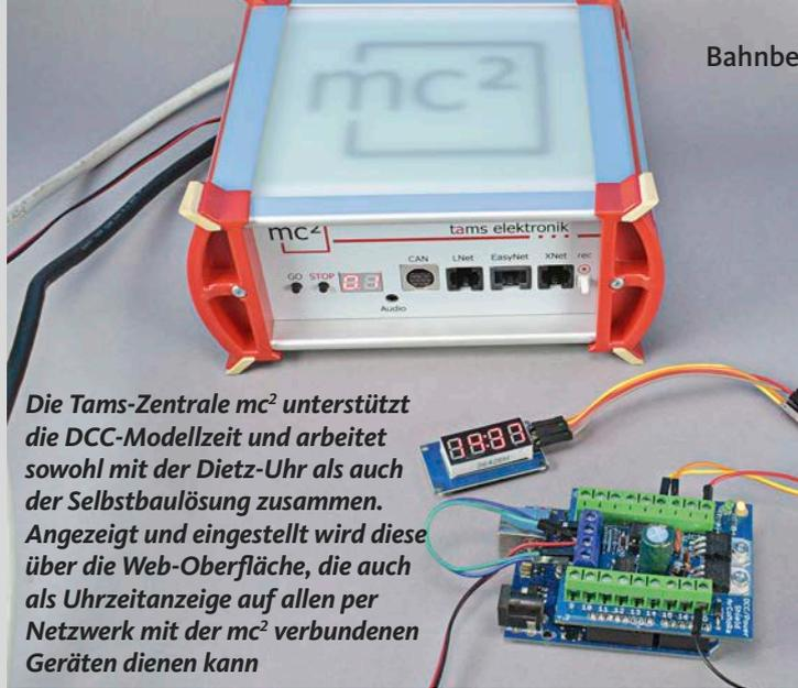
**Die Tams-Zentrale mc<sup>2</sup> unterstützt die DCC-Modellzeit und arbeitet sowohl mit der Dietz-Uhr als auch der Selbstbaulösung zusammen. Angezeigt und eingestellt wird diese über die Web-Oberfläche, die auch als Uhrzeitanzeige auf allen per Netzwerk mit der mc<sup>2</sup> verbundenen Geräten dienen kann**
