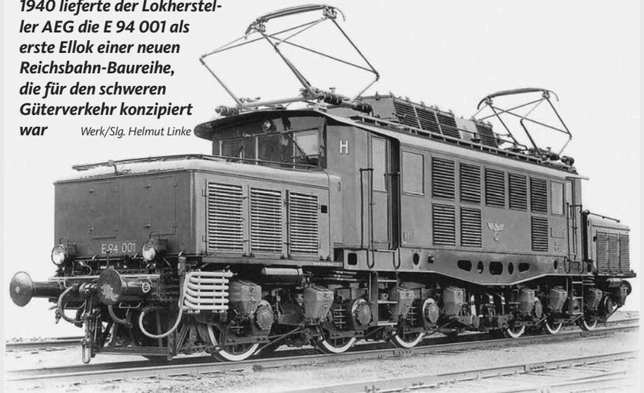
der DRB eingeordnete Lokomotive wurde am 22. April 1940 angeliefert. Zwei gegenüber nicht tauschbare dreiaxlige Drehgestelle (stabiles Drehgestell vorn, labiles Drehgestell hinten) tragen halbhohe abnehmbare Vorbauten mit entsprechenden Wartungsklappen, unter denen sich elektrische und Druckluftverzeugungsanlage sowie die Fahrzeugbatterie befinden.
