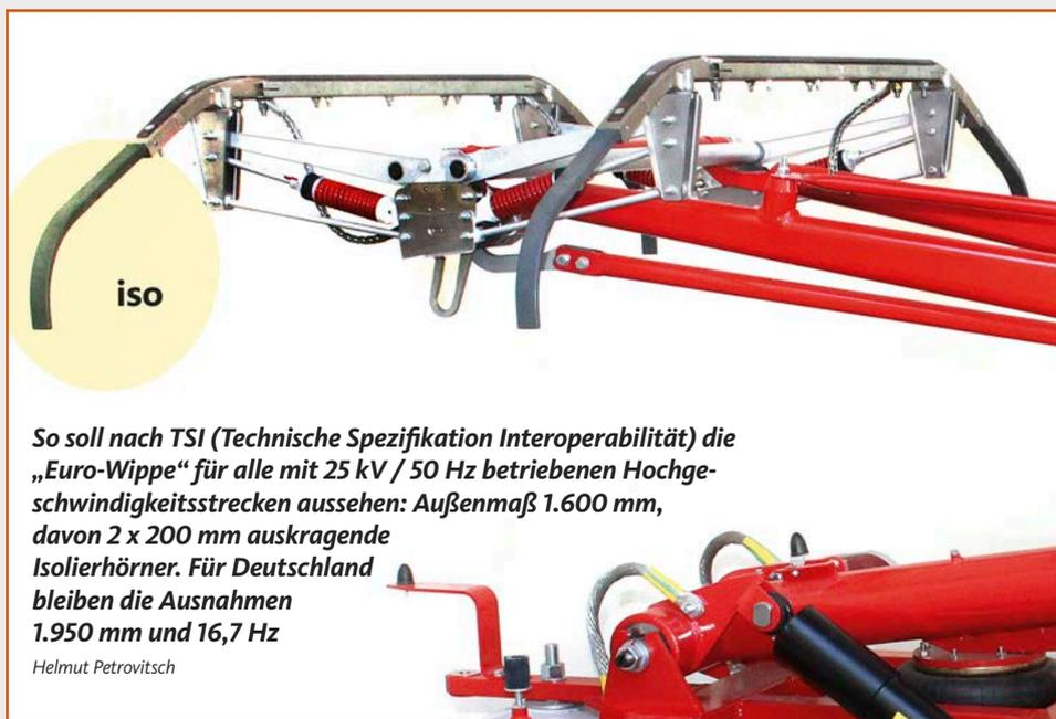
**So soll nach TSI (Technische Spezifikation Interoperabilität) die „Euro-Wippe“ für alle mit 25 kV / 50 Hz betriebenen Hochgeschwindigkeitsstrecken aussehen: Außenmaß 1.600 mm, davon 2 x 200 mm auskragende Isolierhörner. Für Deutschland bleiben die Ausnahmen 1.950 mm und 16,7 Hz**
