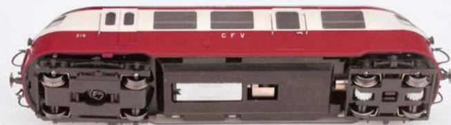
Angetrieben werden die beiden Radsätze des Drehgestells rechts, zwei Räder tragen Haftreifen. Der tief liegende Motor erlaubt einen von der Antriebseinheit freien Innenraum
