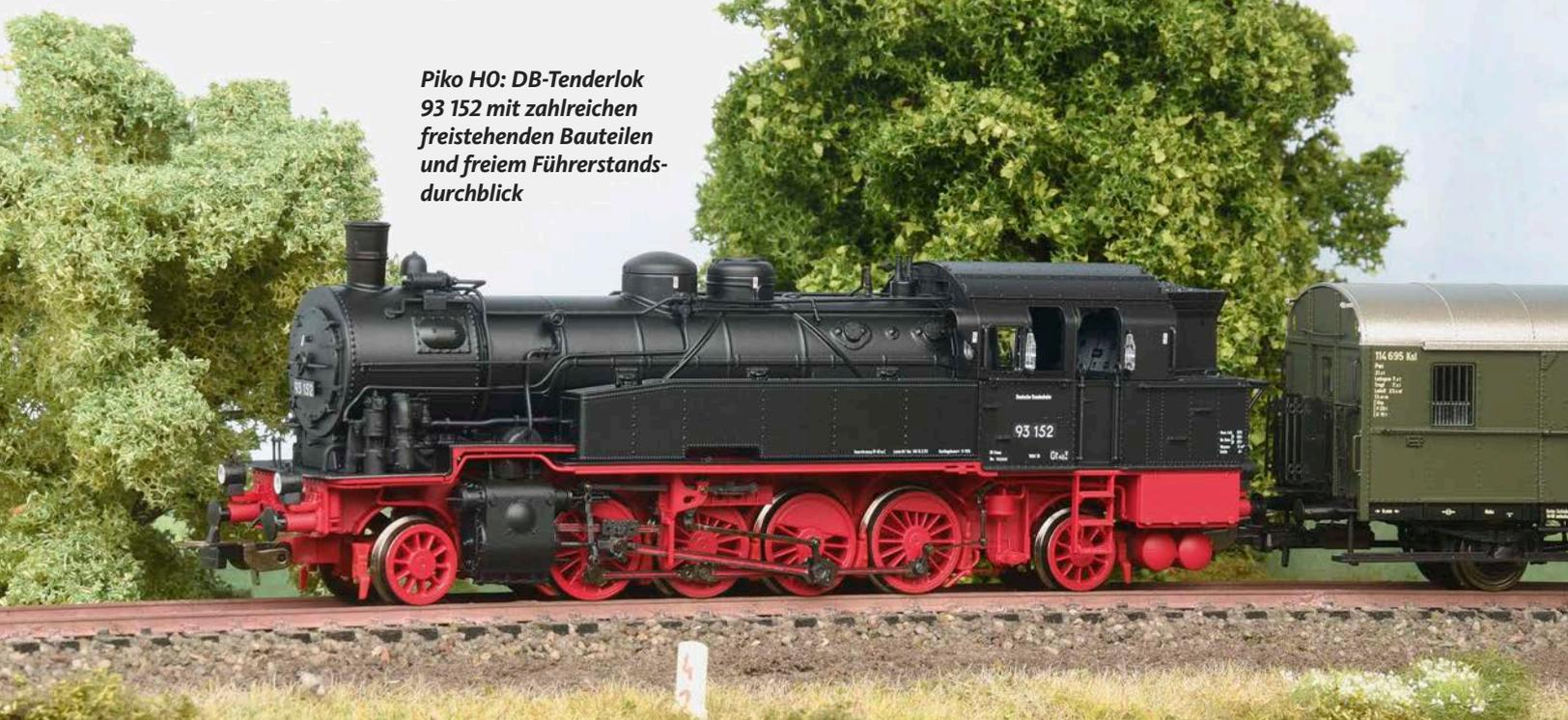
**A**us Sonneberg rollt mit der Neukonstruktion der preußischen Gattung T 14 eine interessante Heißdampf-Tenderlok an, die über mehrere Epochen in Deutschland, aber ebenso in Polen, Belgien und Österreich eingesetzt wurde. Zunächst waren die 65 km/h schnellen Maschinen in Deutschland nur für den Verkehr rund um Berlin vorgese-
