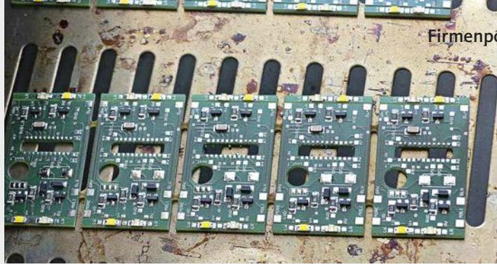
**Sogenannte Bestücknutzen (einzelne Platinen im noch unvereinzelten Zustand) liegen nach der Bestückung bereit, um im Infrarotofen gelötet zu werden**
