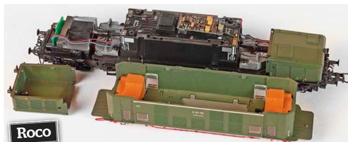
*Alle drei Modelle sind technisch fast gleich aufgebaut, bieten einen Mittelmotor mit zwei Schwungmassen und zeigen Kardanwellen zu den Triebgestellen. Auf den Zentralplatten ist die Digitaltechnik untergebracht*
