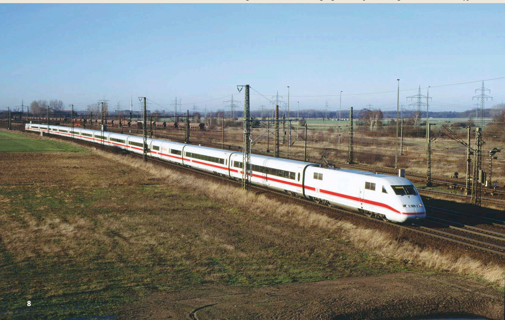
ICE 1 ohne Buckel? Nein, bei dieser am 1. Oktober 1998 bei Lehrte von 402 028 geführten Komposition handelt es sich wegen noch fehlender Steuer- wagen um einen ICE 2-Langzug mit zwölf Mittelwagen und zwei Triebköpfen
