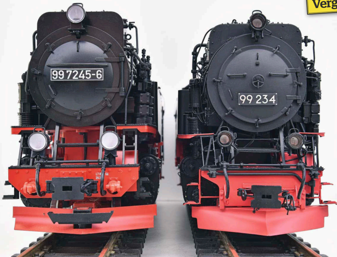
In der Frontansicht fällt auf, dass die links abgebildete LGB-Lok üppigere Kesselmaße hat und auch der Mischvorwärmer zu groß ausfällt
