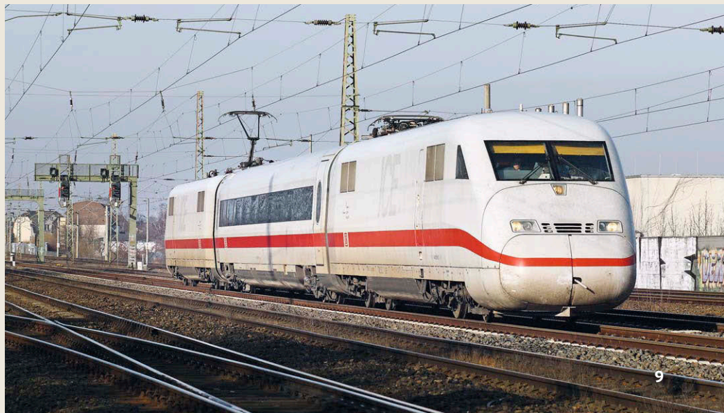
Abgeleitet vom ICE 2 entwickelte die Arbeitsgemeinschaft Siemens/Adtranz auch einen Nachfolger für den 1998 abgestellten ICE Experimental, den ICE-S. Mit nur einem Mittelwagen dient er inzwischen als Oberbau-Abnahmezug für Schnellfahrstrecken (Foto vom 9. März 2012 zwischen Letter und Hannover-Leinhausen)
