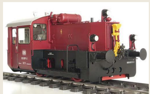
Die DB-Baureihe V 65 von Spur1-Exklusiv bekommt sogar Bremsbacken, die per Servo angelegt werden können
