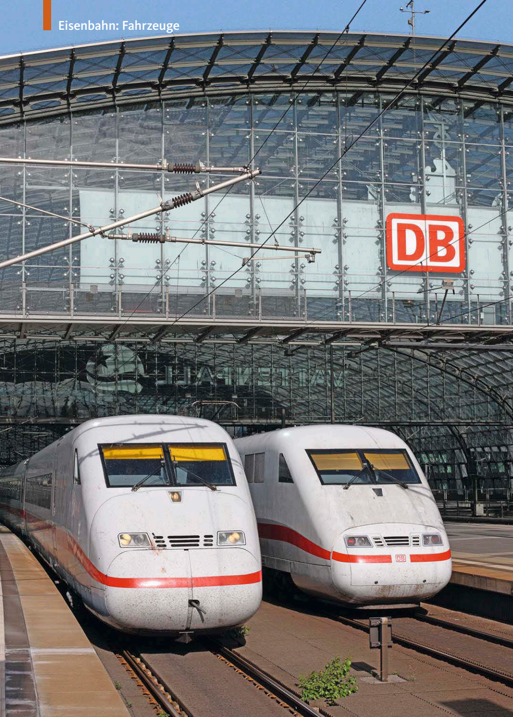
ICE 2 (links) trifft ICE 1 in Berlin Hbf am 8. Juli 2010: Die Fronten der Züge unterscheiden sich in einigen Details, darunter die Bugklappe des ICE 2 Alle Bilder: Jürgen Hörstel
