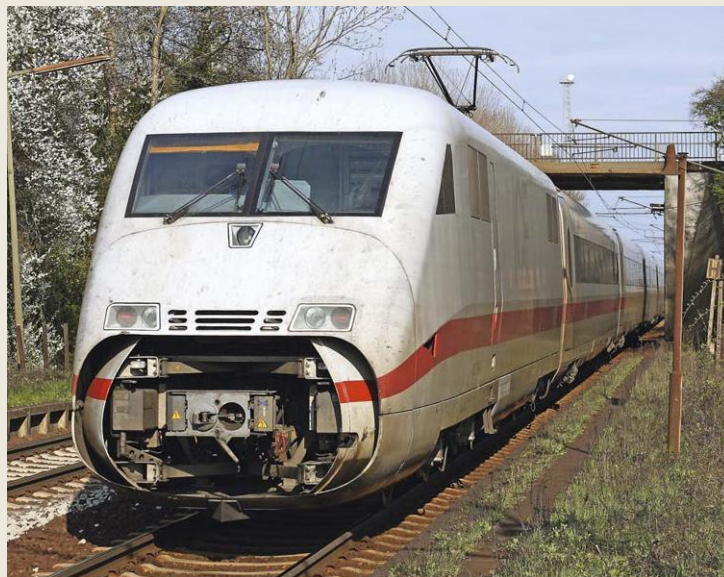
Abgeleitet vom ICE 2 entwickelte die Arbeitsgemeinschaft Siemens/Adtranz auch einen Nachfolger für den 1998 abgestellten ICE Experimental, den ICE-S. Mit nur einem Mittelwagen dient er inzwischen als Oberbau-Abnahmezug für Schnellfahrstrecken (Foto vom 9. März 2012 zwischen Letter und Hannover-Leinhausen)
