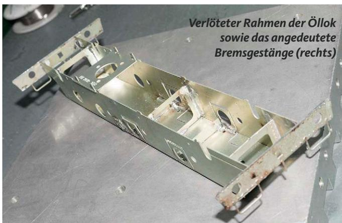
Verlöteter Rahmen der Öllok sowie das angedeutete Bremsgestänge (rechts)
