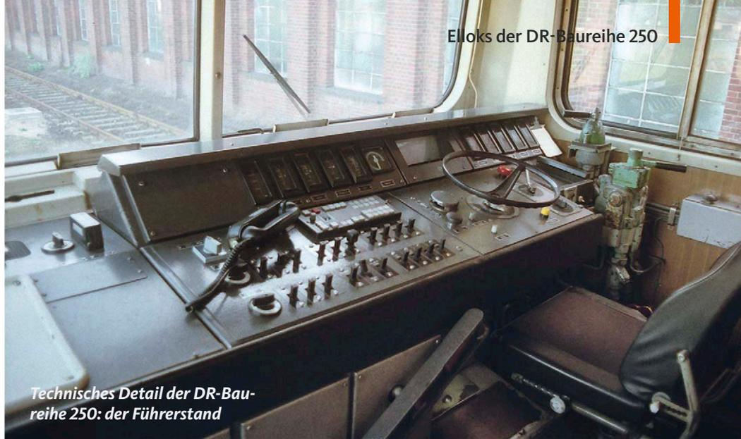
Technisches Detail der DR-Baureihe 250: der Führerstand
