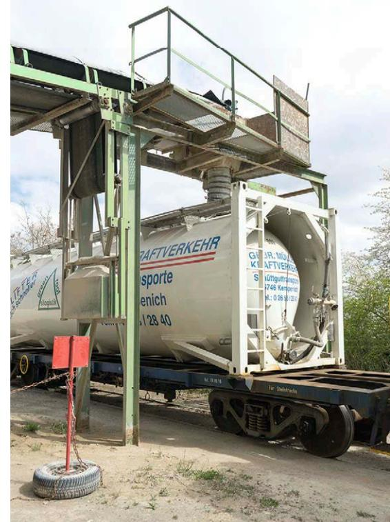
**Über ein Rollband rieselt das zermahlene Phonolith in die bereitgestellten 30-Tonnen-Container, die per Bahn abtransportiert werden**
