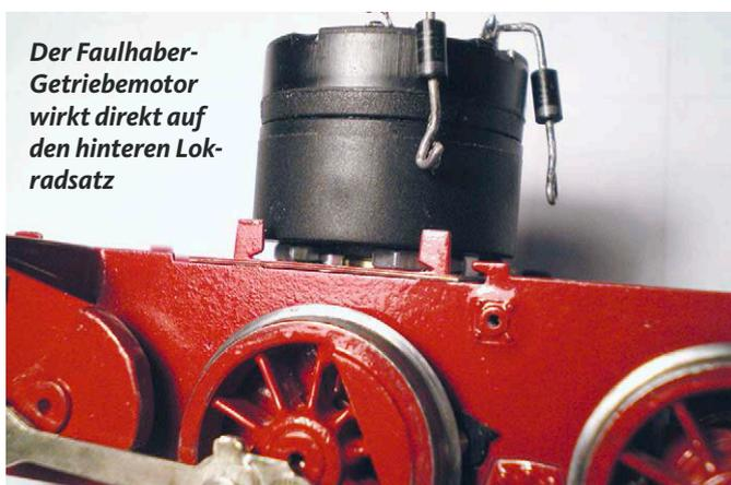
**Der Faulhaber-Getriebemotor wirkt direkt auf den hinteren Lokradsatz**
