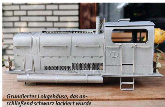
**Grundiertes Lokgehäuse, das anschließend schwarz lackiert wurde**
