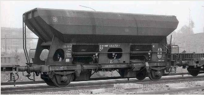
Der Fc 090 635 4 731 wurde im Oktober 1982 wohl als Schotterwagen in einer Gleisbaustelle in Hamburg-Wilhelmsburg eingesetzt. Gut zu sehen ist hier die nach außen gewanderte Aufstiegsleiter am Wagenkasten auf der bühnenabgewandten Seite als Vorbereitung zum Einbau der automatischen Kupplung (AK), wie sie auch das Märklin-Modell zeigt
