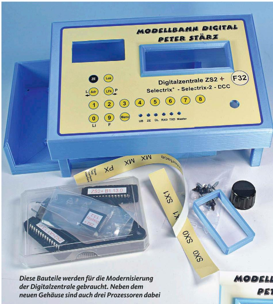
Diese Bauteile werden für die Modernisierung der Digitalzentrale gebraucht. Neben dem neuen Gehäuse sind auch drei Prozessoren dabei
