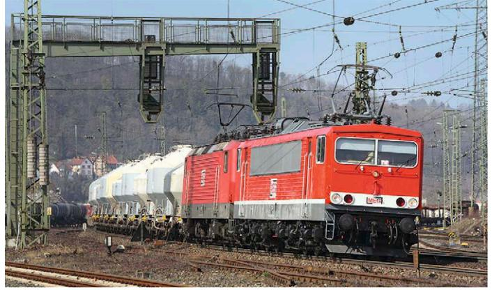
Bei der MEG wurden die 155er zum Teil traktionsfähig mit der 143 umgebaut und kamen als gemischtes Doppel zum Einsatz *Bahn im Bild/Leikra*
