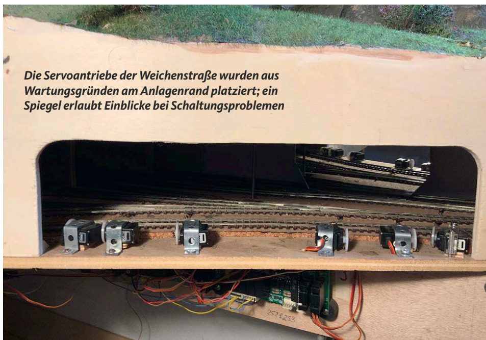
Unter einer Weichenstraße kann es sehr eng zugehen – ein Schattenbahnhof direkt darunter sollte deshalb vermieden werden, sonst werden Eingriffe für Wartungsarbeiten schwierig
