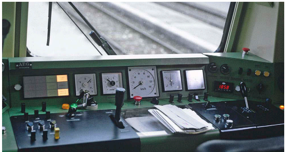
Blick in den Führerstand eines 5047. Auffällig ist die u-förmige Anordnung der Bedienelemente und der zentral platzierte Leistungsschalter des Fahrzeugs
