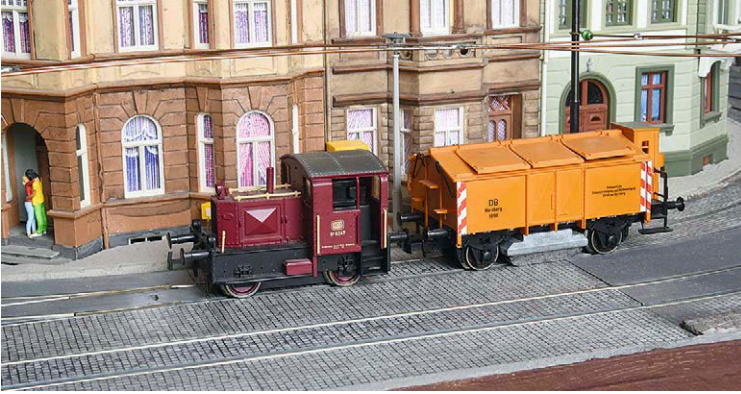
Der kurze Trix-Reinigungswagen und eine Kleinlok sind ideal für die Schienenreinigung auf den Straßenbahnstrecken mit engen Radien
