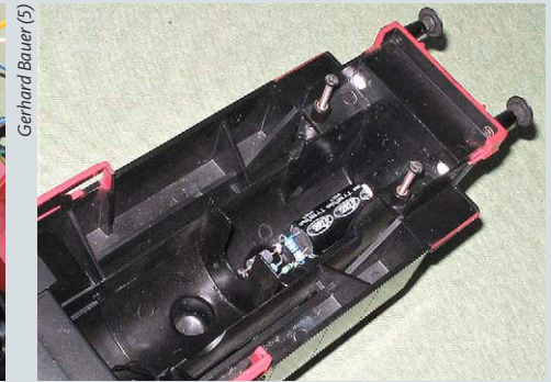
Lage des Pufferbausteins mit 10.000 µF Kapazität im Gehäuse der Tenderlokomotive
