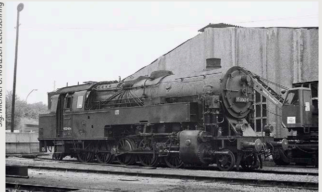
Mit Neubaukessel ohne Speisedom und mit Ölhauptfeuerung versehene 95 0040 im Jahre 1977 im Bw Sonneberg
