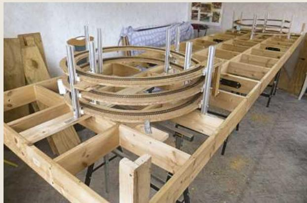
Anlagenrohbau mit den beiden H0m-Gleiswendeln zur Überwindung der Höhenunterschiede zwischen dem vorn liegenden Bahnhof (links) und dem gebirgigen Streckengleis im Anlagenhintergrund (rechts)
