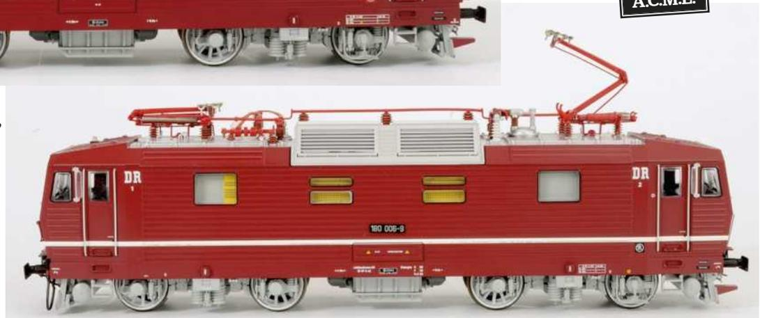
Seitenansicht des Piko-Modells in der DR-Ausführung von 1991. Sandfallrohre spielten bei der Modellkonstruktion Ende der 1990er-Jahre noch keine Rolle. Der Stromabnehmer entspricht der ersten Ausführung der Elloks. Die Farbgebung ist zu hell ausgefallen
