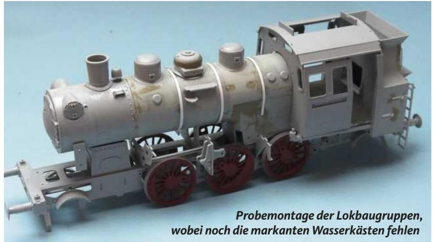
Probemontage der Lokbaugruppen, wobei noch die markanten Wasserkästen fehlen
