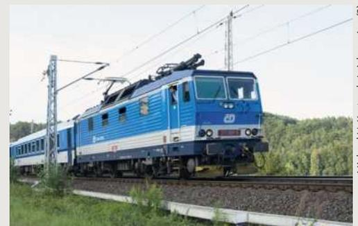
**Die CD ließ fünf Lokomotiven auf 160 km/h umbauen und reihte sie als Reihe 371 ein. Lok 001 „Lucka“ ist als A.C.M.E.-H0-Modell erhältlich**
