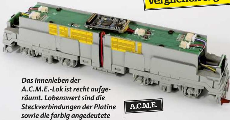
Das Innenleben der A.C.M.E.-Lok ist recht aufgeräumt. Lobenswert sind die Steckverbindungen der Platine sowie die farbig angeordnete Inneneinrichtung der Gangseite
