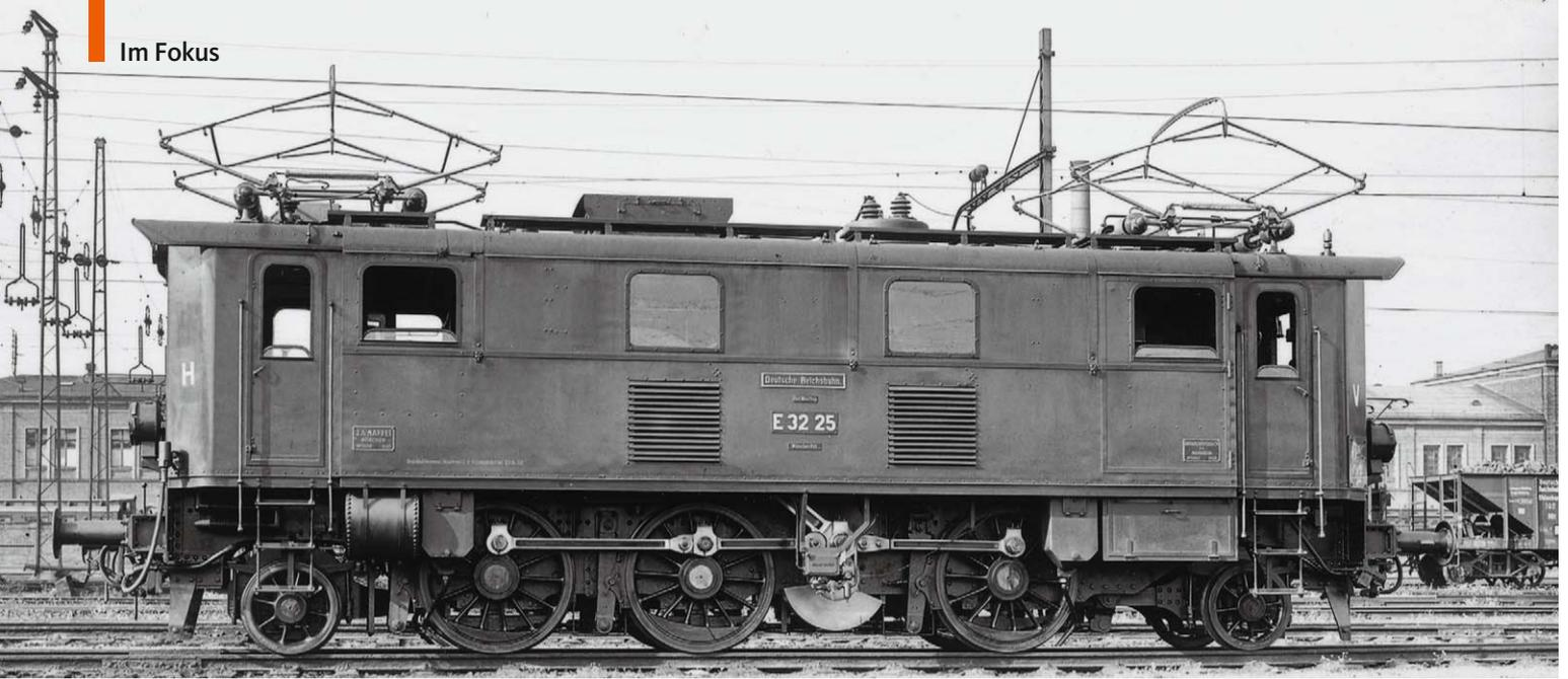
**Für alle EP 2/E 32 war das Bahnbetriebswerk München Hbf der Ort ihrer Erstbeheimung. Am 1932 entstandenen Typenfoto der E 32 25 sind sehr gut die Asymmetrie des Fahrwerks und die unterschiedliche technische Ausführung der Vorlaufgestelle zu sehen**
