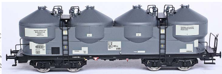
Brawa H0: Die vier Behälter des Uacs 946 der DB fassen im Original 58 m 3
