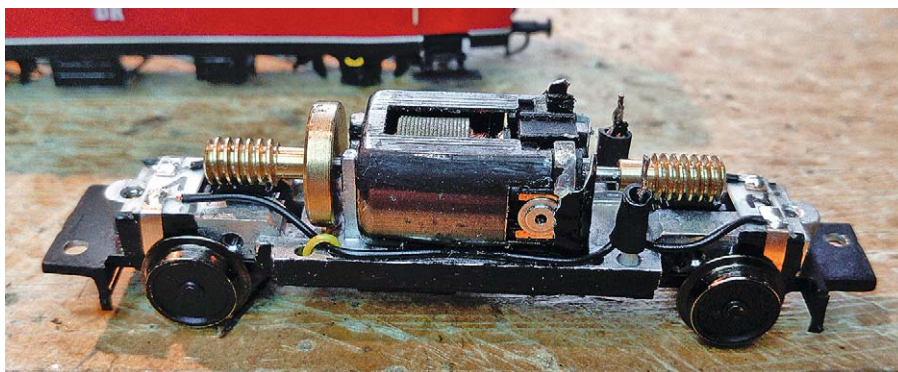
Als Fahrwerk dient das pmt-Chassis 62101, das den Maßen des VT angepasst wurde
