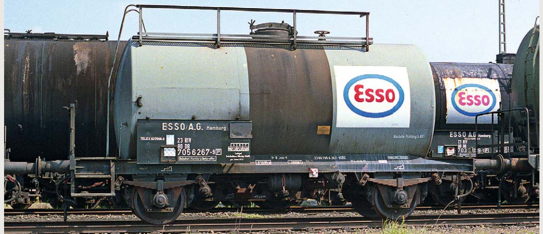
Der 1942 gebaute 705 6 267 [P] der Esso AG in Unterelbe-Seehafen; für die von Esso beschafften Wagen der Uerdinger Bauart typisch war der Dom mit einer lichten Weite von 600 Millimetern. Interessant ist auch die fehlende Ventilspindelhaube
