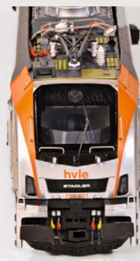
In jedem Drehgestell ist jeweils ein Rad mit Haftreifen ausgestattet. Ein Manko sind die sichtbaren Bleche für die Stromabnahme
