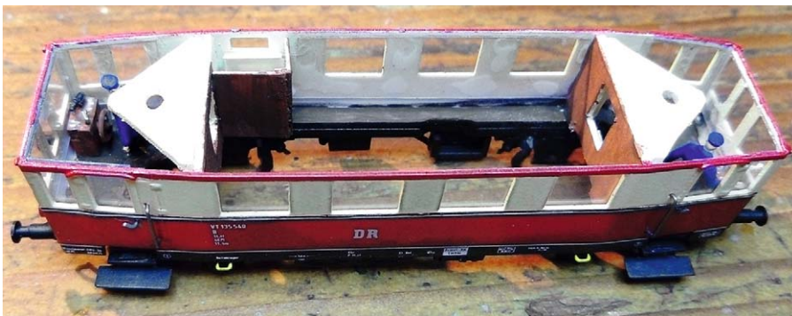
Im Fahrzeuginneren wurden Trennwände, Bedienpulte, Triebwagenführer und Zugbegleiter eingesetzt sowie außen alle Anschriften und Zierlinien aufgebracht
