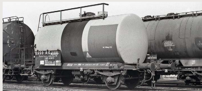
Der Wagen Uerdinger Bauart 705 6 260 [P] im Anstrichschema ab 1981, allerdings mit übermaltem Esso-Logo in seinem Hamburger Heimatbahnhof; Änderungen gegenüber dem Ablieferungszustand sind Rollenlagerradsätze, Signalstützen am Wagenende und die aus Blechstreifen bestehende zusätzliche Absturzicherung am Laufsteg
