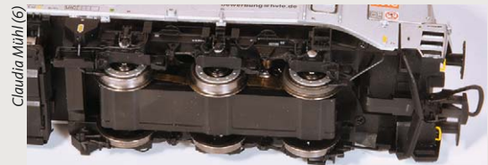
In jedem Drehgestell ist jeweils ein Rad mit Haftreifen ausgestattet. Ein Manko sind die sichtbaren Bleche für die Stromabnahme
