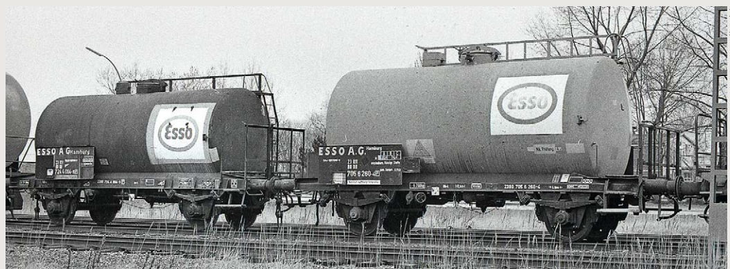
Der im Hamburger Bahnhof Unterelbe-Seehafen aufgenommene Güterwagen zeigt anschaulich die Unterschiede zwischen der Einheitsbauart mit 24-Kubikmeter-Kessel (links Wagen 724 4 004 [P]) und einem Wagen der Uerdinger Bauart (705 6 260 [P]) mit seinem 30-Kubikmeter-Kessel
