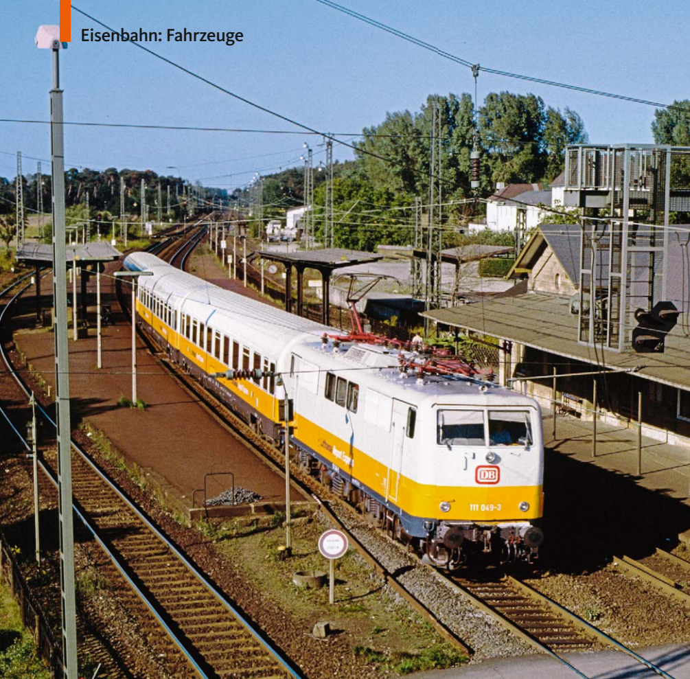
Die umlackierte 111 049 und vier umgebaute Avnz-Wagen wurden ab Mai 1990 auf der zweiten Lufthansa-Airport-Express-Linie zwischen Stuttgart und Frankfurt-Flughafen eingesetzt. Am 16. September 1990 rollt die Garnitur durch Bickenbach
