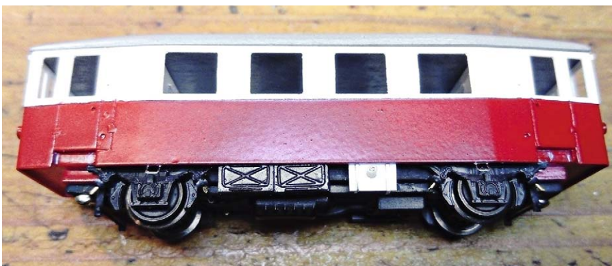
Das Fahrwerk wurde mit Achslagerblenden, Batteriekasten, Tank und Auspuff ergänzt sowie schwarz lackiert. Der Fahrzeugaufbau ist im klassischen DR-Rot/Beige gehalten
