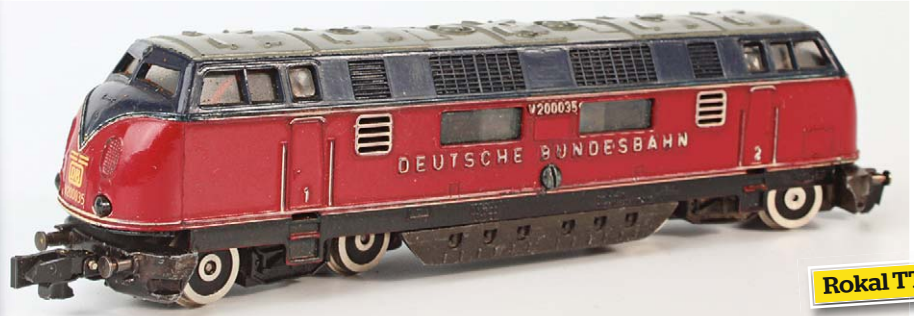
Die ab 1961 verfügbare überarbeitete Version mit neuem Motor ist äußerlich an den schwarz ausgelegten Rädern zu erkennen. Der Katalog 15 stellte den Sachverhalt allerdings umgekehrt dar
