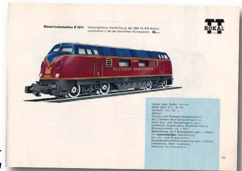
Rokals erste TT-Ausführung B 1014 – rechts abgebildet im Katalog mit der Nummer 13 – erkennt man an den blanken Radsätzen
