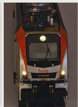
In jedem Drehgestell ist jeweils ein Rad mit Haftreifen ausgestattet. Ein Manko sind die sichtbaren Bleche für die Stromabnahme
