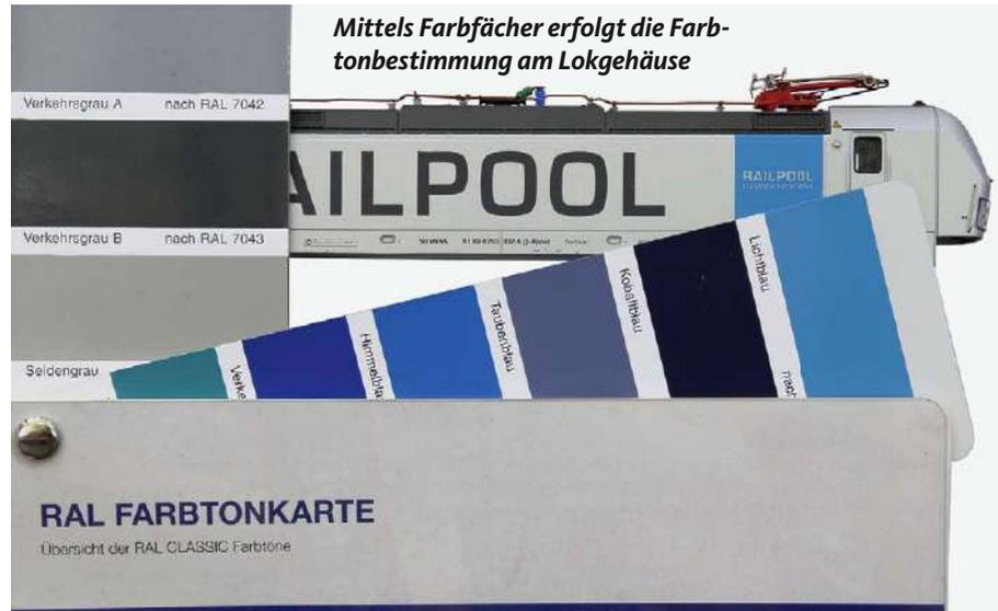
Mittels Farbfächer erfolgt die Farbtonbestimmung am Lokgehäuse
