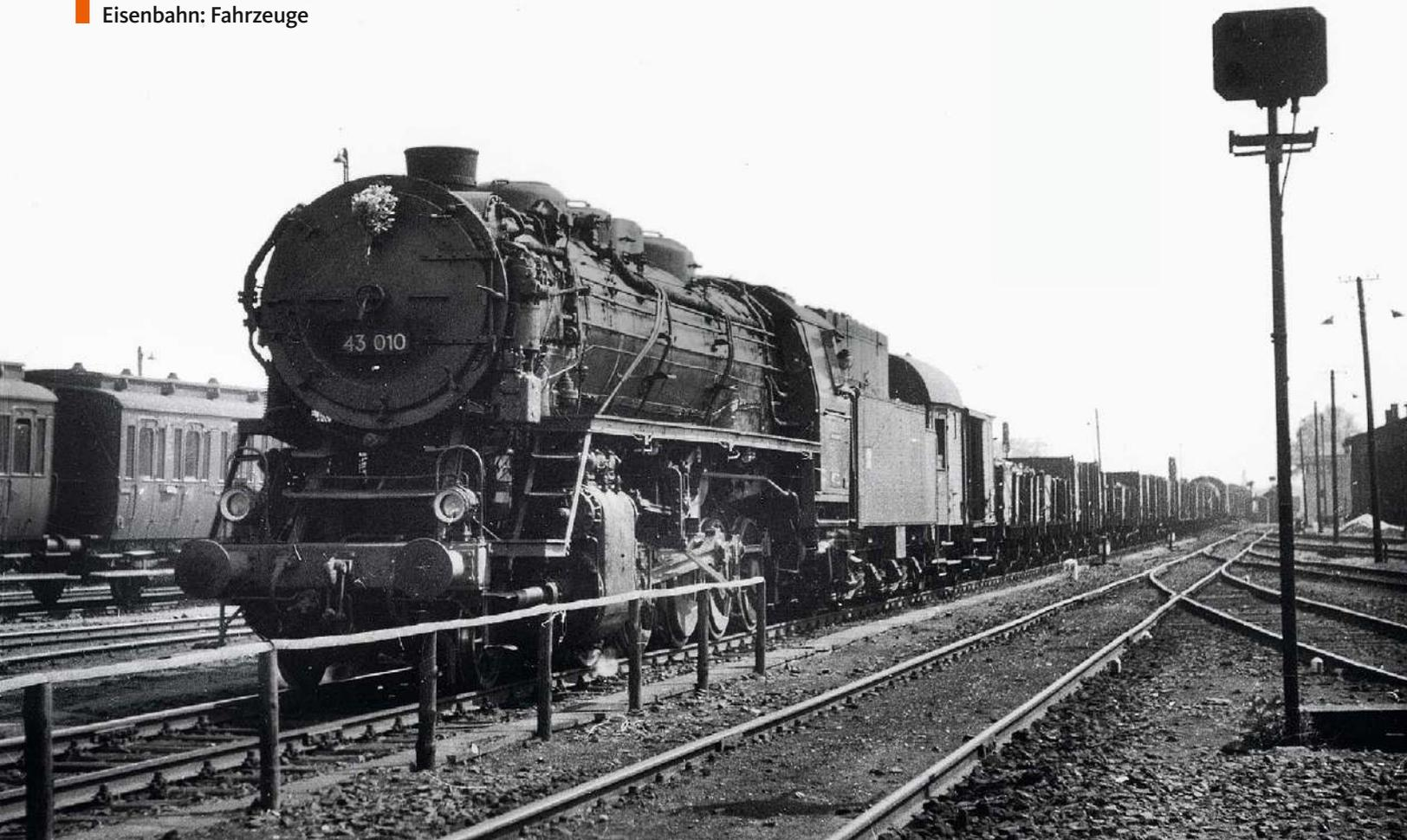
*Markant für die Baureihe 43 war die respektinflößende Front. Ende der 1950er-Jahre rollte 43 010 mit einem langen Durchgangsgüterzug durch Lübbenau. Erst am 7. November 1960 ordnete die Hauptverwaltung der Maschinenwirtschaft den Anbau kleiner Windleitbleche für die Baureihe 43 an*
