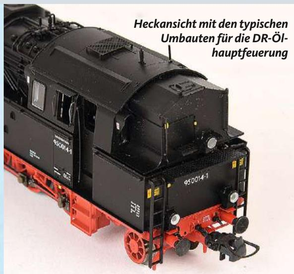
Heckansicht mit den typischen Umbauten für die DR-Ölhauptfeuerung
