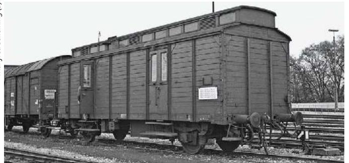
Dem Transport von Päckchen und Paketen diente der Post-c/10 mit Oberlichtdach; gut erkennbar ist das Bahnpost-Zuglaufschild
