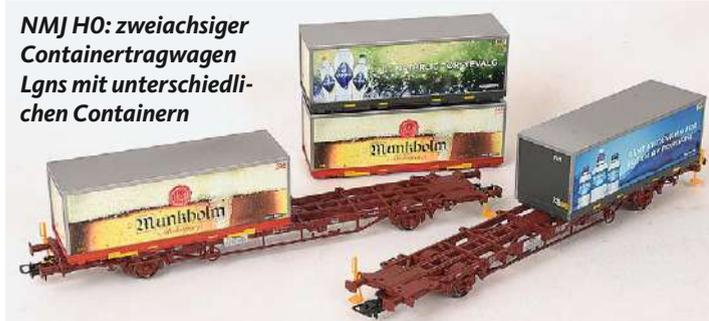
Mit der Güterwagengattung Lgjs/Lgns rollt aus Norwegen ein formneues Modell an, dessen Vorbilder ab 1978 zunächst von Talbot und später in Lizenz von Strommen in rund 500 Einheiten gebaut wurden. Die Fahrzeuge können je zwei 23- oder je einen 23- und 24- sowie nach einem Umbau auf geschweißte Pufferträger auch 25-Fuß-Container aufnehmen. Die je 69 Euro kostenden Modelle mit Metallfahrgestell gibt es vorwiegend mit mehrfarbig
