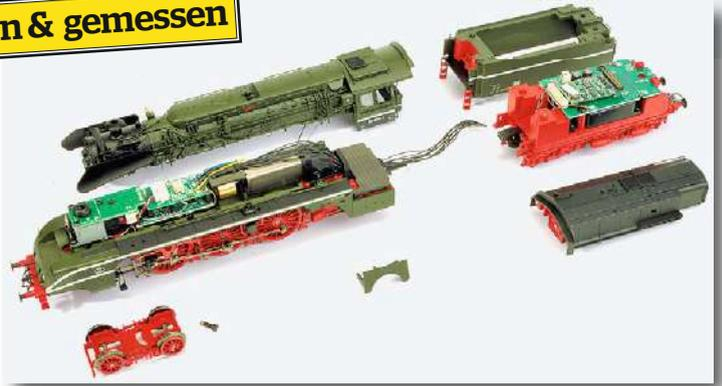
Um bei Trix Lok und Tender trennen zu können, müssen deren Gehäuse abgenommen werden. Erst dann ist der Verbindungsstecker lösbar. Betrieblich nötig ist das jedoch nur zum Nachrüsten von Lokpersonal, denn der Antrieb ist nahezu wartungsfrei, was auch für Märklin gilt
