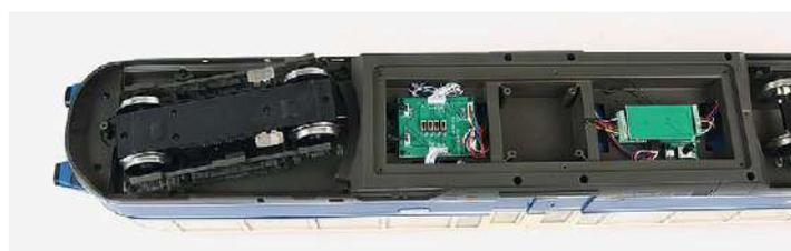
**Antriebsdrehgestell und leicht zugänglicher Technikbereich**
