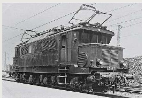
**E 244 11 verfügte über eine Hochspannungssteuerung im Hauptspanner (Foto von 1937)**
