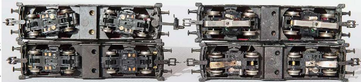
Die Fahrwerke weisen Unterschiede im Detail auf: Die Schleifer zum Betrieb auf Gleisen mit Mittelschiene bzw. Punktkontakten lagen den Packungen zum Anstecken bei
