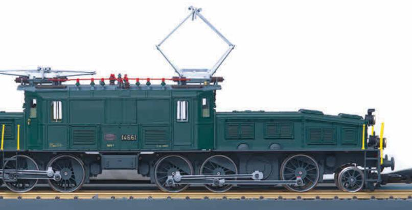
**Innolutions 2m/G: Das im 3D-Druck entstandene Gehäuse der 14 661 ist sauber lackiert**
