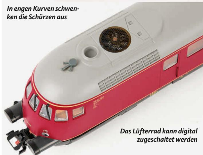
Das Lüfterrad kann digital zugeschaltet werden
