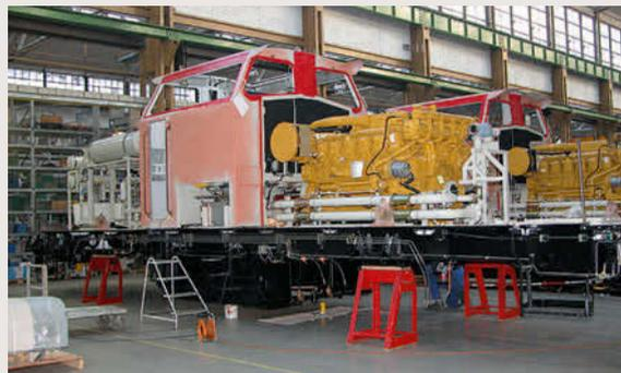
sierung und Einbau neuer Getriebe weitaus stärkere Loks als die Baureihe 204, denn die neue 203 verfügte nach dem Einbau von Caterpillar- oder MTU-Motoren und neuen Achsgetrieben über Leistungen bis zu 1.360 Kilowatt, was 1.850 PS und damit der Leistung beispielsweise der Bundesbahn-V 160 entspricht. Durch den Einbau neuer Fede-
