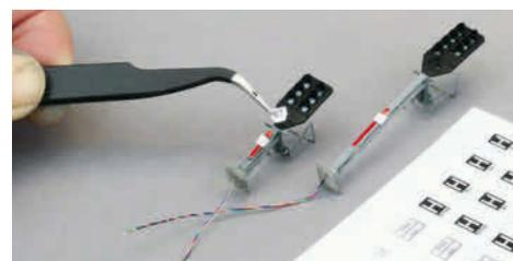
Die Sv-Signale von Oliver Boche werden mit Sekundenkleber montiert, alle hellen 3D-Druckteile mit Pinsel oder Airbrush lackiert, die Platinen mit den SMD-LED von Hand bestückt und die passenden Beschriftungen auf die Signalschirme und Masten geklebt
