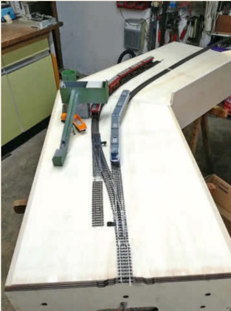
**Bild aus der Rohbauphase des Haltepunkt-Moduls samt Ausweichanschlussstelle; der Triebwagen markiert die Lage des Bahnsteiges. Jeder Segmentkasten misst in der Tiefe 50 Zentimeter und in der Länge vorn 73 und hinten 95 Zentimeter. Die Stirnseiten entsprechen der FREMO-Norm E 96**
