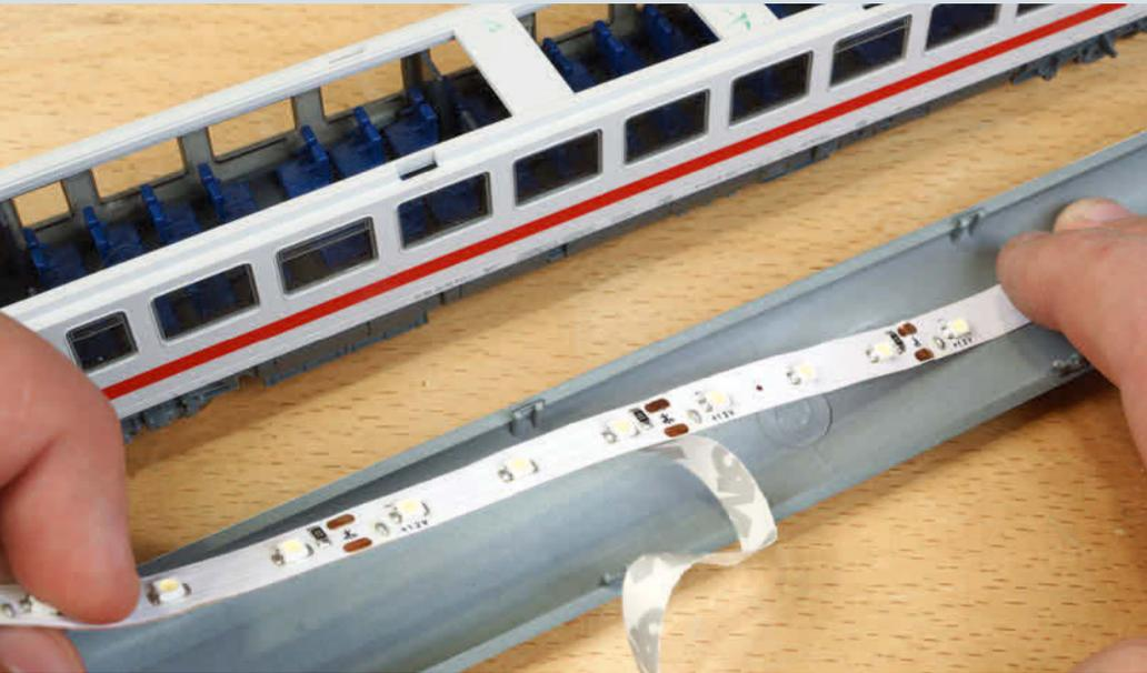
Da die LED-Stripes auf der Rückseite mit einer Klebstoffschicht versehen sind, lassen sie sich einfach unter dem Wagendach eines Personenwagens anbringen. Immer drei LED teilen sich technisch eine Spannung von acht Volt und leuchten den Fahrgastraum durchaus vorbildnah aus
