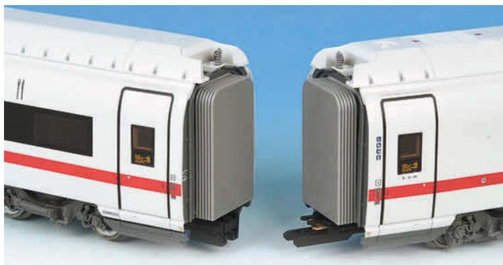
Roco HO: stromführende und mechanische Kupplung
