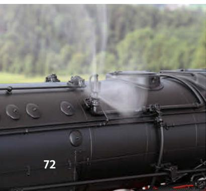
*Die Umsteuerung wird bei einem Fahrtrichtungswechsel der Lok servomotorisch in Bewegung gesetzt*
