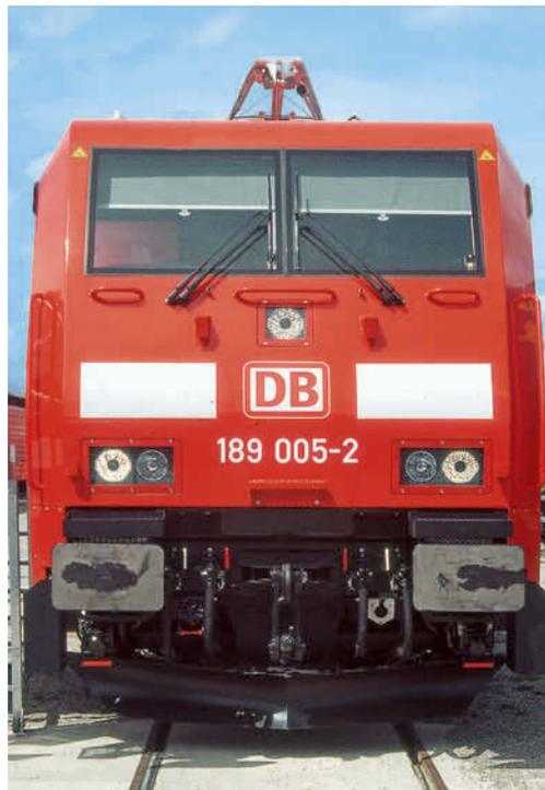
Die 189 trägt wie alle neuen DB AG-Loks im Dreieckssignal mit mäßiger Intensität LED-Flächenleuchten, unten innen liegend dazu konventionelle Halogen-Scheinwerfer
