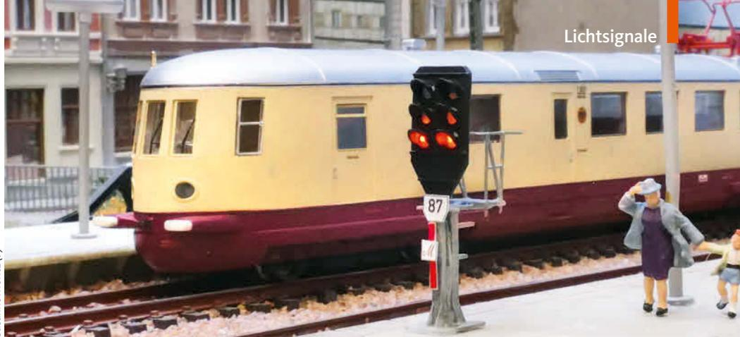
Ab der Epoche II wurden selbsttätig gestellte Lichttagessignale aufgestellt. Hier ein Sv-Signal in der Stellung Sv 3 mit den Signalbegriffen „Halt“ und „Weiterfahrt auf Sicht“. Die niedrige Bauform kam vermehrt auf Bahnsteigen zum Einsatz
