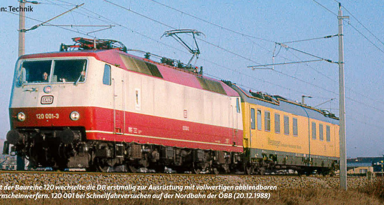
Mit der Baureihe 120 wechselte die DB erstmalig zur Ausrüstung mit vollwertigen abblendbaren Fernscheinwerfern. 120 001 bei Schnellfahrversuchen auf der Nordbahn der ÖBB (20.12.1988)
