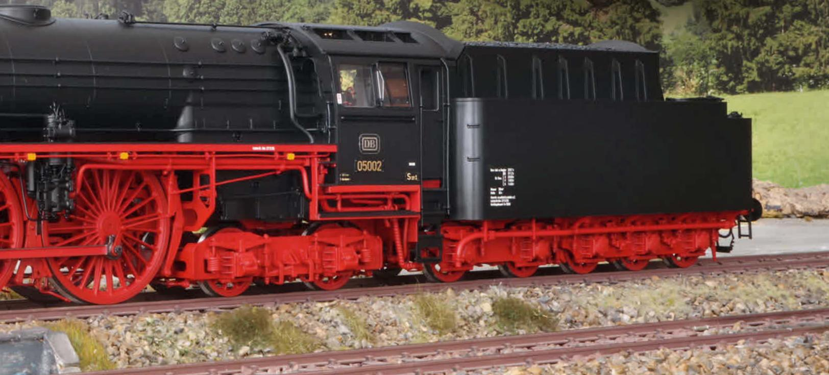
kann das Modell einfache Gleisbögen ab 1.176 Millimetern durchfahren und Gegenbögen oder Gegenweichen ab einem Radius von 1.394 Millimetern.
