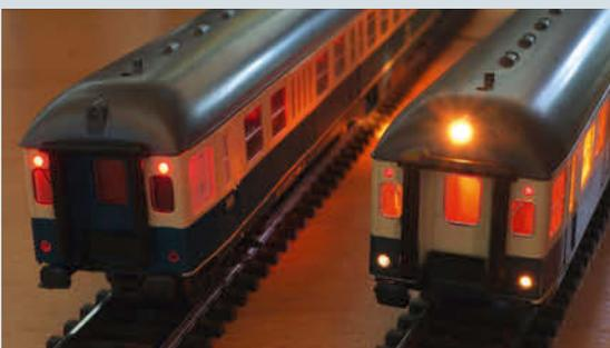
Die drei separat nutzbaren Funktionsausgänge erlauben bei Tams neben der Innenbeleuchtung auch den Anschluss von weiteren LED – etwa für ein schaltbares Zugschlussignal oder, wie hier, die Steuerwagen-Frontbeleuchtung. Auch ein schaltbarer weiß/roter Lichtwechsel wäre denkbar
