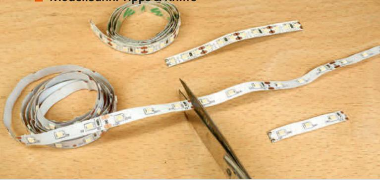
Die LED-Bänder des Ingenieurbüros Duncker werden in unterschiedlichen Ausführungen sowie in Kalt- und Warmweiß angeboten. Jeweils drei LED bilden einen Block, sodass sich ein längerer Streifen alle zweieinhalb oder fünf Zentimeter mit der Schere kürzen lässt
