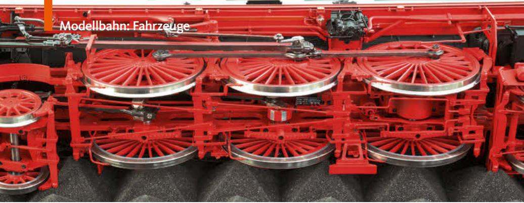
Das Mitteltriebwerk der Dreizylinderlokomotive wurde authentisch nachgebildet. Direkt vom Motor über ein Getriebe in Bewegung gesetzt wird lediglich der letzte Kuppelradsatz
