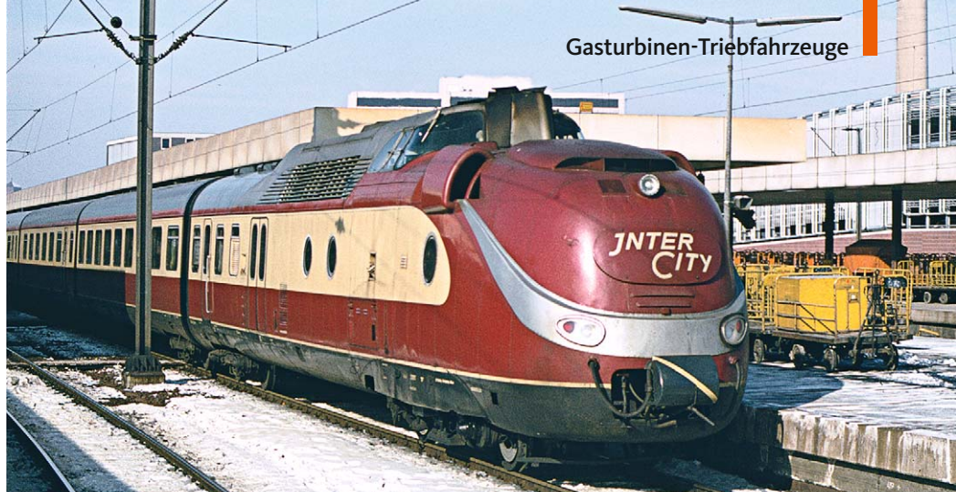
Die Bundesbahn-Baureihe 602 gehört zu den populärsten deutschen Vertretern in puncto Turbinentriebfahrzeuge. Am 21. Februar 1978 wartet der als InterCity verkehrende Triebzug in Hannover Hauptbahnhof auf den Abfahrtsbefehl
