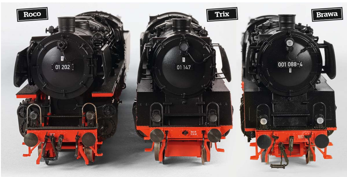
Lokfrontansichten der drei 01-Kontrahenten in der DB-Version, wobei speziell Brawa und Roco hinsichtlich der zahlreichen Anbauteile punkten können; bei Trix stört der zu hoch angeordnete Pufferträger
