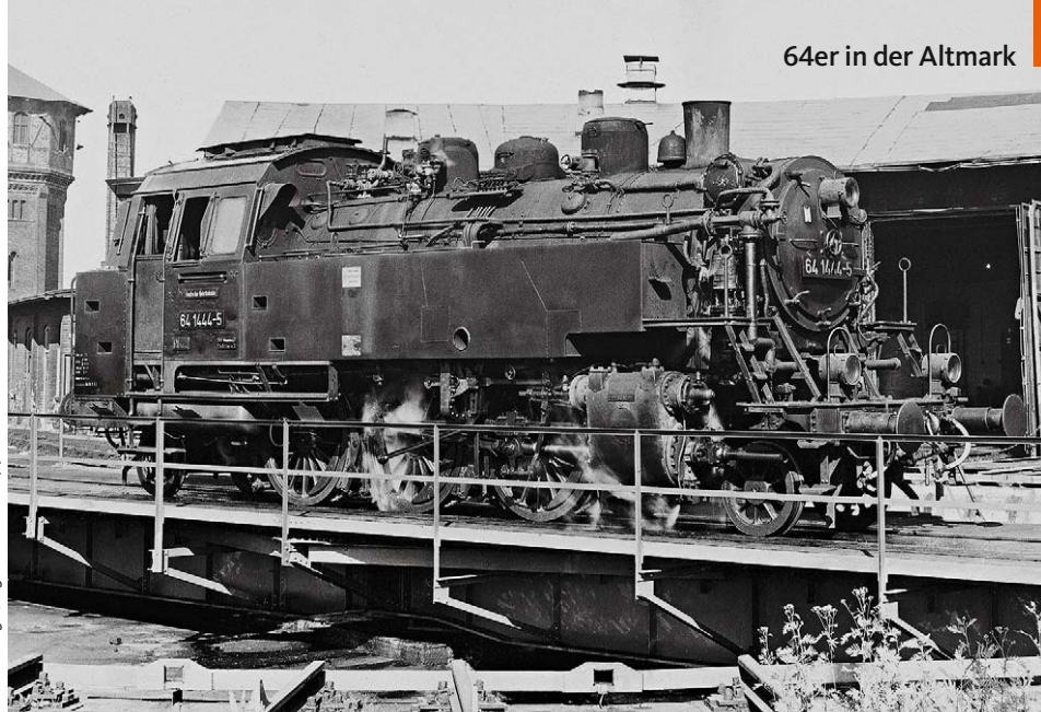
Im September 1973 steht 64 1444 auf der Drehscheibe ihrer Heimatdienststelle. Gut sind die für Salzwedler 64er typischen Rohrleitungen der Elevator-Einrichtung zu sehen
