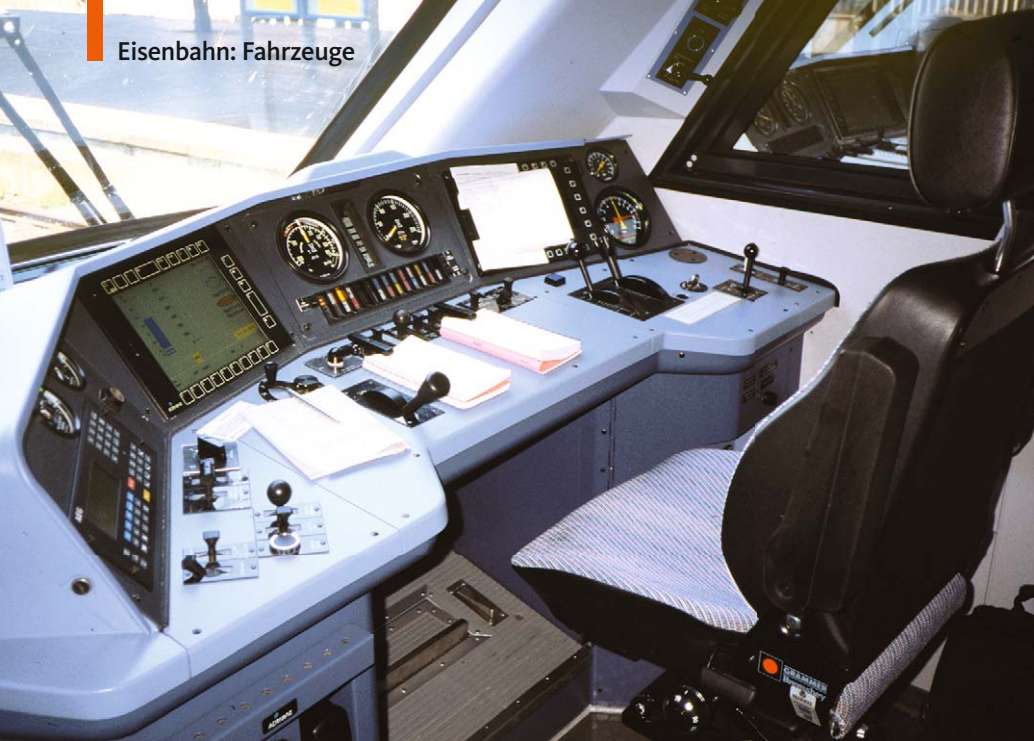
Blick in den Führerraum eines MET-Steuerwagens, der in seiner Ausführung weitgehend den damaligen IC- und IR-Steuerwagen entsprach (Hamburg, Juli 1999)
