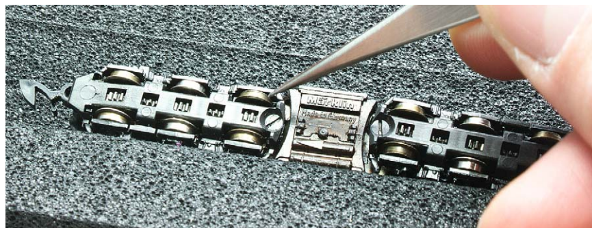
Änderungen in den Drehgestellen mit ergänzten Haftreifen-Radsätzen
