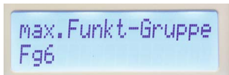
Die Anzahl maximal nutzbarer Funktionsgruppen lässt sich konfigurieren, um Fehlbedienungen beim Fahren zu vermeiden
