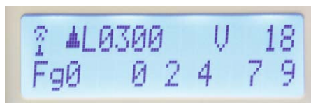
Displayanzeigen mit Funkanzeige und Batteriesymbol links, daneben die Adresse 0300 mit Fahrstufe 18; in der unteren Zeile wird links die Funktionsgruppe 0 angezeigt, in der die Funktionen 0, 2, 4, 7 und 9 aktiviert sind. In den weiteren Funktionsgruppen Fg 0 bis 6 sind jeweils zehn zusätzliche Funktionen erreichbar
