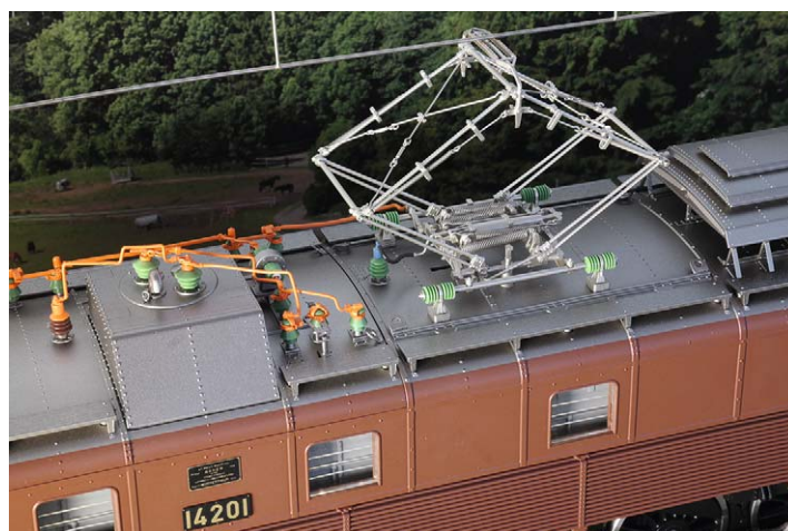
Dachdetailansicht mit feinen Isolatoren, Leitungen und Pantografen
