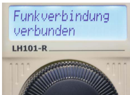
Die Anmeldung des Funkhandreglers am LTM101-R erfolgt recht schnell
