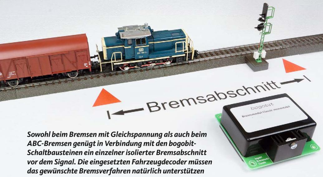
Sowohl beim Bremsen mit Gleichspannung als auch beim ABC-Bremsen genügt in Verbindung mit den bogobit-Schaltbausteinen ein einzelner isolierter Bremsabschnitt vor dem Signal. Die eingesetzten Fahrzeugdecoder müssen das gewünschte Bremsverfahren natürlich unterstützen
