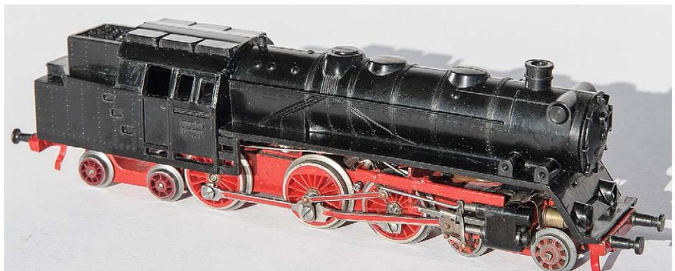
**Das Gehäuse der HO-Lok von MEB Modelleisenbahn-Bergfelde ist neuwertig. Die Windleitbleche wurden nie montiert, die Original-Treibräder durch Kunststoffnachfertigungen ersetzt**
