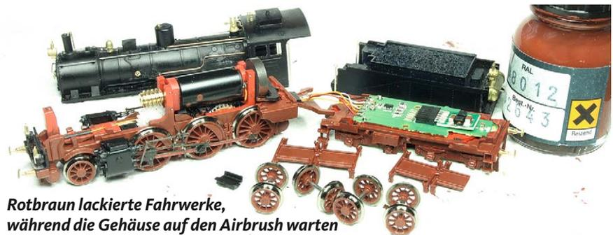
**Rotbraun lackierte Fahrwerke, während die Gehäuse auf den Airbrush warten**
