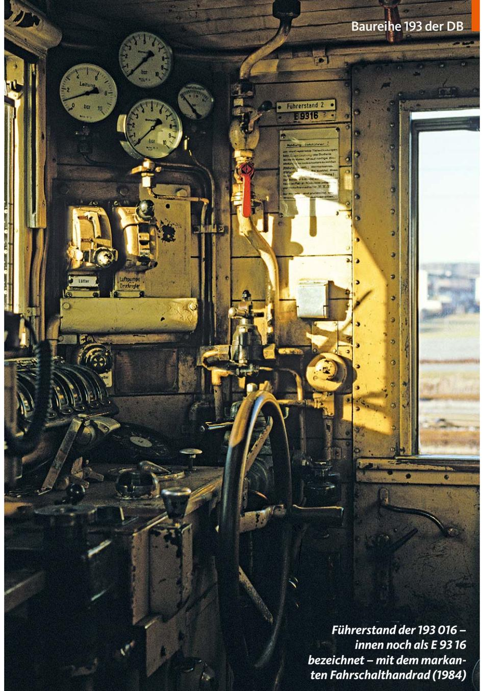
*Führerstand der 193 016 – innen noch als E 93 16 bezeichnet – mit dem markanten Fahrschaltheandrad (1984)*
