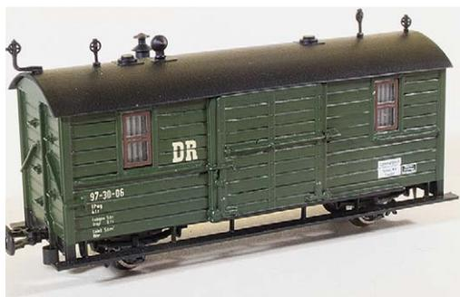
Ork[u]-01/290 €) und ohne Bremserhaus (-02/250 €) sowie entsprechend unterschiedlichen Seitenwänden bzw. Türanordnungen angeboten. Neben 3D-Druckteilen fanden Achsbrücken, -lager und andere Details aus Messing Verwendung. Um die Wagen zu beschweren, ist die Kohleimitation auf einen Bleieinsatz geklebt. *GF*
