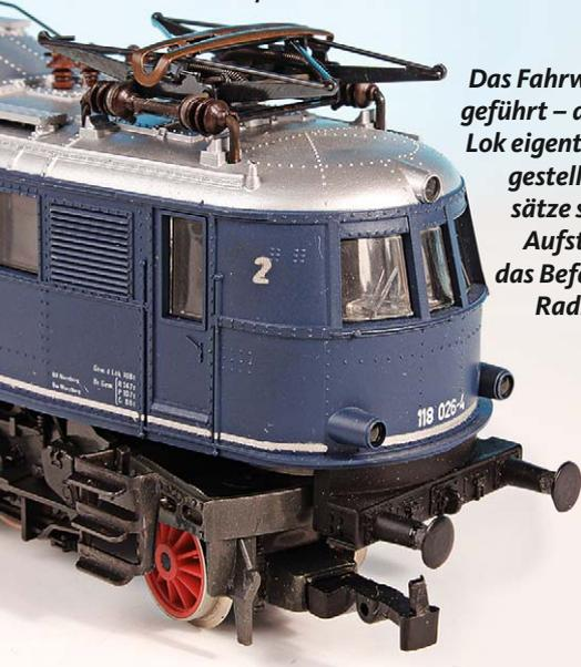
Das Fahrwerk war beweglich ausgeführt – das machte aus der 1'D1'-Lok eigentlich eine doppelte Drehgestelllok. Die Vorlaufgradsätze schwenken samt der Aufstiegstritte aus, was das Befahren auch enger Radien ermöglicht
