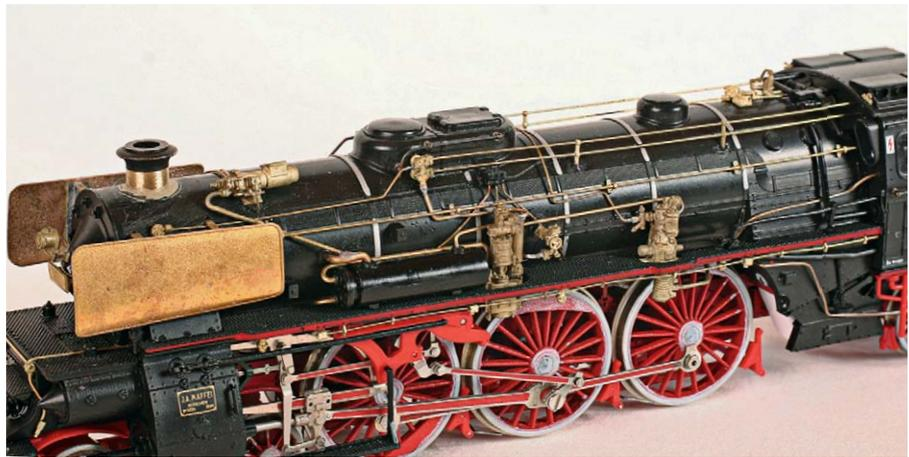
**Die meisten Leitungen, Pumpen und Armaturen der Liliput-Lok wurden durch Messing-Bauteile ersetzt**
