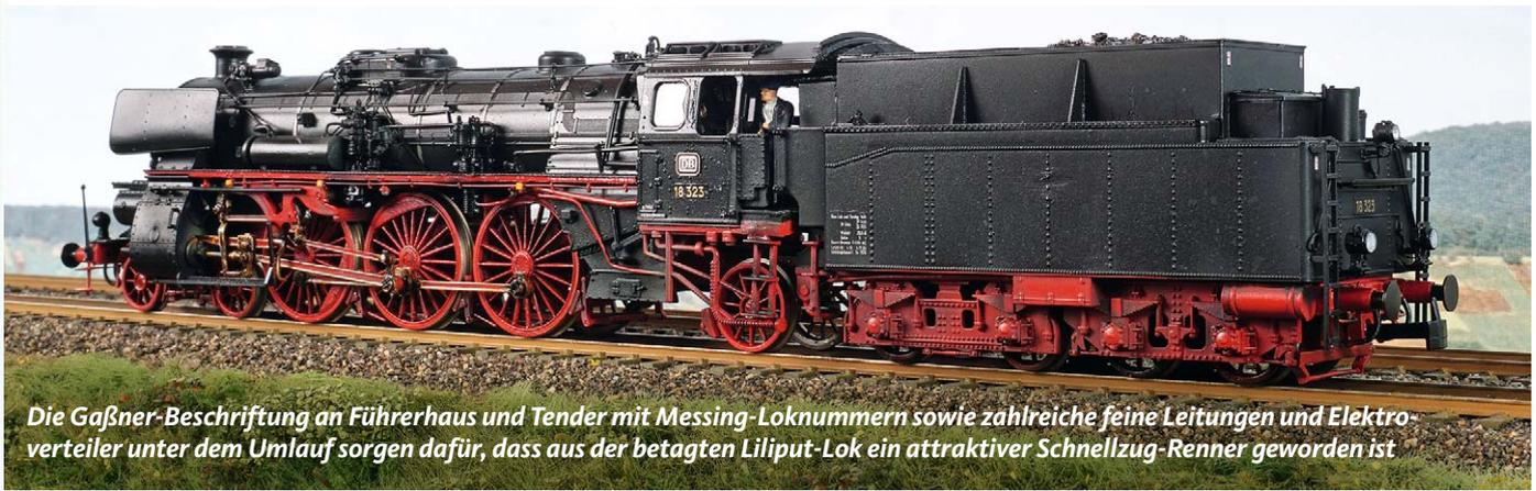
Die Gaßner-Beschriftung an Führerhaus und Tender mit Messing-Loknummern sowie zahlreiche feine Leitungen und Elektroverteiler unter dem Umlauf sorgen dafür, dass aus der betagten Liliput-Lok ein attraktiver Schnellzug-Renner geworden ist
