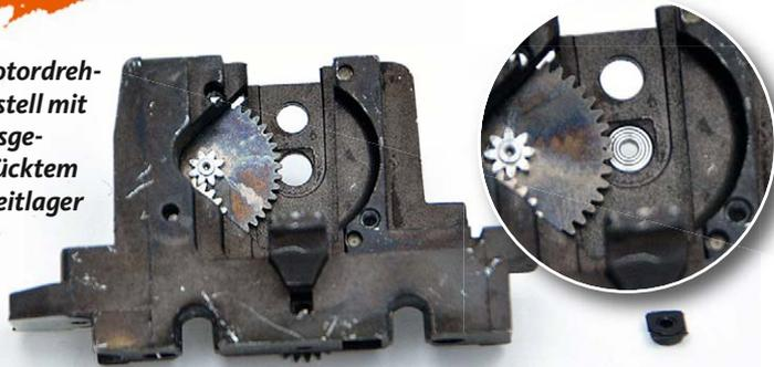
**Das neue Kugellager wurde mit leichtem Druck eingesetzt**
