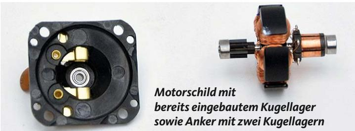
**Motorschild mit bereits eingebautem Kugellager sowie Anker mit zwei Kugellagern**
