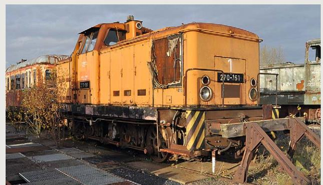
Im November 2014 aufgenommene MaLoWa-Werklok, die der Reichsbahn-V 60 bzw. 106 der ersten Bauserie entspricht
