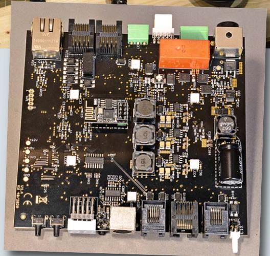
Im Gerät sorgt ein 32-Bit-Prozessor mit ARM-Architektur für die Funktionalität der mc<sup>2</sup>
