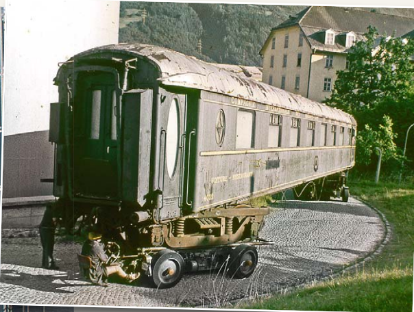
Im Sommer 1986 im österreichischen Telfs fotografierter Straßenroller mit handgelenktem Nachläufer für den Transport eines Salonwagens. Die abgebildete ÖBB-Zugmaschine des Typs ÖAF/MAN 16.192 gab es übrigens mit Einzelkabine 2016 als Wiking-H0-Modell (0590 03)
