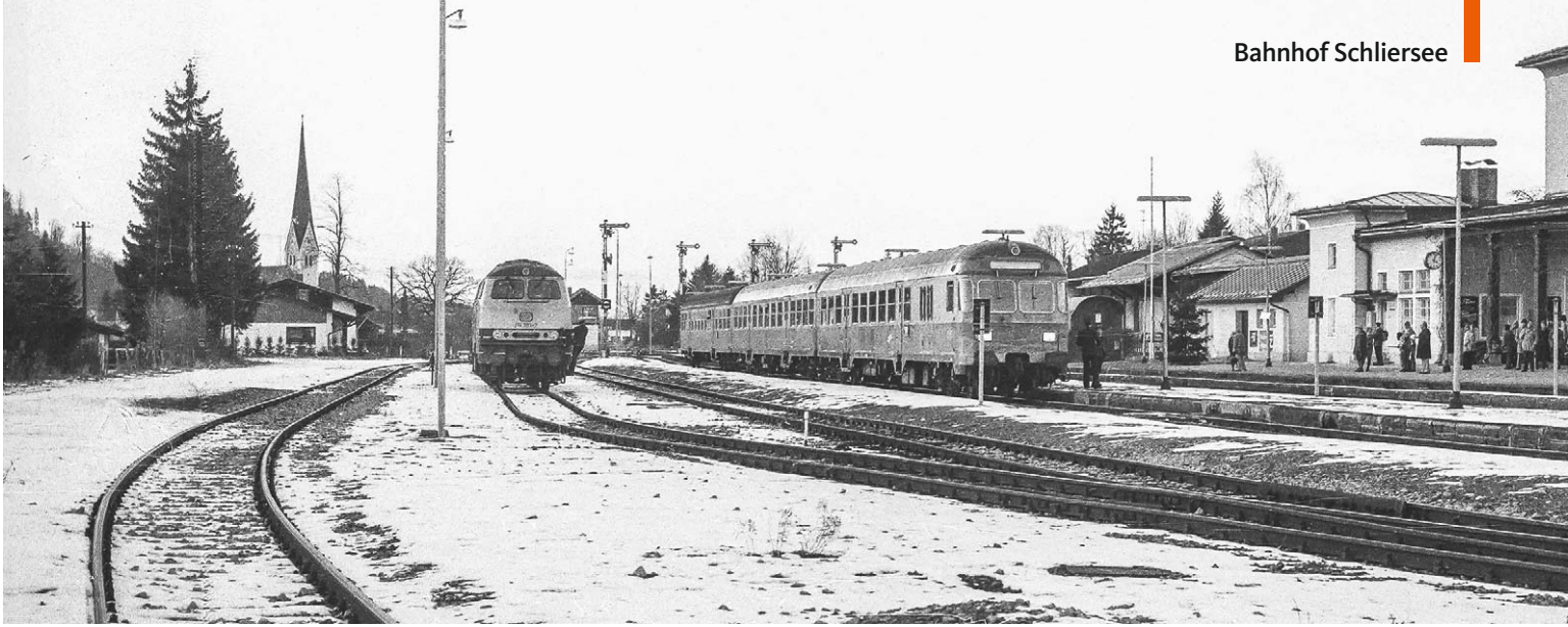
Ende der 1970er-Jahre verkehren hauptsächlich Wendezüge im Oberland. Nur wenn ein Steuerwagen untauglich war, musste die Lok in Schliersee umsetzen. Einen solchen Fall zeigt das Bild aus dem Jahr 1979, auf dem eine Lok der Baureihe 218 ihren Zug über Gleis 5 umfährt
