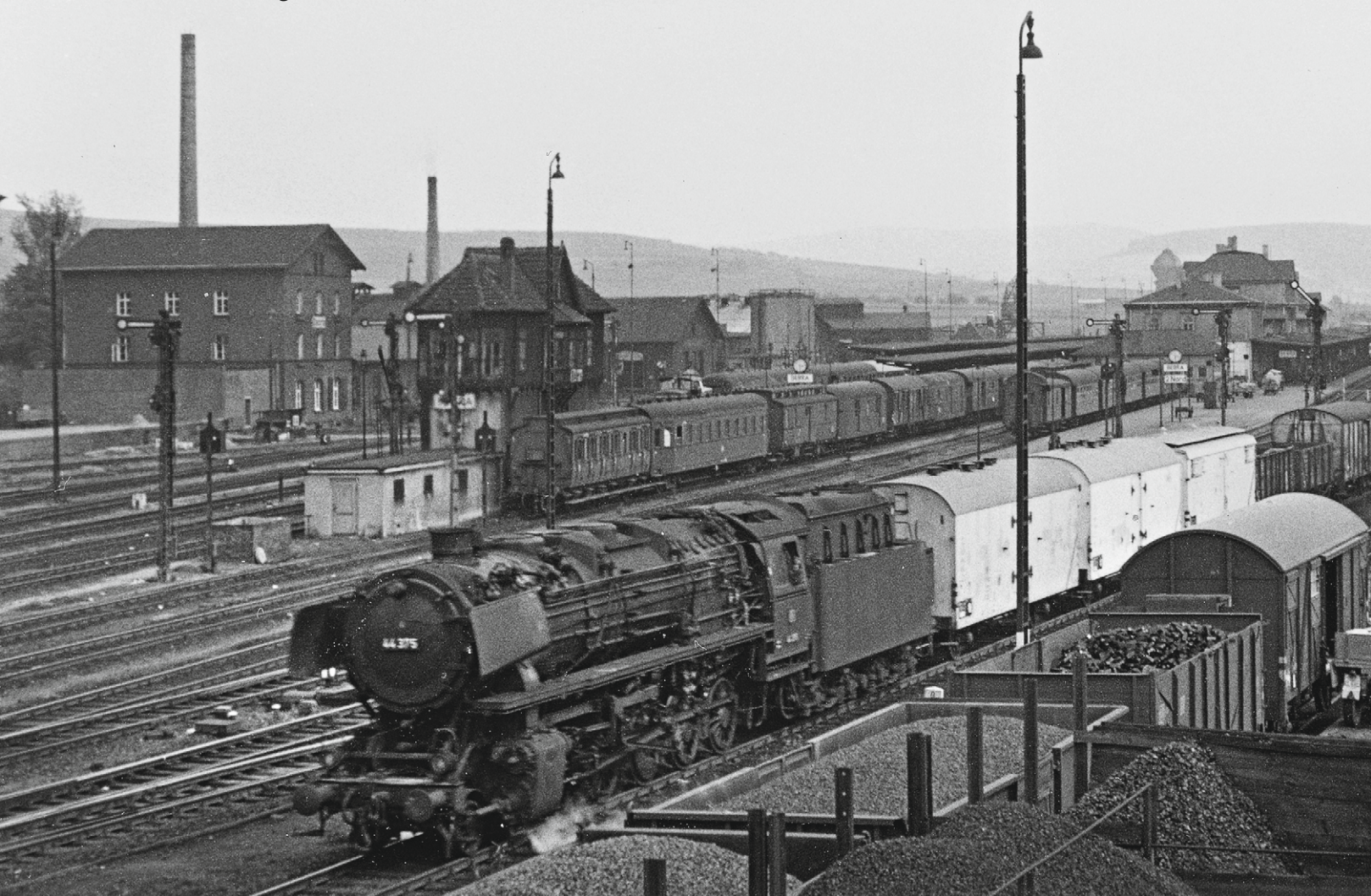
Paradeleistung „Langer Heinrich“: Mit einem schweren Erzzug kommt 043 196 zusammen mit einer Schwestermaschine am 28. August 1974 durch Lingen. Die Zuglok hatte erst ein Jahr zuvor eine Ölhauptfeuerung im AW Braunschweig erhalten
