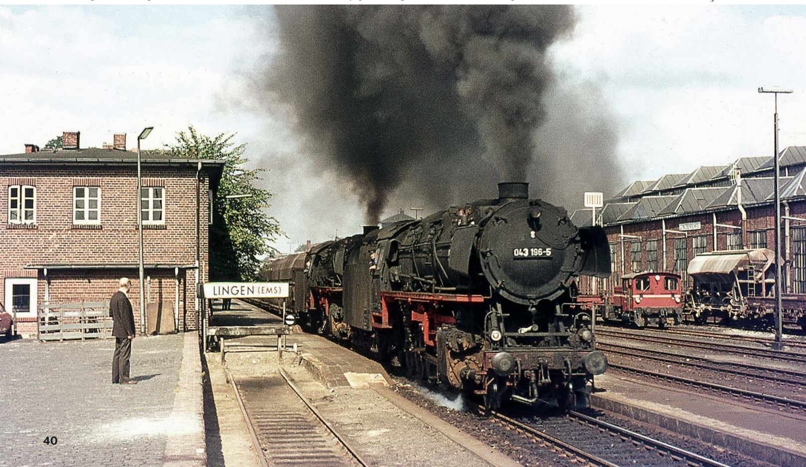
Paradeleistung „Langer Heinrich“: Mit einem schweren Erzzug kommt 043 196 zusammen mit einer Schwestermaschine am 28. August 1974 durch Lingen. Die Zuglok hatte erst ein Jahr zuvor eine Ölhauptfeuerung im AW Braunschweig erhalten
