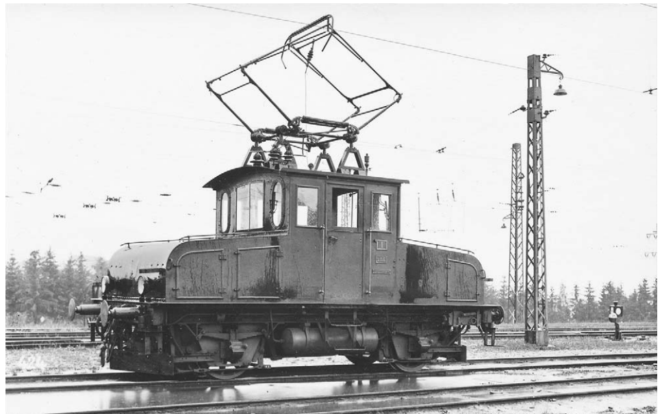
Die LAG 1 war 1906 nicht nur die erstbeschaffte Elektrolokomotive der Lokalbahn AG für die Strecke Murnau – Oberammergau, sondern darüber hinaus auch die erste Vollbahn-Ellok für Einphasen-Wechselstrom überhaupt – hier 1938 in Murnau
