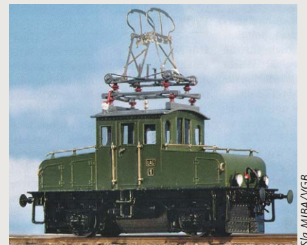
Kleinserienmodell der LAG 1 von Westmodel mit doppeltem Lyra-Bügel als technische Besonderheit
