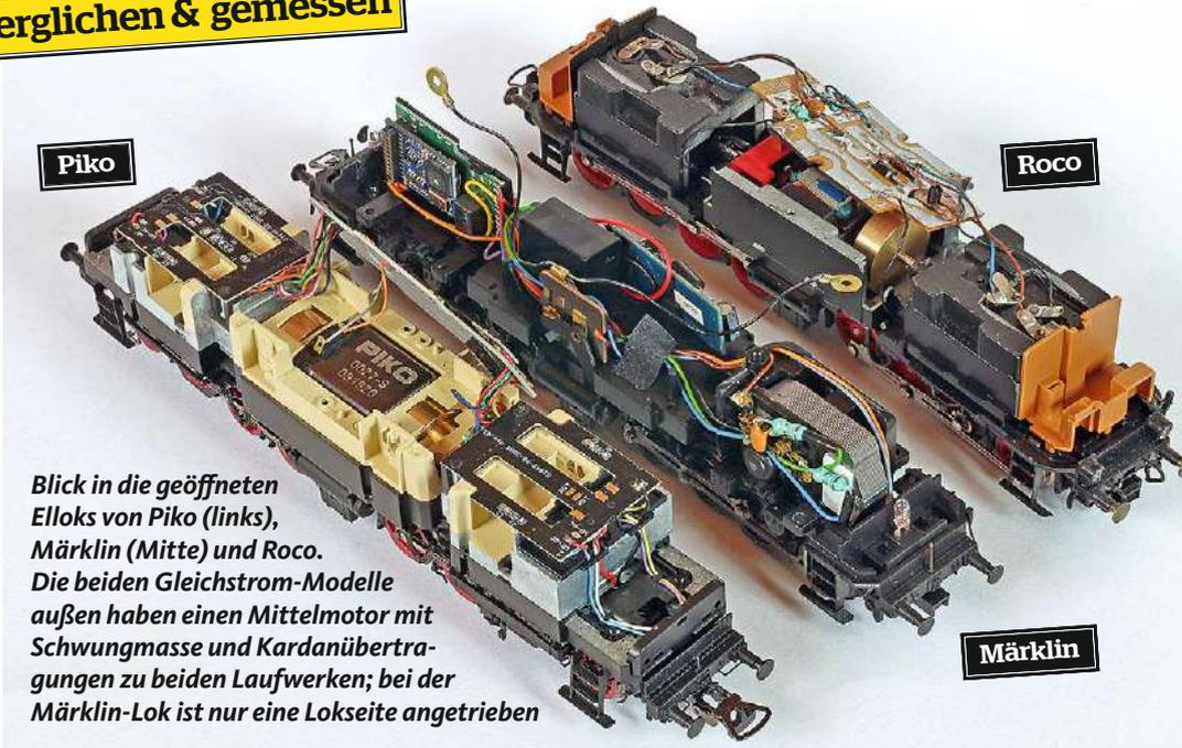
**Blick in die geöffneten Elloks von Piko (links), Märklin (Mitte) und Roco. Die beiden Gleichstrom-Modelle außen haben einen Mittelmotor mit Schwungmasse und Kardanübertragungen zu beiden Laufwerken; bei der Märklin-Lok ist nur eine Lokseite angetrieben**
