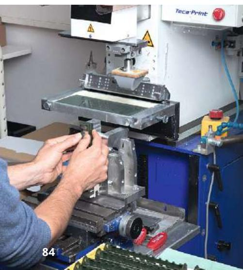
**Für die detaillierten Bedruckungen braucht es langjährige Erfahrung der Mitarbeiter. Selbst die Schlussignale werden mittels Tampondruck umgesetzt**
