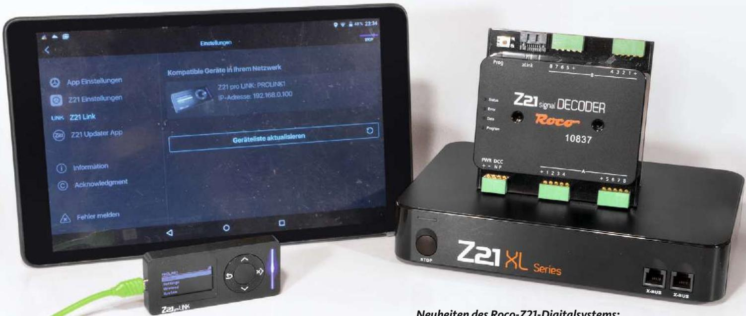
Neuheiten des Roco-Z21-Digitalsystems: Großbahn-Zentrale Z21XL und Signaldecoder (rechts), der Z21proLink sowie ein Tablet mit aufgespielter Z21-App (links)
