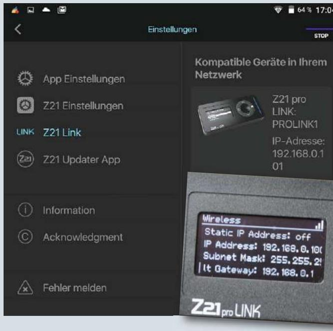
Wenn der Z21proLink das WLAN nutzt und sich über die Z21 mit der App verbindet, können die angeschlossenen Geräte damit konfiguriert werden. Ohne WLAN geht es natürlich auch, dann allerdings über den am Z21proLink eingebauten Joystick
