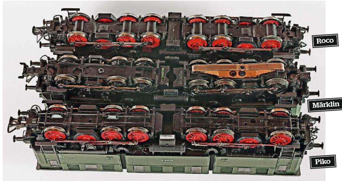
*Die Fahrgestelle zeigen in der Untersicht, dass nur Piko (vorn) das Bremsgestänge angedeutet hat. Dafür liegen beim Roco-Modell (oben) die Achszahnräder gut geschützt in Gehäusen verborgen. Bei der mittig platzierten Märklin-Ellok wirkt das Chassis recht schlicht, aber robust*
