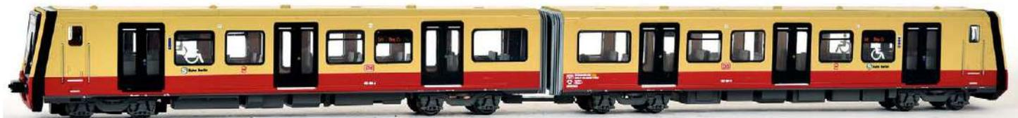
Der Zweiteiler 483 004 A und B wird nur über das vordere Drehgestell angetrieben
