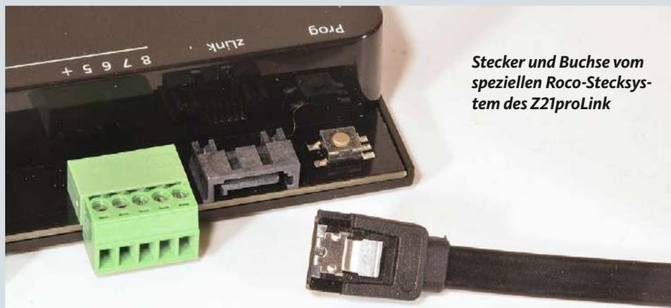
Stecker und Buchse vom speziellen Roco-Stecksystem des Z21proLink
