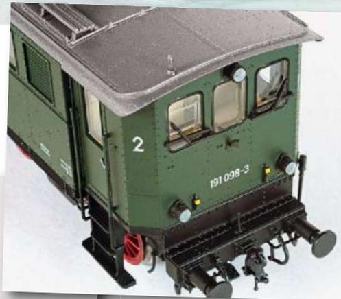
erreichen aber nicht die Feinheit der Piko-Exemplare. Sie sind hier ohne Befestigungsplatten montiert. An den Fronten sind große DRG-Stirnlampen nachgebildet, an den Frontfenstern gibt es angegedeutete Scheibenwischer.
