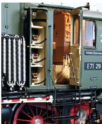
Der Führerstand und die Hochspannungs- und Schützenkammern sind hinter den beweglichen Türen detailliert ausgeführt
