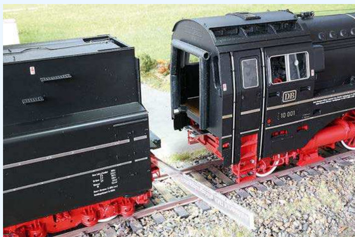
Entkopplung des Tenders mit stromführender Automatik-Steckverbindung und mitgeliefertem Plexiglas-Entkupplerstift
