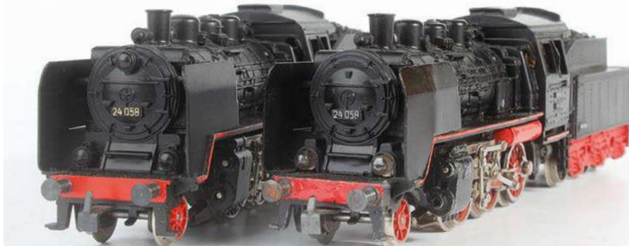
Eine der größten Veränderungen bei Märklins 24er in H0 war 1959 die Umstellung auf das ab jenem Jahr bei der Deutschen Bundesbahn verbindliche Dreilichtspitzensignal (links)
