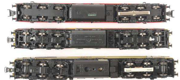
Das Antriebskonzept ist bei ESU, Mehano und Märklin (von unten) identisch, nur die Anordnung der Haftreifen ist anders. An der ESU-Class 77 ist auch der AC/DC-Umschalter zu erkennen
