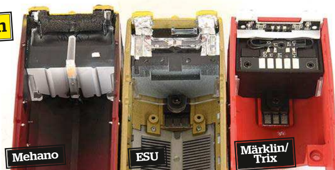
Die Beleuchtungstechnik im Bereich der Führerstände macht bei Märklin/Trix (rechts) den professionellsten Eindruck. ESU hat silberne Folie und Mehano (links) dunklen Schaumstoff mitverbaut
