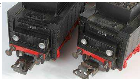
Die erste Überarbeitung von Märklins 24 058 war eher marginal: Ab 1957 verfügte der Tender über die neue RELEX-Kupplung (links)
