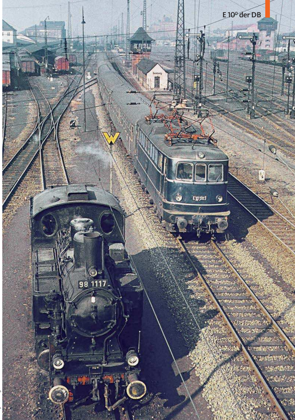
Die von Henschel und Siemens gebaute E 10 003 erhielt als einzige der fünf Vorserienloks den neu entwickelten SSW-Gummiringfederantrieb, der sich für die Konfiguration der späteren Serienloks durchsetzen konnte. Mit dem E 4012 verließ sie am 1. März 1959 Bamberg
