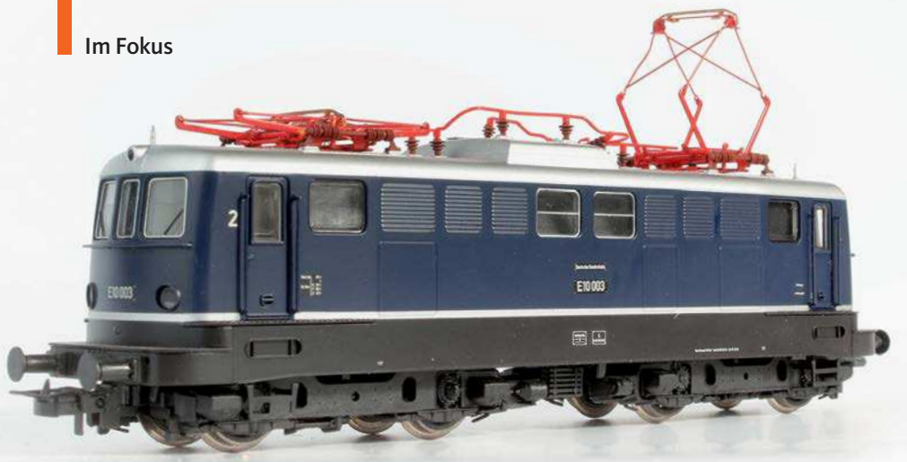
Rivarossi änderte die Lima-Formen und fertigte daraus ab 2011 drei Varianten als E 10 003/110 003; hier die Ausführung der späten Epoche III mit drittem Spitzenlicht
