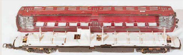
Die geöffneten ETA von Kato (o.) und Roco (u.) zeigen die unterschiedlich hohen Antriebslösungen und Inneneinrichtungen
