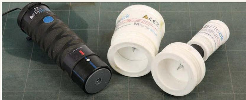
**Auf den bFlock lassen sich Behälter mit unterschiedlichen Durchmessern aufstecken**
