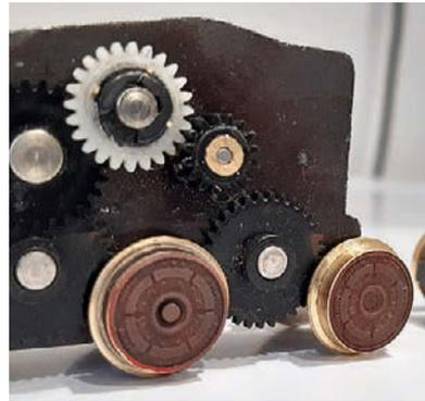
Getriebeumbau im Triebgestell mit geändertem, zweiteiligem Stufenzahnrad zum Erreichen eines höheren Loktempo
