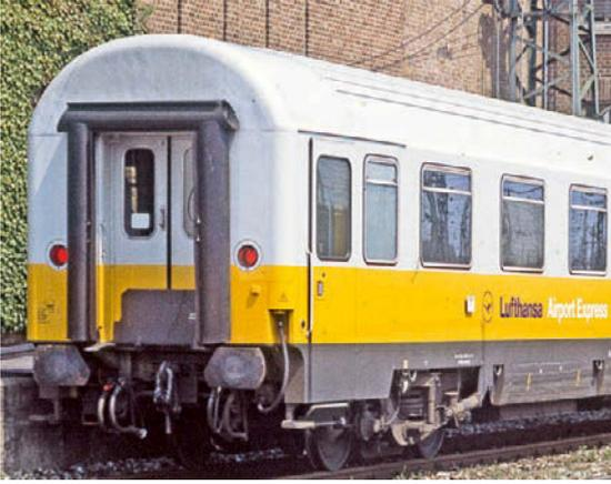
**Die Avmz207-Wagen Typ Z der Eurofima-Beschaffung zeigten bei Lieferung die normalen UIC-genormten runden Schlusslichter mit 170 mm Glas-Durchmesser (LH-Ex I in Stuttgart 1991)**
