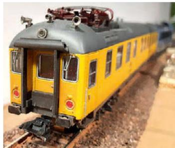
noch sämtliche Griffstangen und Türgriffe farbig abgesetzt. Für die abschließende Schutzlackierung mit mattem Klarlack mussten zwar die Fenster abgeklebt werden, aber man braucht im Gegensatz zu einer gelben Komplettlackierung keine Angst vor durchschlagendem Farnebel zu haben. Zum Abschluss wurde der Wagen leicht betriebsverschmutzt, um speziell die Drehgestelldetails hervorzuheben.
