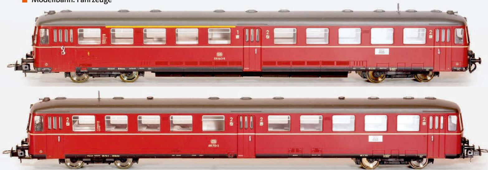
**Kato-Akkutriebwagen 515 643 und -Steuerwagen 815 713 in der Seitentotalen, die einige Detailschwächen offenbart, wie die groben Türöffner oder die fehlenden Gummidichtungen und Gardinen an den Fenstern**
