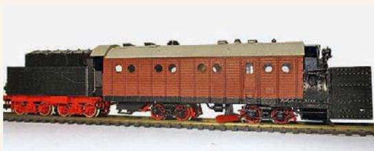
**Aus dem Günther-HO-Bausatz B311 hergerichtete Henschel-Dampfschneesleuder mit motorisch angetriebenem Schleuderrad und vorgesetzter Pufferbohle**
