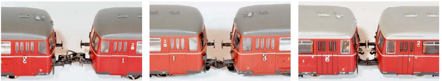
**Am Kato-Pärchen sind fest verbaute Bügelkupplungen vorhanden (l.), die einen nur großen Puffer-Abstand zulassen; als Tauschteile liegen Scharfenberg-Köpfe bei (M.). Roco (r.) hat das mit einer starren Deichsel in kinematisch gelagerten Kupplungsschächten weitaus besser gelöst**
