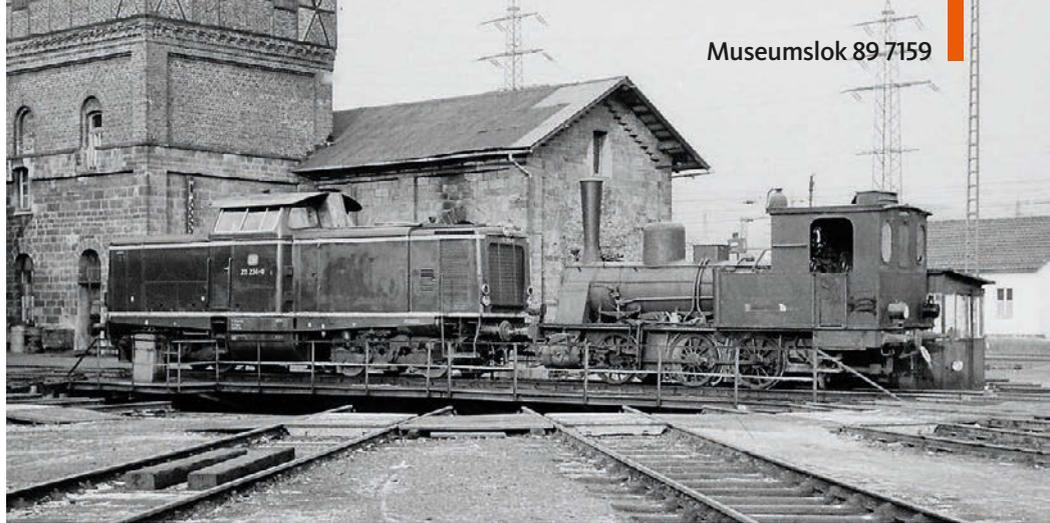
Bei der Überführung fuhr Gerhard Moll mit der T 3 und 211 234 kurzerhand auf die Drehscheibe im Bw Kreuztal, um sich ein Umsetzmaniöver zu sparen
