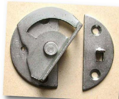
Über eine ausgeklügelte Leistenkonstruktion erfolgt die formschlüssige Verbindung der beiden Segmente; ein Exzenterverschluss sorgt für den Halt
