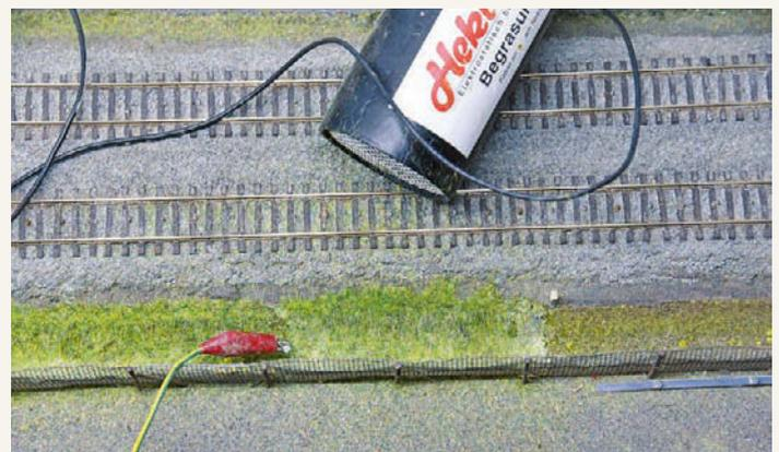
**Zur Erdung ist immer ein Gegenpol im Leim erforderlich. Alle Hersteller empfehlen einen Nagel bzw. eine Nadel, nur bei Woodland Scenics gehört eine praktische Erdungsplatte mit vier je 15 Millimeter langen Metallbeinen zum Lieferumfang**
