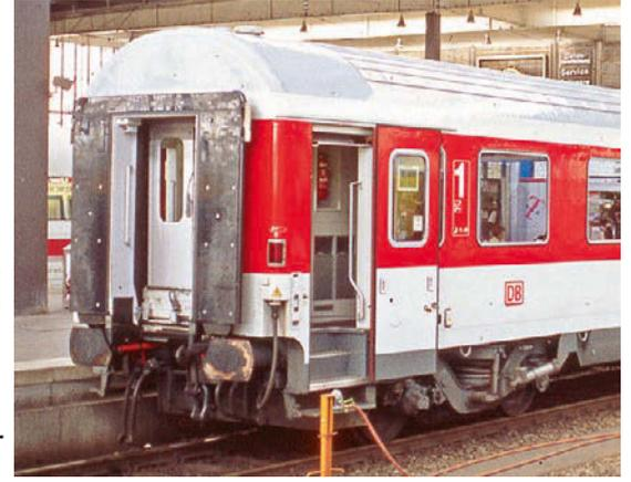
**Reflektierende Schluss tafeln sind heute auch bei Tunnel- und Nachtfahrt zugelassen, hier eingesteckt in die UIC-Aufnahmen hinten an einem Transitzug am Gotthard**
