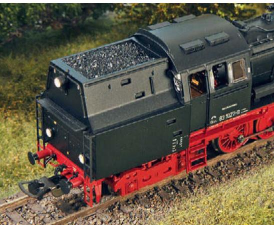
Das Licht der Loklaternen entspricht mit einem warmen Weiß dem einstigen Vorbild. Für den Nachtbetrieb besitzt die Maschine an beiden Seiten rote Schlusslichter. Im Führerstand gibt es eine Schummerbeleuchtung und Licht aus einem Feuerungstürspalt
