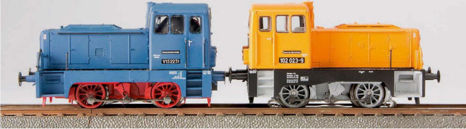
**Digitalloks im Vergleich: Soll bei der Brawa-Technik-Nachrüstung am Chassis nicht gefräst werden, bleibt der Decoder im Führerhaus leider sichtbar (links). Piko gewährleistet dagegen dank entsprechender Einbauräume den freien Durchblick – hier in der Version mit Skischleifer**
