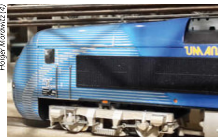
Nach dem Abziehen der Maskierfolien die große Erleichterung: Das komplizierte Streifendesign war auf Anhieb gelungen (links). Nach vorsichtigem Schleifen kamen die hellen Streifen zum Vorschein (Mitte). Die „Schwingen“ waren dann nochmals recht anspruchsvoll
