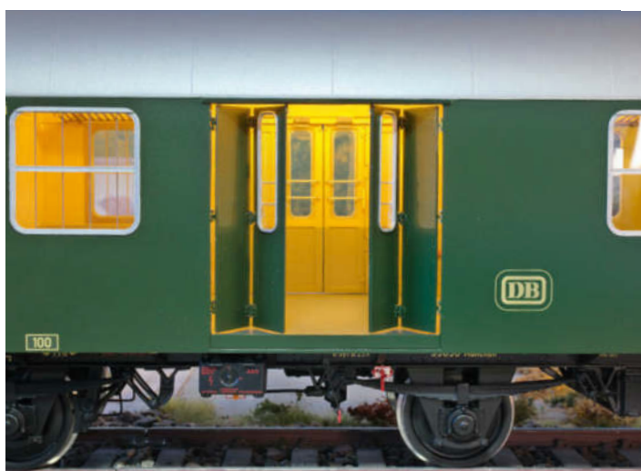
Detailansicht des BD3yg mit beweglicher, vierflügliger Drehfalttür
