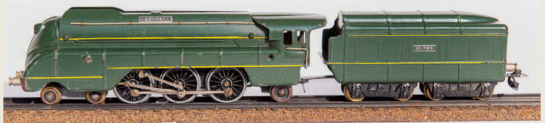
Die französische 231-761 wurde von BLZ ab 1947 in der damaligen Nenngröße OO mit Gehäusen aus Zinkdruckguss gebaut
