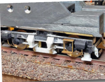
Oben links das Originaldrehgestell der „Taurus“-Ellok von Piko, oben die umgebaute Version für die UmAn-Diesellok und links eingebaut im Chassis und mit diversen vorbildgerechten Zurüstteilen versehen
