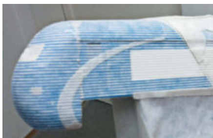
Nach dem Abziehen der Maskierfolien die große Erleichterung: Das komplizierte Streifendesign war auf Anhieb gelungen (links). Nach vorsichtigem Schleifen kamen die hellen Streifen zum Vorschein (Mitte). Die „Schwingen“ waren dann nochmals recht anspruchsvoll
