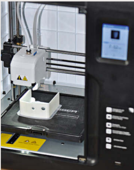
Die Arbeitsfläche lässt sich bis auf 100 Grad Celsius aufheizen, sodass als Werkstoff neben PLA auch ABS verarbeitet werden kann
