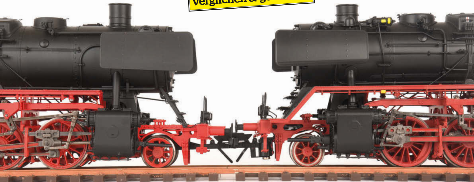
Im direkten Vergleich fallen die unterschiedlichen Pufferhöhen an der Lenz- (links) und MBW-Lok auf, wobei die digitalen Kupplungen aber auf einer Höhe sind
