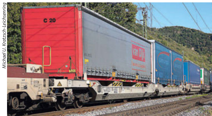
Das Betriebsfoto eines Doppelcontainertragwagen-Ganzzuges zeigt die korrekt angeordneten Stützbalken unter den Wechselbrücken
