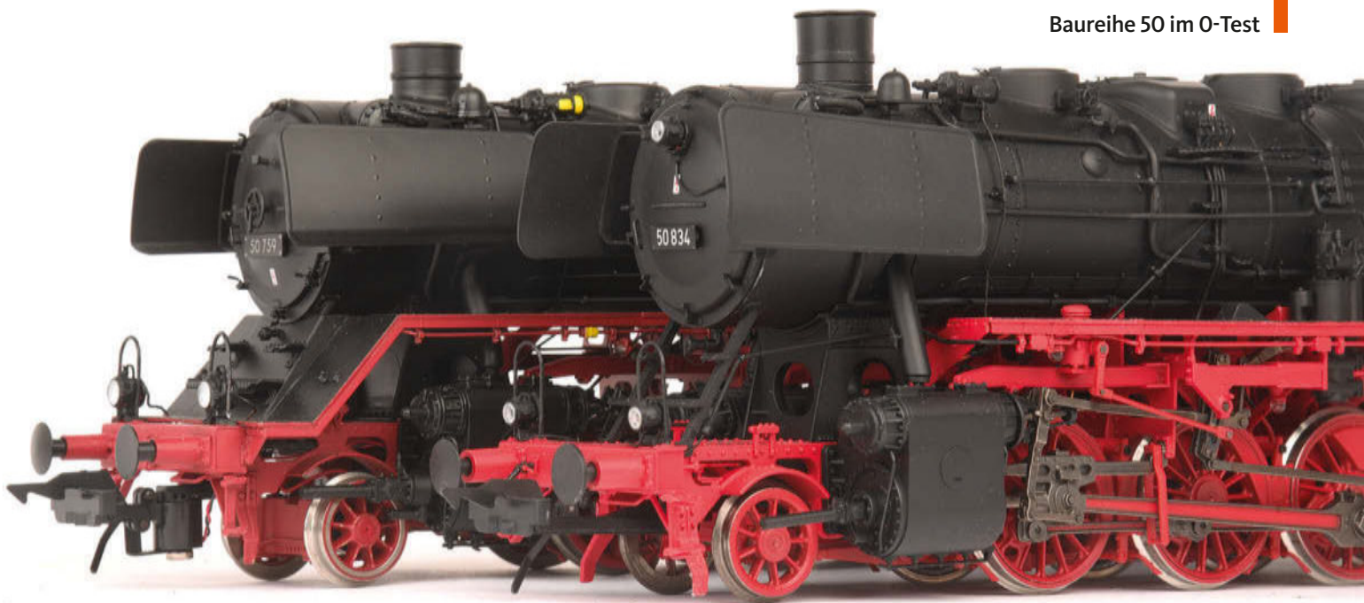
Frontansichten der DB- (Lenz) und DR-Lok (MBW) mit den jeweils typisch geformten Witte-Windleitblechen
