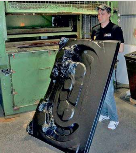
Im Noch-Werk in Wangen im Allgäu werden die Tiefziehfolien der Fertiggelände in großen Maschinen hergestellt
