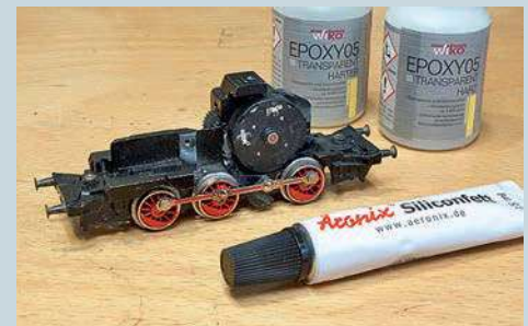
Der sb-Antrieb verleiht der alten Märklin-260 völlig neue Fahreigenschaften. Vor dem Einkleben mit 2K-Epoxy-Klebstoff sollten die Zahnräder gereinigt und gefettet werden
