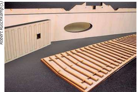
Ob Zuschnitt oder Gravur, mit der Laser-cut-Technik ist vieles möglich, sogar Schwellenroste für den Gleis- und Weichenbau
