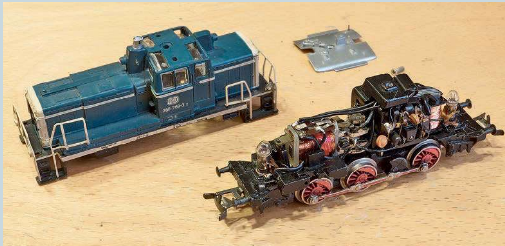
Für den Umbau zerlegte Märklin-Diesellokomotive; der alte Scheibenkollektor-Motor und der mechanische Fahrtrichtungsumschalter fallen dem Umbau zum Opfer
