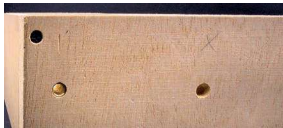
Kopfstück eines Moduls von IMT; die Hülsen und Stifte im Bild rechts unten bürgen für dauerhafte Präzision bei den in Wuppertal hergestellten Segment- oder Modul-Verbindungen
