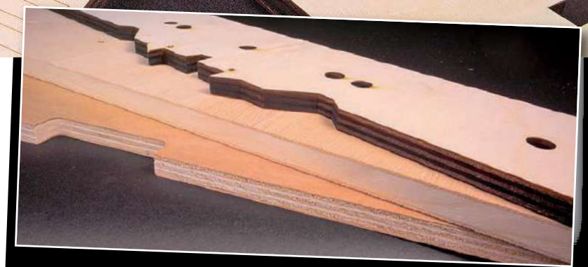
Unterschiedliche Materialien und Zuschnitt-Methoden im Vergleich: oben gelasertes Sperrholz von WilliWinsen, in der Mitte gesägte Tischlerplatte von IMT und ganz unten CNC-gefrästes Sperrholz von modellplan
