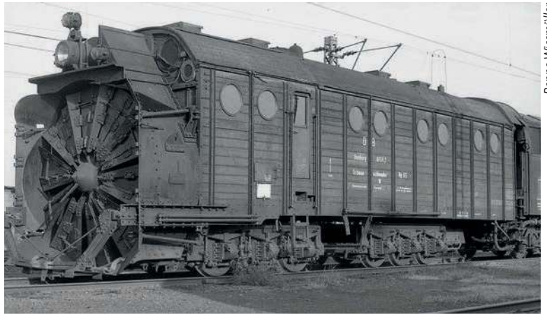
Die Henschel-Dampfschneeschilder „Hamburg 6562“ in voller technischer Schönheit; 1971 war sie in Flensburg beheimatet und eine der letzten ihrer Art im Dienstfahrzeug-Bestand der Deutschen Bundesbahn
