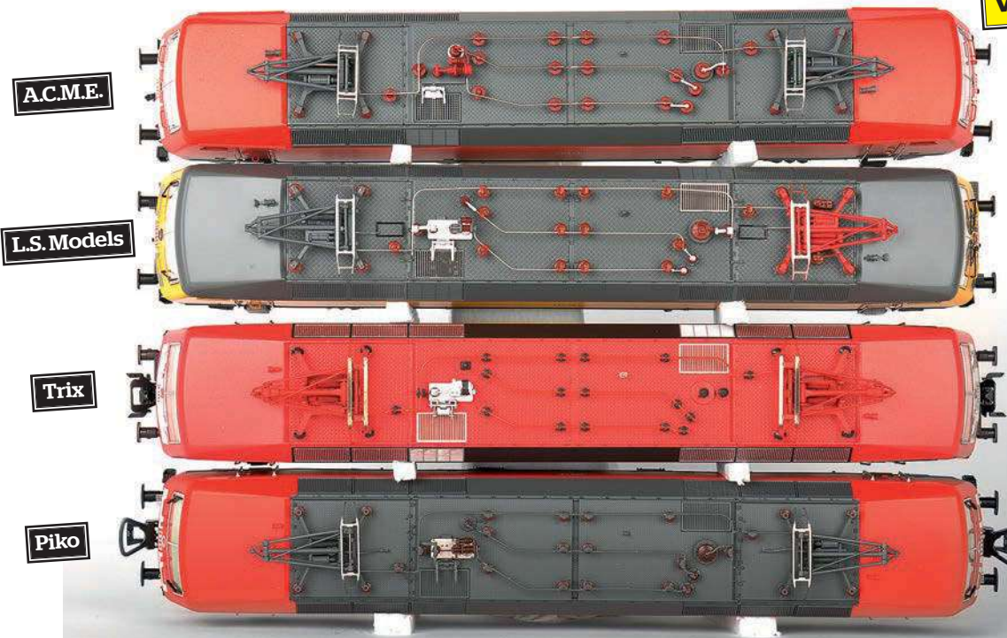
Die Dachansichten der A.C.M.E.-, L.S. Models-, Trix- und Piko-Modelle (von oben) können alle überzeugen, obwohl man auch hier unterschiedlich dimensionierte Isolatoren und feinere bzw. grobere Gitter erkennt
