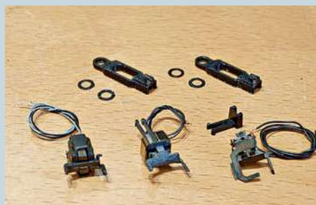
Zum Fernentkuppeln bieten die Hersteller Märklin, Roco und Krois (v. l.) für den NEM-362-Kupplungsschacht geeignete Digitalkupplungen an; Adapter gibt es als 3D-Druckteile
