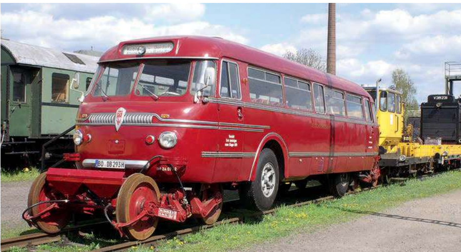
Das im Eisenbahnmuseum Bochum-Dahlhausen aufbewahrte und gut gepflegte Exemplar des NWF BS 300 zeigt die nachträglich montierten und abnehmbaren Sandkästen
