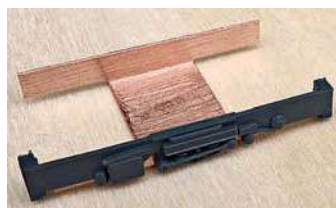
Die Halling-Drehgestellblenden wurden mittels Bronzebrücken zu einer Baugruppe vereint
