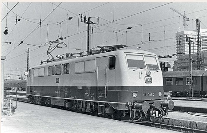
Bei Auslieferung und ersten Probefahrten Ende Juni 1975 in München trug die DB-Elektrolokomotive 111 002 Einholpantografen
