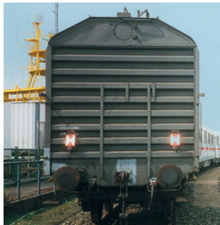
Durch den Fotoblitz rückstrahlende, im Dunkeln also gut sichtbare Zugschluss-scheiben am Ende einer Zuggarntur
