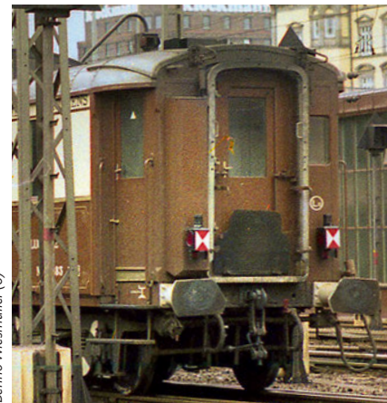
Beleuchtbare Zugschlusslaternen an der rückseitigen Stirnfront des letzten Reisezugwagens im Zugverband
