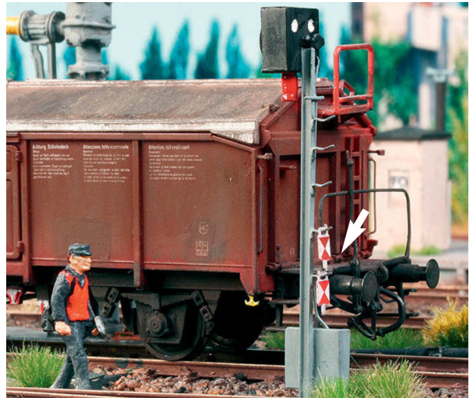
Schlusssignalscheiben müssen im Rangierbahnhof vorgehalten werden. Nicht immer gibt es geeignete Ablagen. Hier dienen dazu die Steigeisen eines am Bahnhofsgleis stehenden Gleisperrsignals
