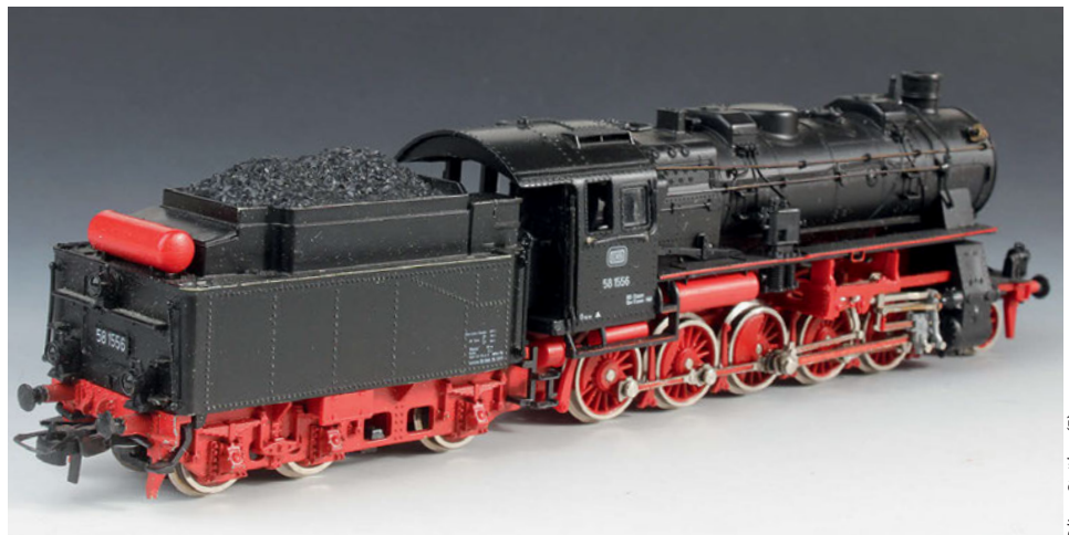
Das Dreizylinder-Triebwerk wurde gut angedeutet, mit dem Dreilichtspitzensignal schoss Roco für eine DB-58er allerdings übers Ziel hinaus (o. I.). Und auch den „DB-Keks“ haben die Vorbildloks der Baureihe 58 nie getragen. Der Antrieb war im dreiachsigen Tender platziert
