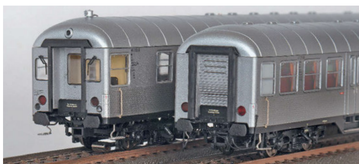
Brawa H0: Gut gestaltet sind der „Hasenkasten“ mit nachgebildetem Führerstand (links) und der geschlossene Wagenübergang mit Rollo
