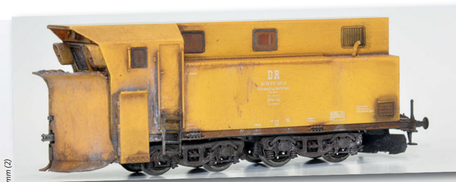
Anbauschneepflug an der Piko-HO-Diesel-lokomotive 131 001 der DR
