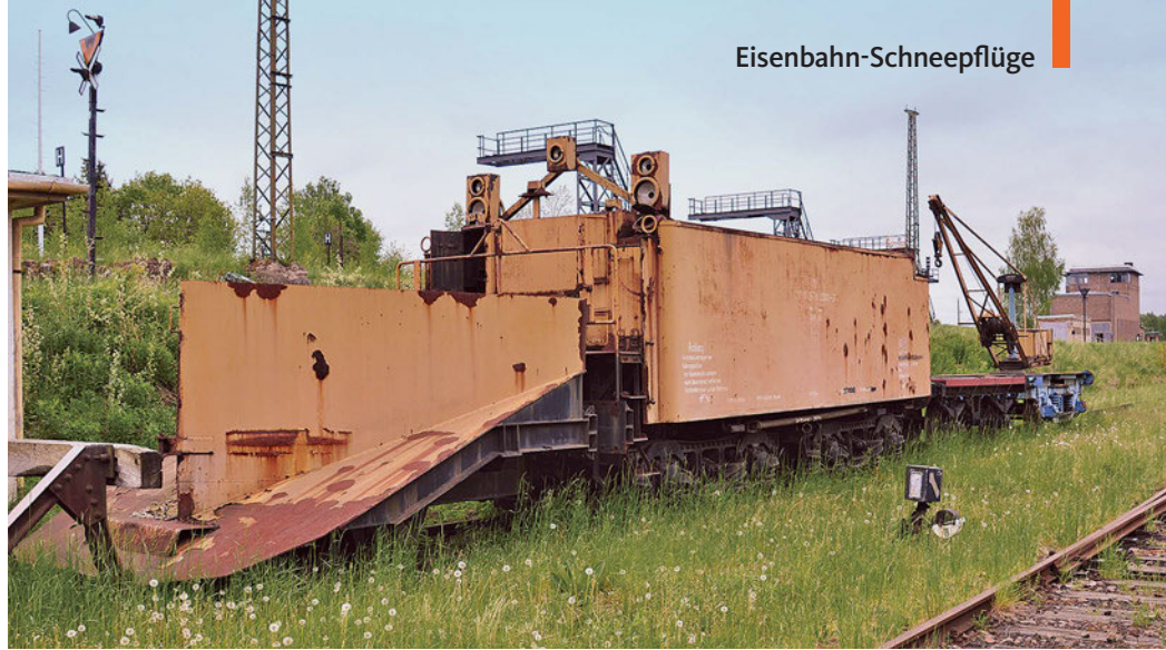
Die DR ließ eine Serie von 20 Schneepflügen der Bauart Schwedt fertigen. Die Pflugschar war dem Tender mit einer stabilen Konstruktion vorangestellt und lief auf einer zusätzlichen Achse sicher im Gleis. Im Chemnitzer Eisenbahnmuseum ist ein solches Exemplar ausgestellt
