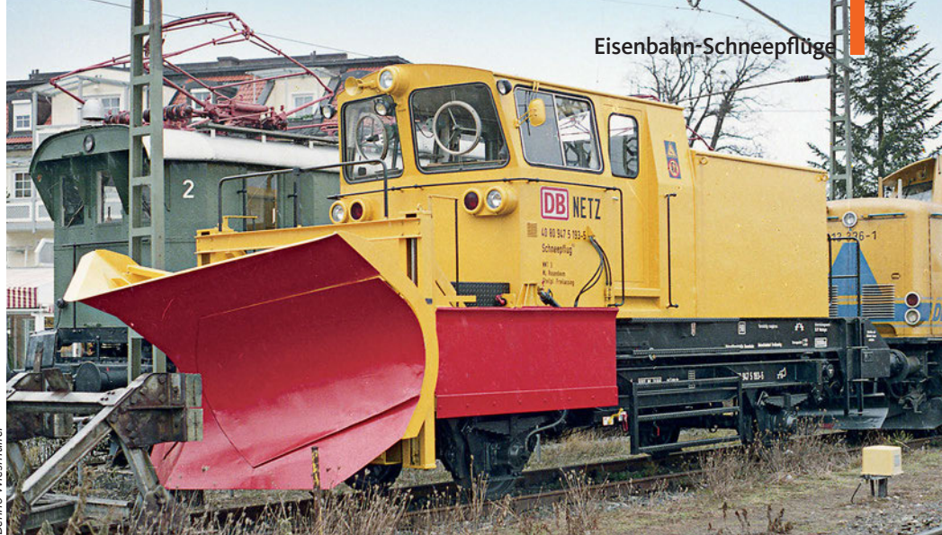
Die DB beschaffte in den frühen 1970er-Jahren 14 zweiachsige Beilhack-Schneepflüge der Bauart 851. Im Dezember 2004 stand ein inzwischen gelbes DB Netz-Fahrzeug in Freilassing
