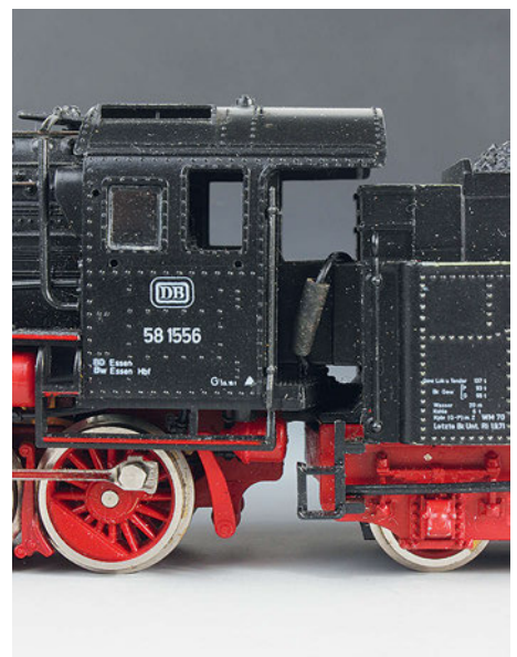
Das Dreizylinder-Triebwerk wurde gut angedeutet, mit dem Dreilichtspitzensignal schoss Roco für eine DB-58er allerdings übers Ziel hinaus (o. I.). Und auch den „DB-Keks“ haben die Vorbildloks der Baureihe 58 nie getragen. Der Antrieb war im dreiachsigen Tender platziert
