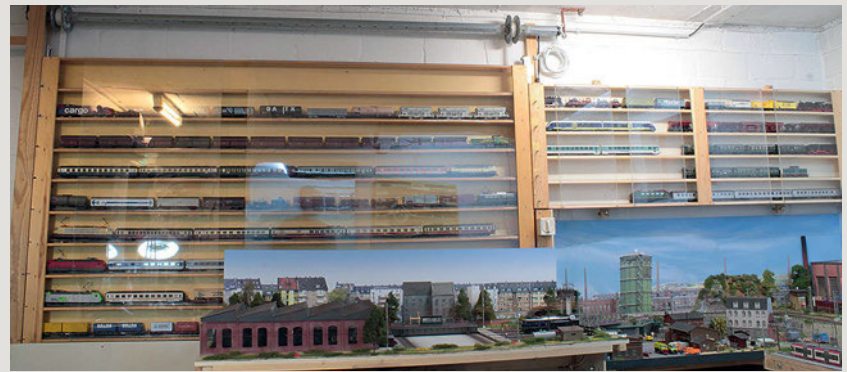
Hier die beiden Wandvitрины als Zugspeicher, von denen die linke vertikal verfahrbar ist; auf der Anlage davor zu sehen das Ellok-Bahnbetriebswerk samt Schiebebühne
