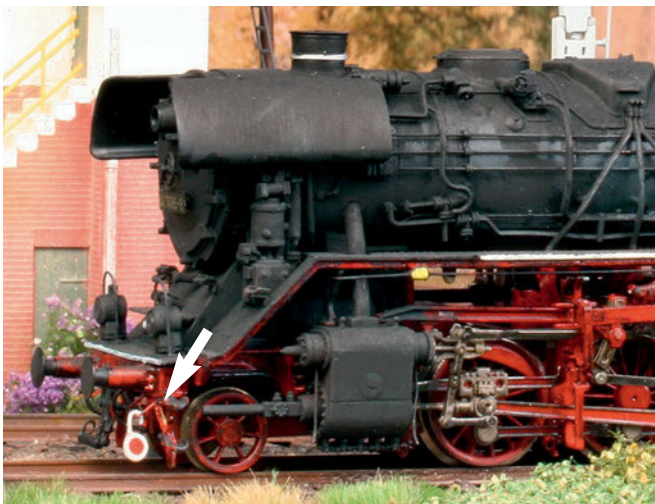
Als Lz-Fahrt ist diese rückwärts fahrende 44er-Dampflokomotive unterwegs. Tagsüber genügt das Signal Zg 4 als vereinfachte Schluss-scheibe, die unter dem Puffer am Kupplergriff eingehängt ist
