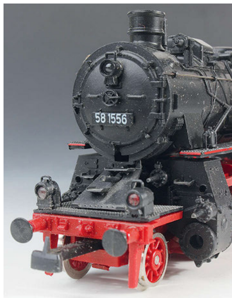
Das Dreizylinder-Triebwerk wurde gut angedeutet, mit dem Dreilichtspitzensignal schoss Roco für eine DB-58er allerdings übers Ziel hinaus (o. I.). Und auch den „DB-Keks“ haben die Vorbildloks der Baureihe 58 nie getragen. Der Antrieb war im dreiachsigen Tender platziert
