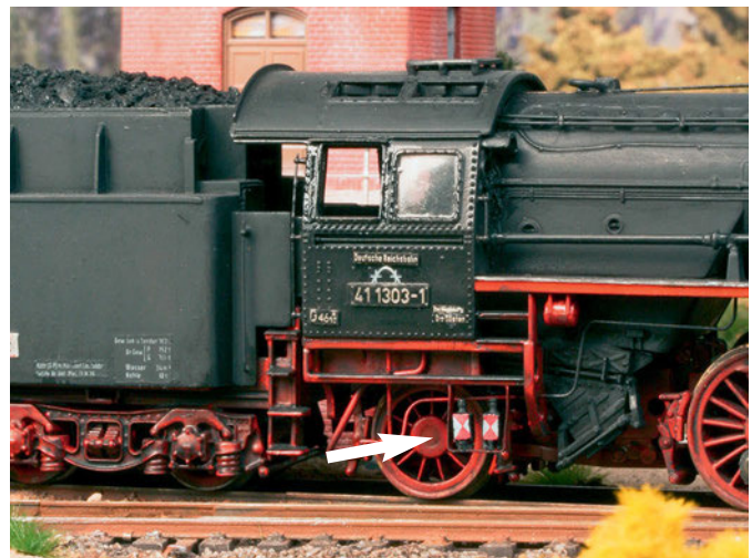
Einige Dampfloks waren unter der rechten Seitenwand des Führerhauses mit speziellen Aufnahmerahmen zur Aufbewahrung von Schlusssignallaternen versehen, hier an einer DR-41er
