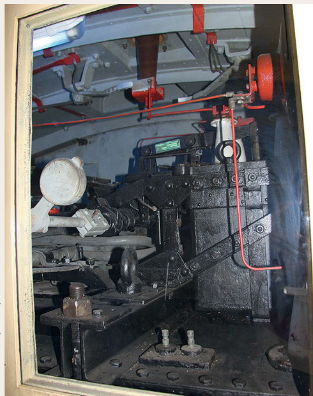
Die Hochspannungs- kammer der Dresdner E 71 30 mit dem oben zu sehenden Kleinölschalter
