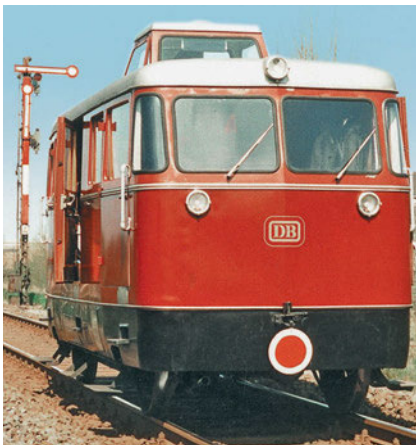
Vereinfachter Zugschluss mit simpler Blechscheibe an einem Bahndienst-Triebwagen der Deutschen Bundesbahn
