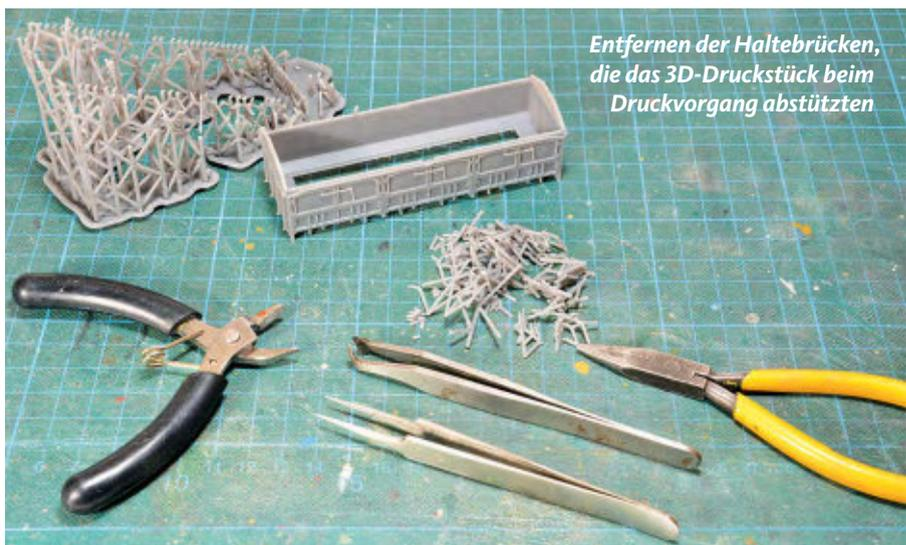
**Entfernen der Haltebrücken, die das 3D-Druckstück beim Druckvorgang abstützten**
