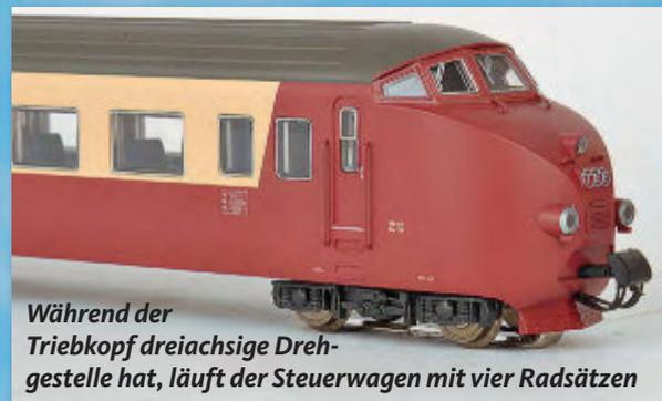
**Während der Triebkopf dreiachsige Drehgestelle hat, läuft der Steuerwagen mit vier Radsätzen**
