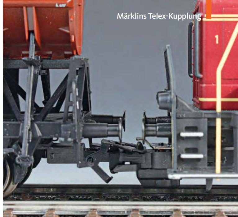
Bei den alten TELEX-Kupplungen – hier die schlankere Version – wird der Kupplungsbügel durch Auslösen des analogen Umschaltimpulses bzw. durch digitalen Tastendruck F2/3 über den Kupplungshaken der Lok gehoben und dadurch der Kupplungsbügel des angehängten Wagens gelöst
