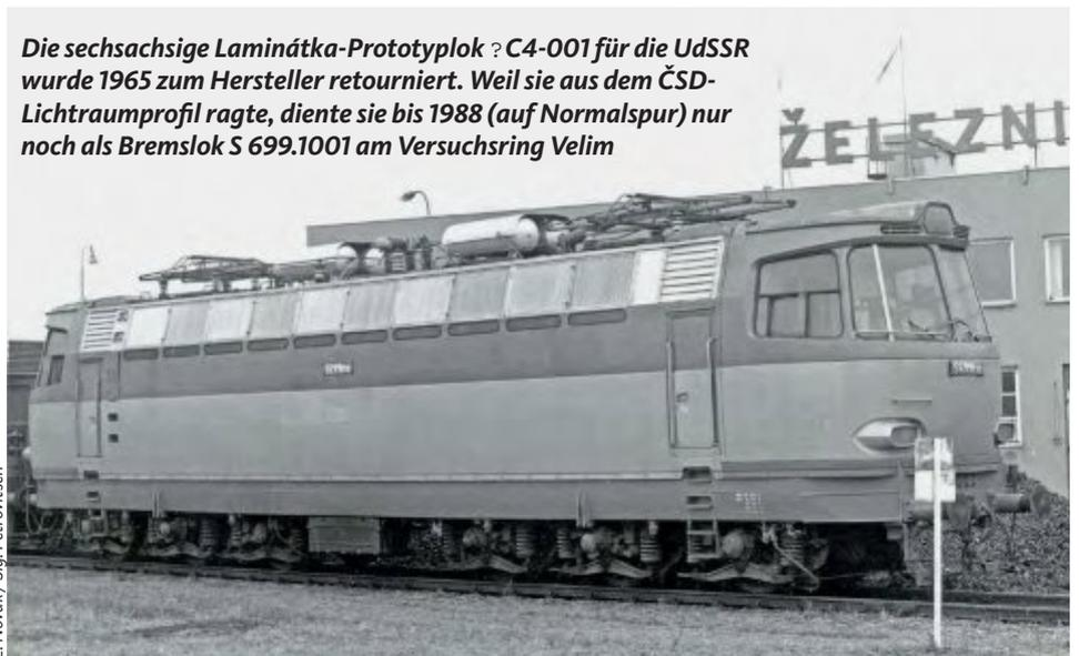
**Die sechssachsige Laminátka-Prototyplok  $\varnothing$ C4-001 für die UdSSR wurde 1965 zum Hersteller retourniert. Weil sie aus dem ČSD-Lichttraumprofil ragte, diente sie bis 1988 (auf Normalspur) nur noch als Bremslok S 699.1001 am Versuchsring Velim**
