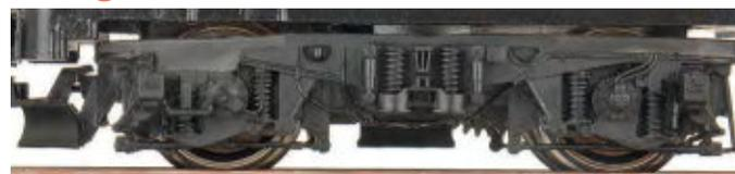
**Märklin, Piko (Mitte) und Roco (unten) haben die Drehgestellblenden mit Stoßdämpfern, Flexicoilfedern, Bremsstange, Bahnräumer und weiteren Details gut umgesetzt**
