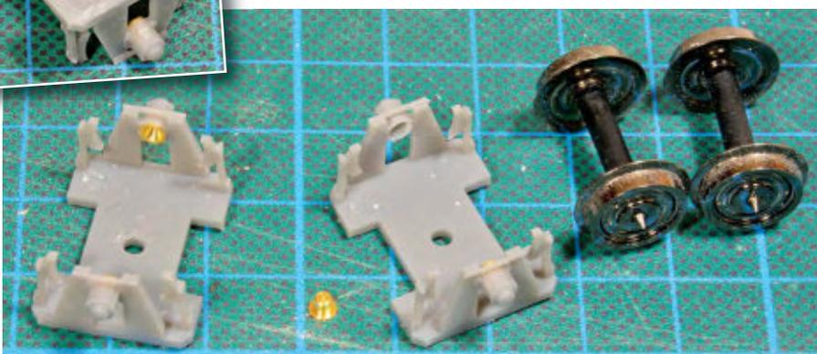
**In die Achshalter werden Messingbuchsen eingeklebt. Auf der Oberseite der Brücke wird mittig eine Rille eingebracht, wo ein 0,3-mm-Drahtstück eine Dreipunktlagerung ergibt**
