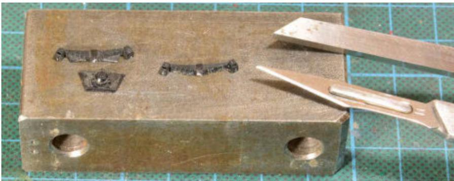
**Wird ein alter Klein-Modellbahn-Spenderwagen verwendet, muss man die Federpakete vom Achshalterblech entfernen**
