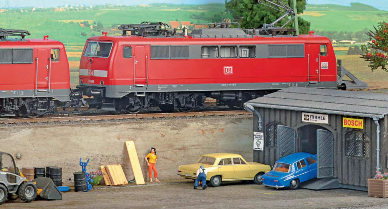
mit PluX22-Schnittstelle und Herausnehmen der Maschinenraum- und Frontbeleuchtung zugänglich. Der Platz für die Nachrüstung eines Lautsprechers ist vorbereitet. Das mit vier Rastnasen befestigte Kunststoff-Gehäuse verfügt über helle Führerstands nachbildungen und eingesteckte Kunststoff-Griffstangen. Die federnden Einholmstromabnehmer sind nicht für echten Oberleitungsbetrieb vorgesehen. Die NEM-Kuppungsaufnahme mit Kulissenführung ist am Rahmen angebaut.
