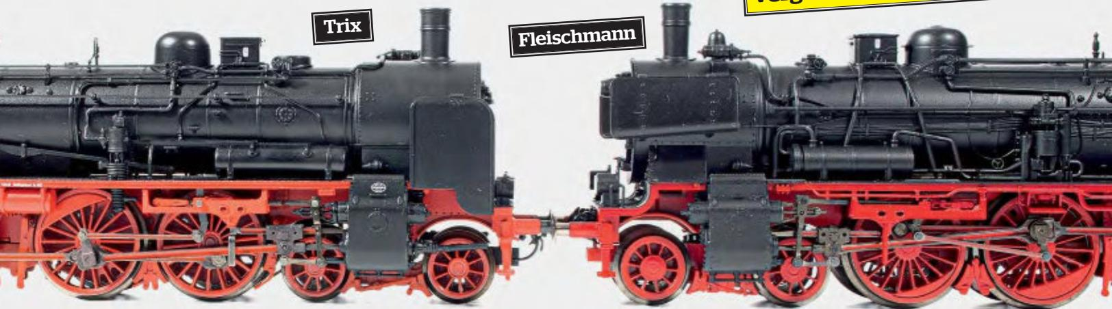
Bei Trix (links) sitzen die Puffer etwas höher als bei Fleischmann; derartige Schwankungen sind aber auch im Fahrbetrieb möglich
