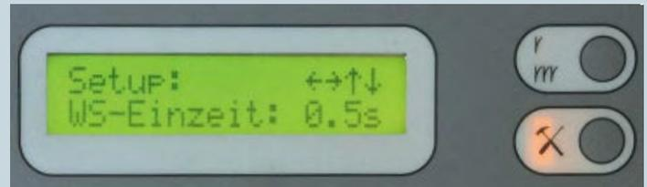
Die Konfiguration der Einschaltzeit für die Weichen ist am Dietz-Gerät intuitiv einstellbar. Leider sind die Pfeilsymbole auf den Tastern (nicht im Bild) teilweise schwer erkennbar
