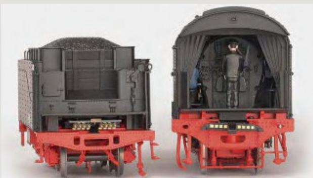
**Die Deichsel mit acht Kontakten sorgt für eine zuverlässige mechanische und elektrische Verbindung von Lok und Tender**
