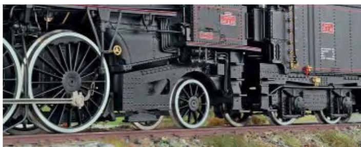
Die Rundung an den ausgeschnittenen Austausch-Rahmenteilen erlaubt es, auch kleine Radien zu befahren
