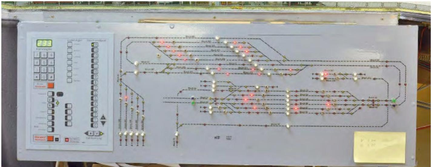
Zwei große Gleisbildstellpulte sind für den Betrieb der ober- und unterirdischen Gleisanlagen erforderlich. Die Verbindung zwischen den Pulten und dem Computer erfolgte mit Flachkabeln, die weiteren Anschlüsse über Litzen. Wenn alle Blockstellen und Fahrstraßen geschaltet sind, kann man den Zugbetrieb am Monitor verfolgen
