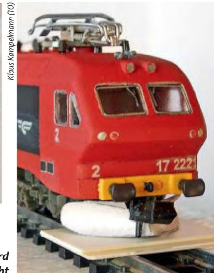
Mithilfe einer Distanzplatte zum Gleis wird der Schneepflug an das Drehgestell geklebt
