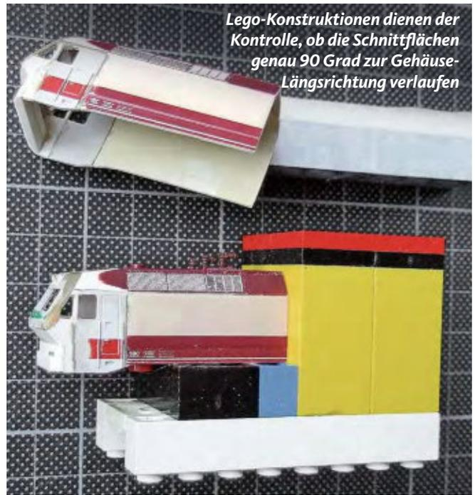
Lego-Konstruktionen dienen der Kontrolle, ob die Schnittflächen genau 90 Grad zur Gehäuse-Längsrichtung verlaufen
