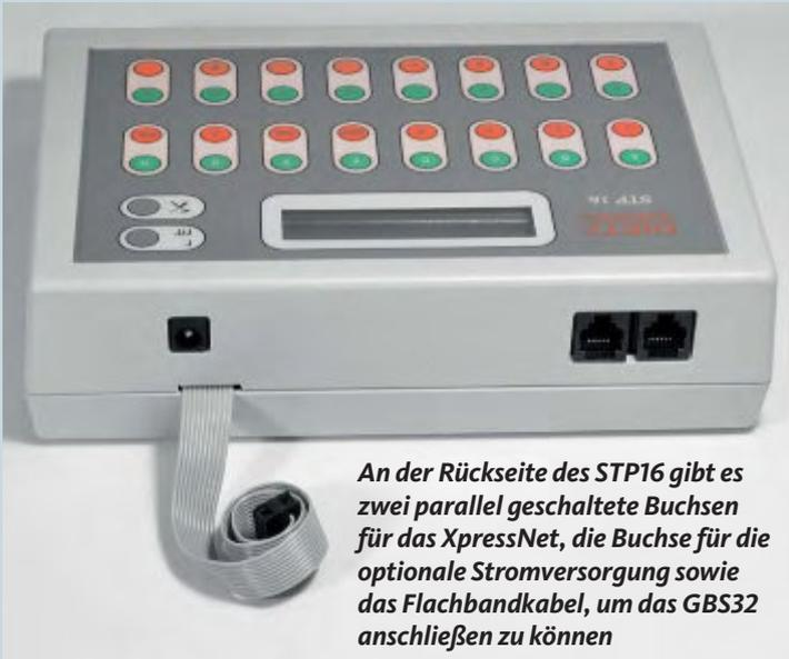
An der Rückseite des STP16 gibt es zwei parallel geschaltete Buchsen für das XpressNet, die Buchse für die optionale Stromversorgung sowie das Flachbandkabel, um das GBS32 anschließen zu können
