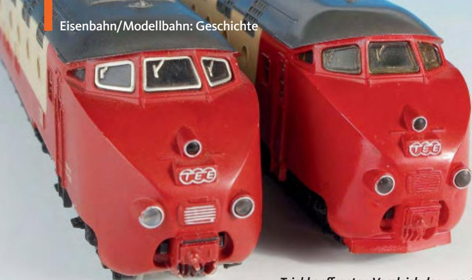
**Triebkopffronten-Vergleich der ursprünglichen RAM-Ausführung 3070 (links) und der später erschienenen vereinfachten Variante 3071**
