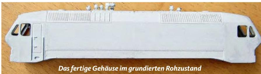
Das fertige Gehäuse im grundierten Rohzustand
