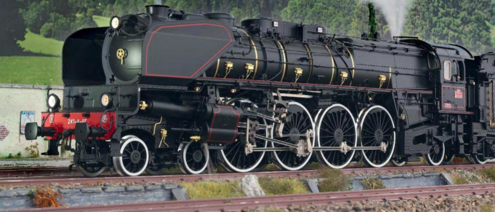
**A**ngesichts seiner vorbildgerechten Länge von 822 Millimetern ist es erstaunlich, dass das neue 1-Modell der 241-A-65 (Artikelnummer 55082/4.499,99 €) selbst Gegenweichen mit 1.020 Millimetern Radius problemlos bewältigt. Möglich wurde das durch ein paar modelltechnische Kompromisse: So mussten die beiden mittleren Treibradsätze um sechs Millimeter verschiebbar realisiert werden und die beiden anderen Treibradsätze um
