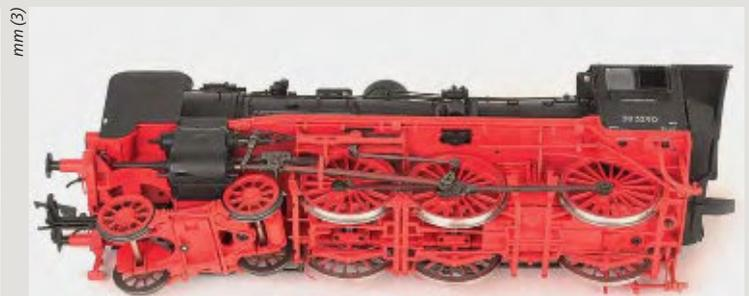
**Unteransicht der Dampflok mit nachgebildetem Bremsgestänge, Digitalkupplung und vielen weiteren Details**
