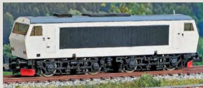
Das Fahrwerk der Roco-144<sup>s</sup> mit einem selbstgebauten Wechselgehäuse aus Karton – ähnlich der dieselelektrischen Henschel-DE 2500
