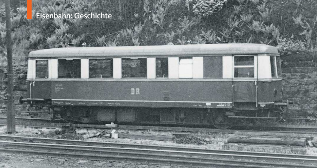
Bis 1965 wird der Personalpendel mit Triebwagen der Baureihe VT 135 gefahren. VT 135 062 stammte aus einer Lieferserie von MAN aus dem Jahr 1937 (Foto in Bad Schandau, 1964)
