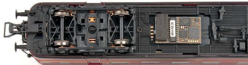
An der Bodengruppe kann der Decoder eingesteckt oder können am Analogmodell verschiedene Lichtfunktionen eingestellt werden
