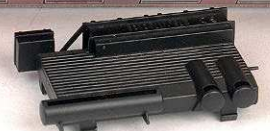
An der Bodengruppe kann der Decoder eingesteckt oder können am Analogmodell verschiedene Lichtfunktionen eingestellt werden
