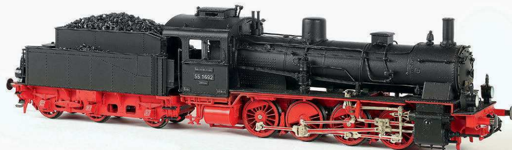
Wer eine G 8 wollte, musste den Gehäuse-Bausatz aus geätztem Messingblech, Weißmetall und Messingguss von Westmodel auf ein Fleischmann-HO-Fahrwerk setzen
