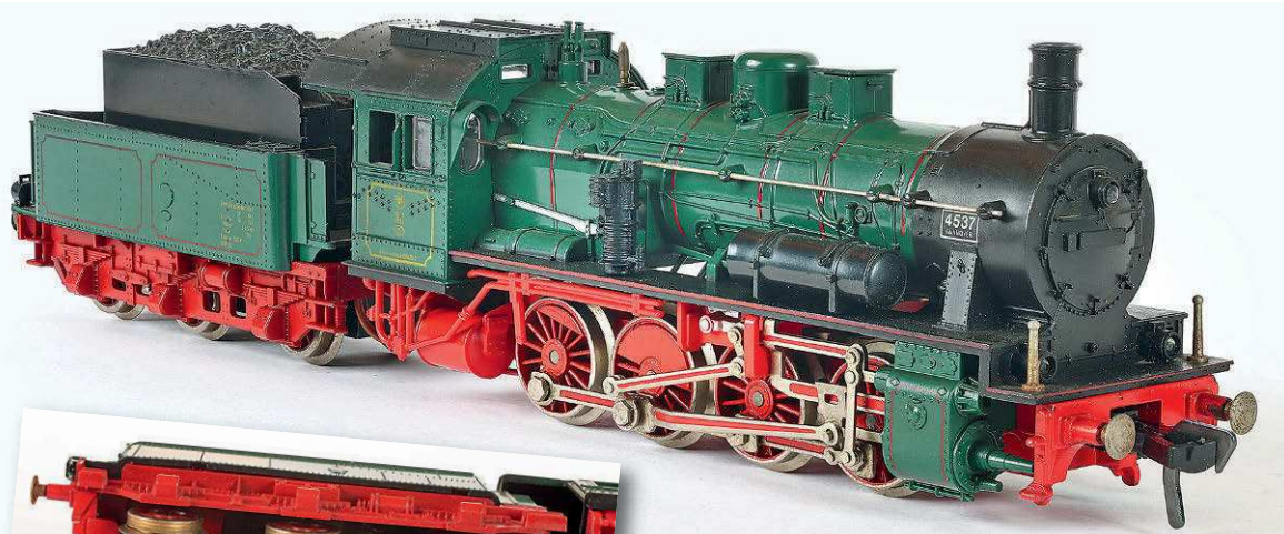
Die ab 1969 gebauten Fleischmann-HO- Modelle waren die ersten mit Tenderantrieb, hier die Länderbahn-Variante als „4537 Hannover“
