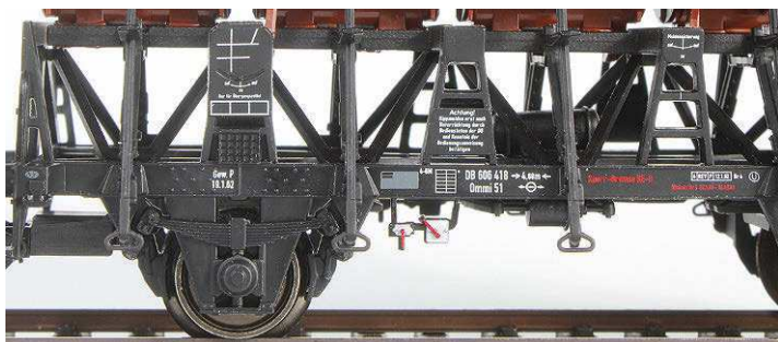
Unterschiedliche Ausführung von Achslagern und Beschriftung an den Ommi-51-HO-Modellen der Fabrikate Märklin (links) und Roco
