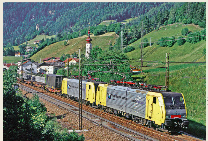
Ein Stromabnehmer pro Netz auf Mehrsystemloks führt bisweilen zu enger Bügelfolge. Dann darf z.B. bei DB Netz maximal mit Tempo 110 km/h gefahren werden (Ried bei Sterzing, Juni 2006)
