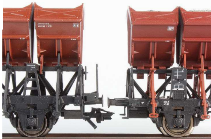
Der Vergleich der Pufferhöhen der Wagen von Märklin (links) und Roco zeigt, dass beide Fahrzeuge im Zugverband optisch nicht harmonisieren
