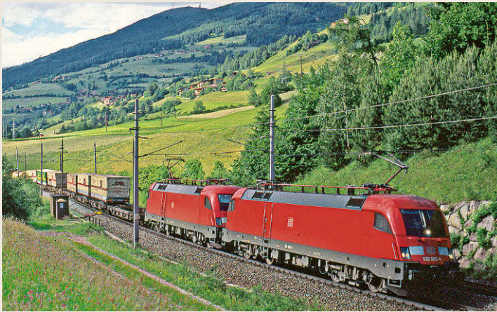
Züge des kombinierten Ladungsverkehrs (KLV) zum Brenner mit 182er-Tandem im Mai 2002: Bei unbeladenem ersten Wagen (Situation im linken Bild) fahren die Loks mit Stromabnehmer-Weitabstand; die hintere Lok hat den hinteren Bügel oben. Mit planengedecktem Wechselaufbau auf dem ersten Wagen hinter der Lok ist dagegen auch bei der zweiten Lok der vordere Bügel angehoben (Bild rechts)
