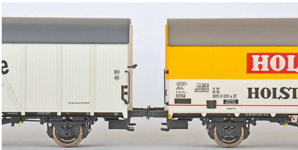
Brawa HO: Tnfhs der DR mit senkrechter Verbreiterung (links) und bei der DB eingestellter Bierwagen der Holsten-Brauerei mit Plattenwänden sowie unterschiedlichen Radlagergravuren
