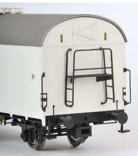
Der Ibs 394 der DB hat stirnseitige Aufstiege und Eisluken
