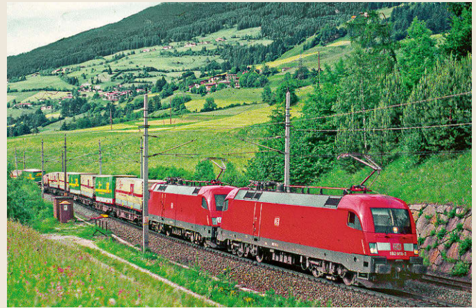
Züge des kombinierten Ladungsverkehrs (KLV) zum Brenner mit 182er-Tandem im Mai 2002: Bei unbeladenem ersten Wagen (Situation im linken Bild) fahren die Loks mit Stromabnehmer-Weitabstand; die hintere Lok hat den hinteren Bügel oben. Mit planengedecktem Wechselaufbau auf dem ersten Wagen hinter der Lok ist dagegen auch bei der zweiten Lok der vordere Bügel angehoben (Bild rechts)
