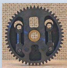
Bockholt: die gewichtige Spur-1-Nachbildung der 11801 im Ablieferungszustand hat Buchli-artige Antriebe
