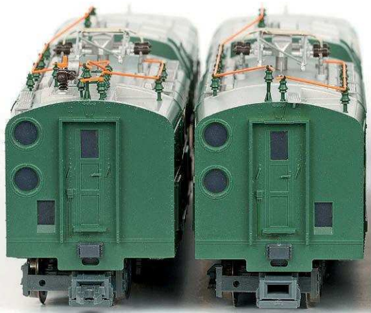
Unterschiedliche Innenstirnseiten bei der Roco 11851. Die eckigen Öffnungen unten dienten beim Vorbild der Kabelverbindung
