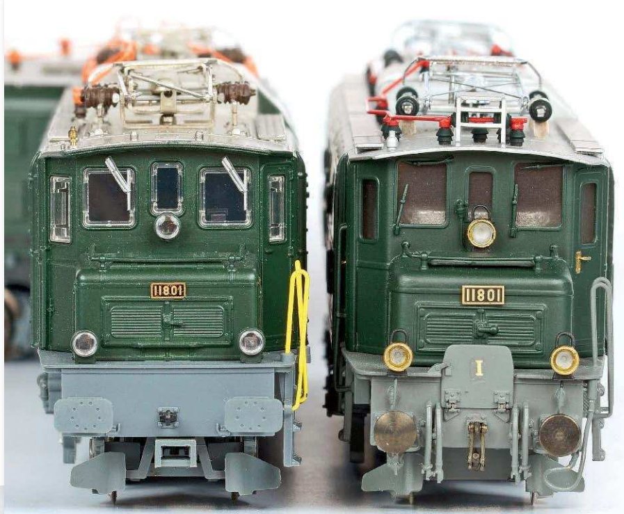
Stirnseiten im Epochewandel: links Front der HO-Museumslok (Trix) mit niedrigeren Stirnfenstern und zwei Scheibenwischern; rechts Ablieferungszustand mit vier Scheibenwischern, Übergangsblech, runden Pufferstellern, Spannungsprüfer, Laternen und E-Kabel (Fulgurex)
