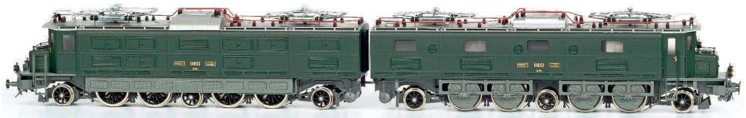
Fulgurex H0: Die ersten Ausführung der Ae 8/14 von 1931, jedoch mit unpassenden Doppelschleifstücken. Außerdem sind die innenseitigen Kastenenden der Lok nicht eingezogen. Im Fahrverhalten besticht sie durch sogar ungekuppelt recht gleichlaufende Antriebe
