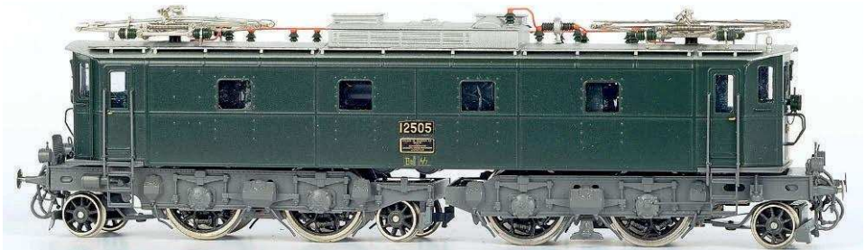
Die Be 4/7 mit Westinghouse-Antrieben und ihrem (1'Bo1')(Bo1')-Drehgestell-Fahrwerk als H0-Modell von Fulgurex
