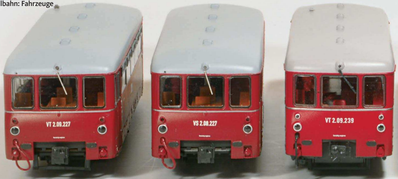
Frontansichten der drei getesteten LVT-Pärchen von Brawa (links), Piko (Mitte) und Tillig (rechts) mit den deutlich sichtbaren unterschiedlichen Lösungen für die Nachbildung der Scharfenberg-Kupplungen, Pufferplatten, Lampen, Fenster und Scheibenwischer
