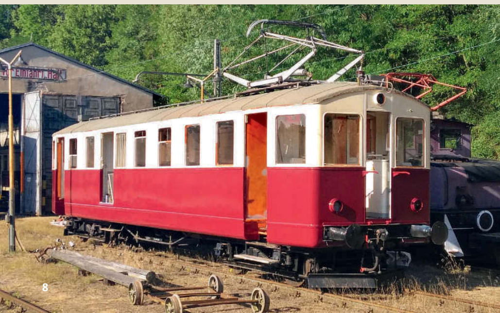
Reichsbahnflair wie in den 80er-Jahren: Die mit S-Bahn-Komponenten gebauten Trieb- und Steuerwagen (479.6, 879.6) besitzen noch heute die Original-Inneneinrichtung
