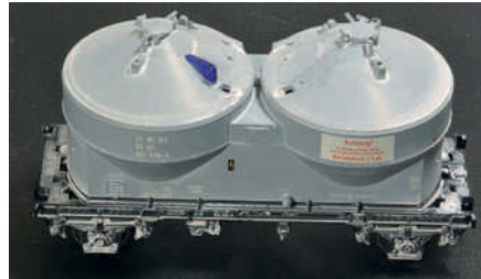
Vor dem Anbau der Teile ist an beiden Behältern das blau markierte Teil zu entfernen
