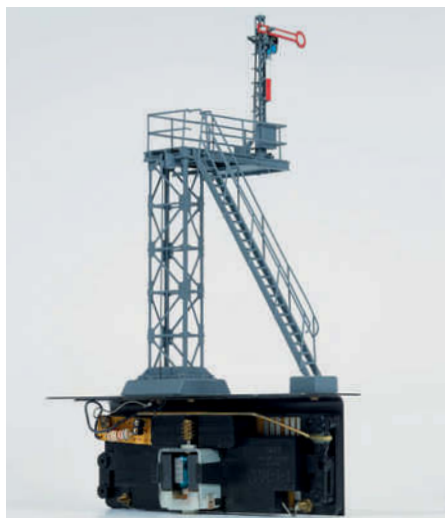
Motorischer Weinert-Antrieb an einer Signalbrücke mit einflügligem Hauptsignal
