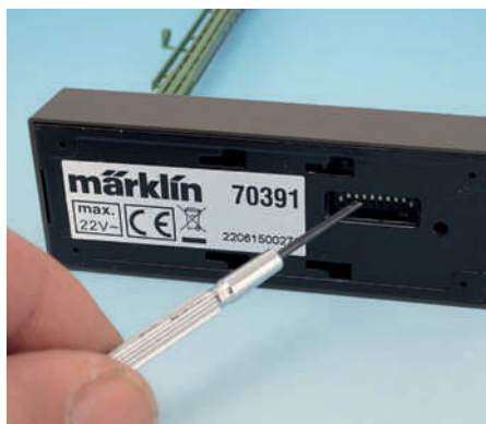
Dippschalter am Märklin-Antrieb, über den auch das Nachwippen justiert werden kann
