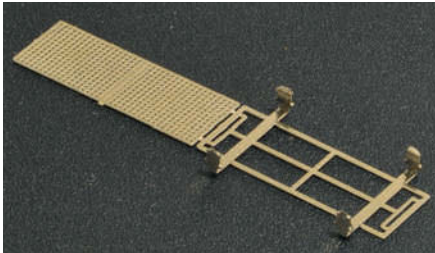
Das Bühnen-Riffelblech wird umgeklappt und verlötet, jeder der Halter abgewinkelt
