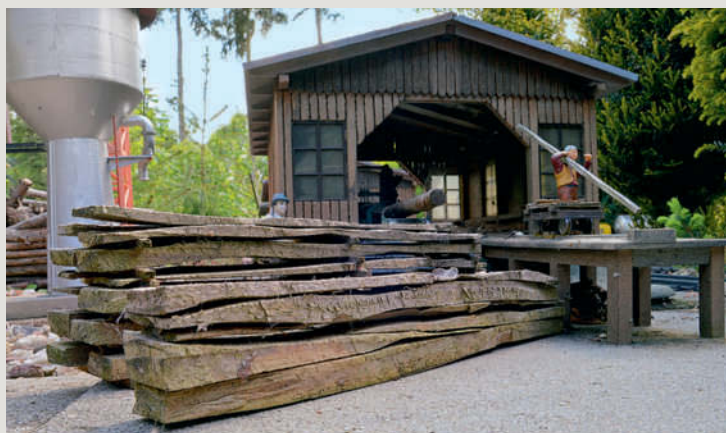
Während die Balken oben mit Holzschutz behandelt wurden, konnten die Bohlen unten dank einer haltbareren Holzart unbehandelt bleiben
