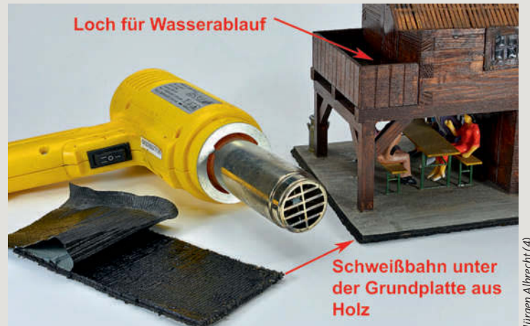
Das Holzhaus hat neben einem Schutzanstrich auch eine zweite Bodenplatte aus einer Bitumenbahn erhalten
