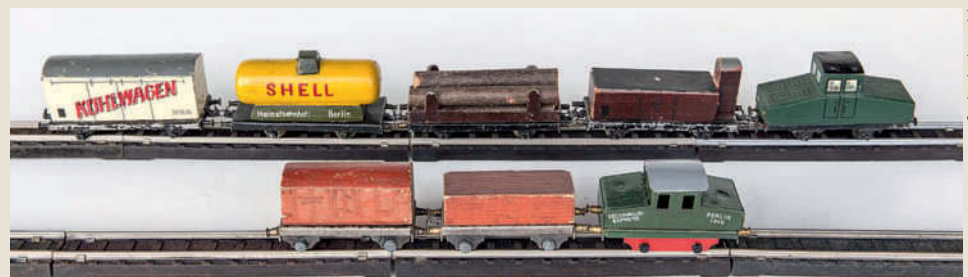
Die einer elektrischen Lokomotive nachempfundenen Triebfahrzeuge der frühen Technikus-Züge waren ohne Antrieb und mussten geschoben oder gezogen werden
