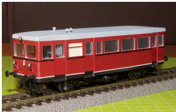
OHE-H0-Triebwagen DT 0502 auf Basis eines Trix-Fahrwerkes und eines 3D-Druck-Gehäuses von Shapeways
