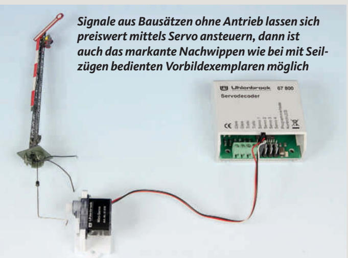
Zum Antrieb von Signalen stehen grundsätzlich motorische (unten links) oder Servo-Antriebe (rechts) zur Verfügung, ansteuerbar beispielsweise über den ESU-SwitchPilot
