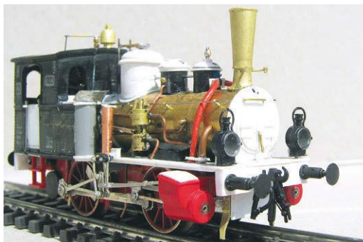
Die während der Umbauphase des Fleischmann-B-Kupplers zur badischen Ie gemachten Aufnahmen belegen, dass vom HO-Originalmodell kaum noch etwas zu erahnen ist
