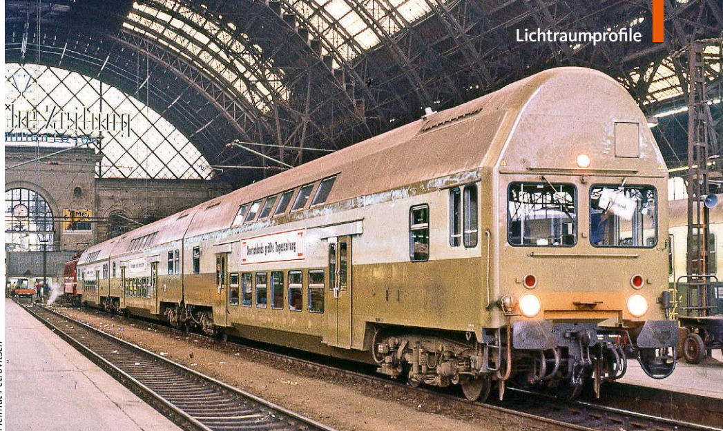
Die plane Stirnfront des DR-Dosto-Steuerwagens stellt sich als illustratives Abbild der vollen Profilausnutzung der u. a. in Deutschland, aber nicht in Frankreich, Italien, der Schweiz und Belgien zugelassenen, 4.650 mm hochreichenden Fahrzeugumgrenzung G2 dar (Dresden Hbf., März 1991)
