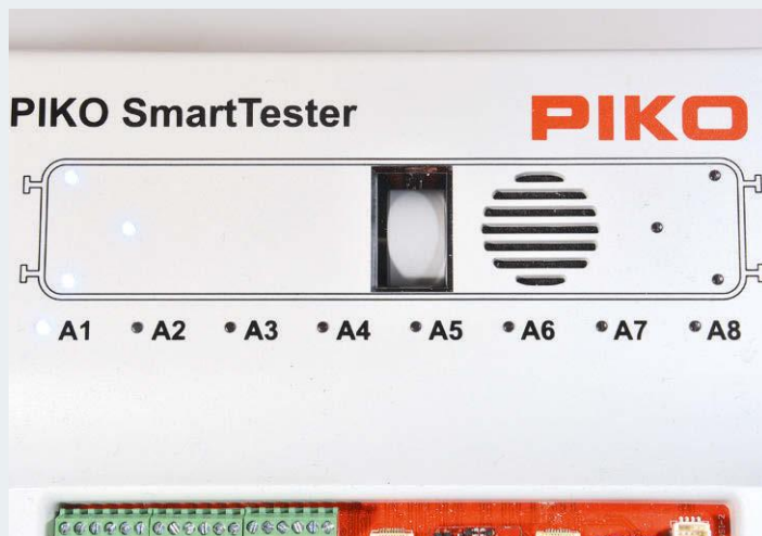
Bei Piko werden die eingeschalteten Funktionsausgänge am Smart-Tester sowie das Dreilichtspitzensignal, welches hier leuchtet, einzeln angezeigt; der Ausgang A1 steht für die roten Schlusslichter
