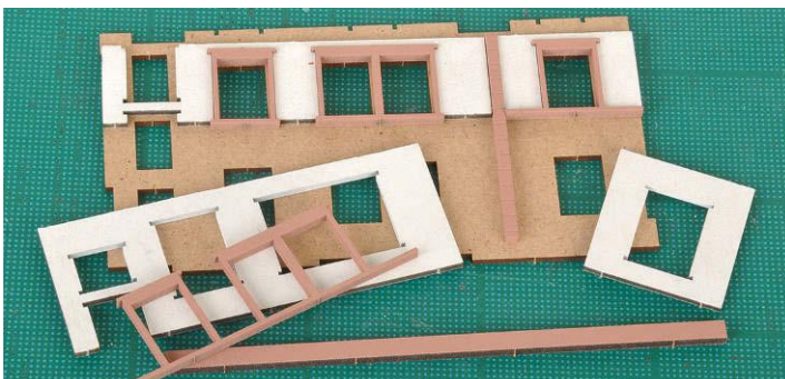
Die MDF-Platten sind mit Sandsteinpaste beschichtet
