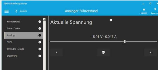
Sinnvoll ist die analoge Testmöglichkeit am Piko-Gerät, bei der man ohne Anschluss eines zusätzlichen Trafos eine analoge Modelllok mit bis zu 15,5 Volt vor dem Decodereinbau testen kann
