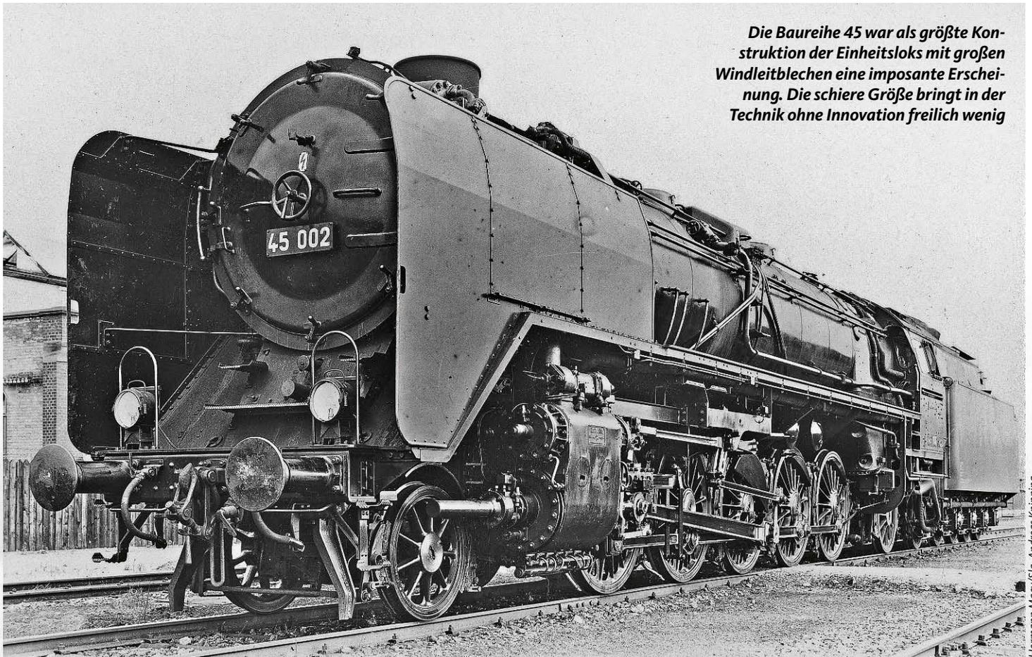
*Die Baureihe 45 war als größte Konstruktion der Einheitsloks mit großen Windleitblechen eine imposante Erscheinung. Die schiere Größe bringt in der Technik ohne Innovation freilich wenig*
