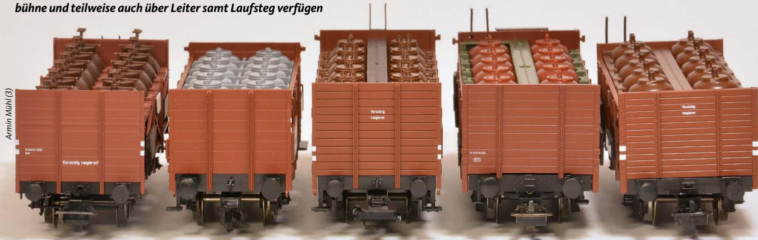
Stirnansichten der fünf Zweiachser, die bis auf das Piko-Modell mit Bremserhaus über eine Bremserbühne und teilweise auch über Leiter samt Laufsteg verfügen
