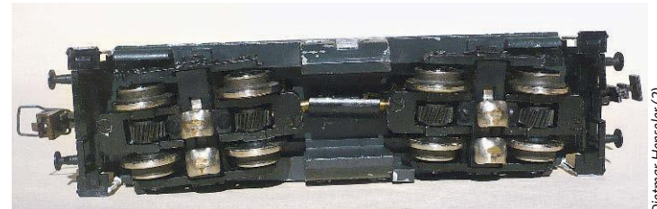
In Ozeanblau/Beige lackierte Trix-V 100 009 in Nenngröße HO mit der Kardan-Kraftübertragung zwischen den Drehgestell-Getrieben
