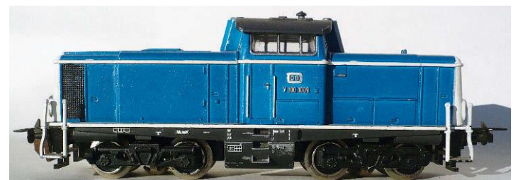
In Ozeanblau/Beige lackierte Trix-V 100 009 in Nenngröße HO mit der Kardan-Kraftübertragung zwischen den Drehgestell-Getrieben
