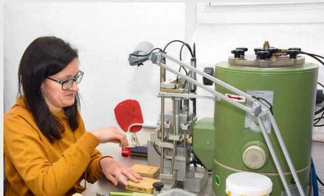
Höchstes Augenmerk erfordern die Kontrolle und das eventuell nötige Versäubern der Wachsmodelle, damit die daraus entstehenden Gussteile die geforderte Qualität erreichen
