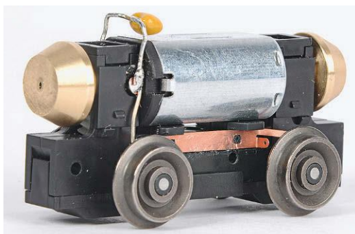
Rietze: H0-Universalantrieb mit 23 Millimeter Achsstand
