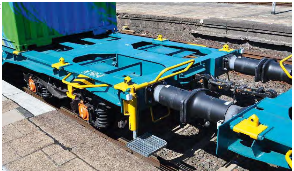
Zum Schutz gegen zu schnelle Zerstörung sind die Haltebügel für die Rangierer bei den meisten Tragwagen klappbar angebracht
