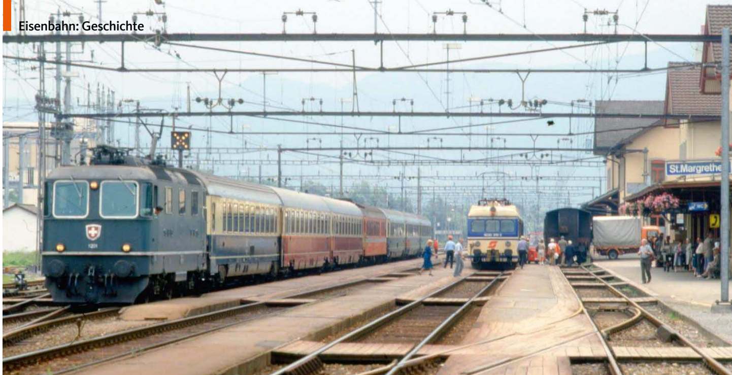
Vier Loks der SBB-Reihe Re 4/4 II (11196 bis 11201) sind für den Einsatz auch unter österreichischem und deutschem Fahrdrabt eingerichtet. Im Jahr 1987 passiert Re 4/4 II 11201 mit EC 98 den schweizerischen Grenzbahnhof St. Margrethen
