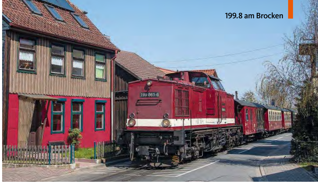
199 861 besitzt als einzige Lok dieser Baureihe noch einen Heizkessel. Am 18. April 2019 schleppt sie N 8935 durch die Kirchstraße in Wernigerode zum Brocken
