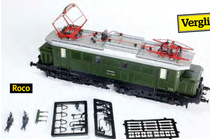
An der Roco-Ellok können zahlreiche Teile zugerüstet werden. Obendrein liegt ein geätzter Metallschildersatz zum Beschriften bei
