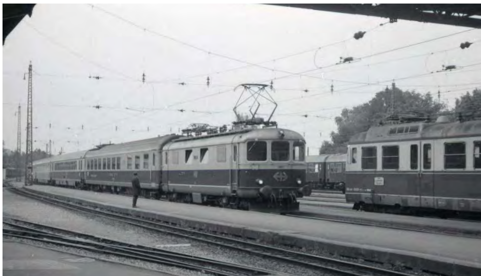
Ab und nach Lindau beförderten Re 4/4 I der SBB den „Bavaria“. Die Loks hatten hierzu einen Pantografen für den Einsatz in Österreich und Deutschland erhalten Helmut Petrovitsch (2)
