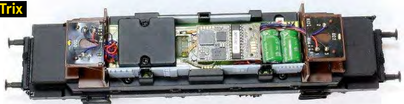
Alle drei Modelle (oben Brawa, mittig Roco, unten Trix) werden einmotorig angetrieben und sind zwischen den Drehgestellgetrieben vollgepackt mit Steuerungs- bzw. Digitalelektronik
