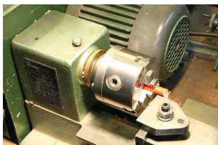
Die Regenschirm-Rohlinge entstanden aus Polystyrol-Rundprofilen auf der Drehbank
